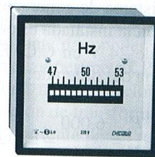
Figura 16.9. Frecuencímetro de láminas vibrantes.
