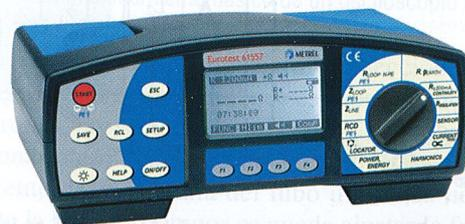
Figura 16.50. Telurómetro incorporado en el EUROTEST.
