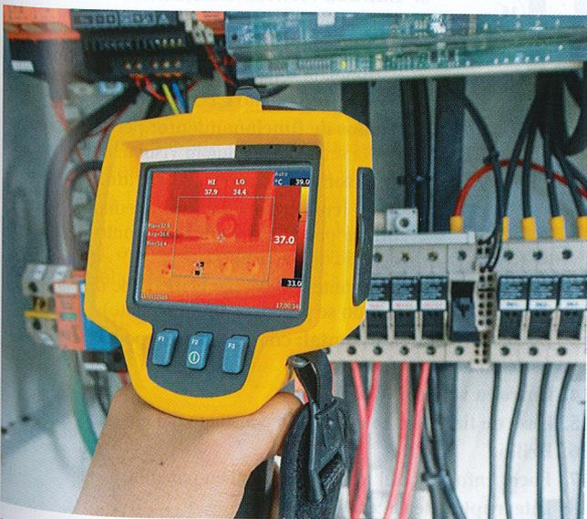
**Figura 16.53.** Cámara termográfica.
