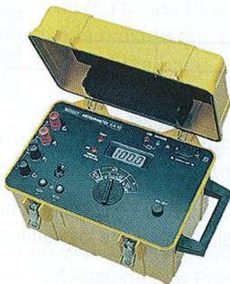
Figura 16.43. Óhmetro con puente de medida. (Cortesía de Chauvin Arnoux.)
