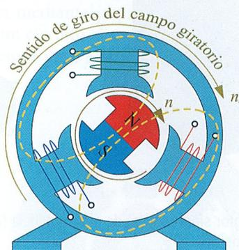
Figura 20.46. Motor síncrono trifásico.
