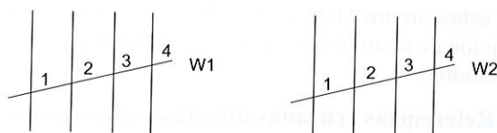
Figura 7.92. Ejemplo de referenciado de mangueras.
