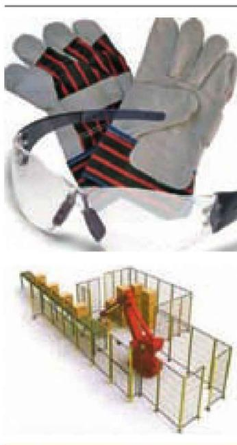
Figura 4.4. Equipo de protección individual (arriba) y colectiva (abajo).
