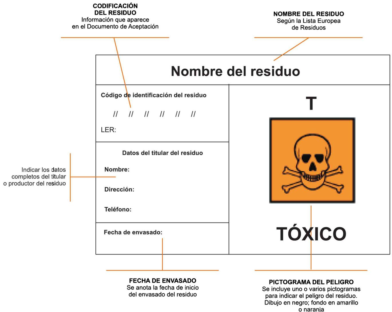
Figura 4.15. Ejemplo de etiquetado de un residuo peligroso.
