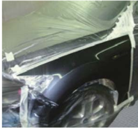
↑3.2. Irudia. Hegats baten ondoko piezak estaltzea
