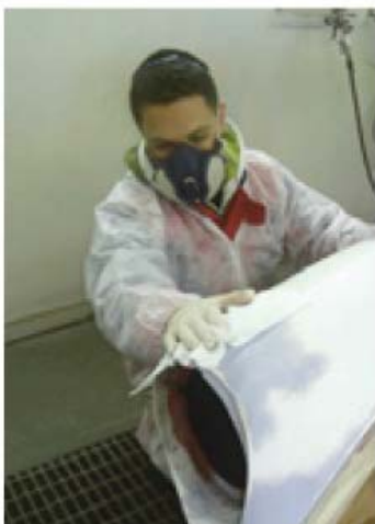
↑5.3. Irudia. Piezak garbitzen, pintatu aurretik
