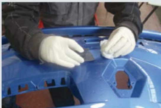
↑6.29.Irudia. P-1200 eta P-2000 ur-lixekin, lixatzea
