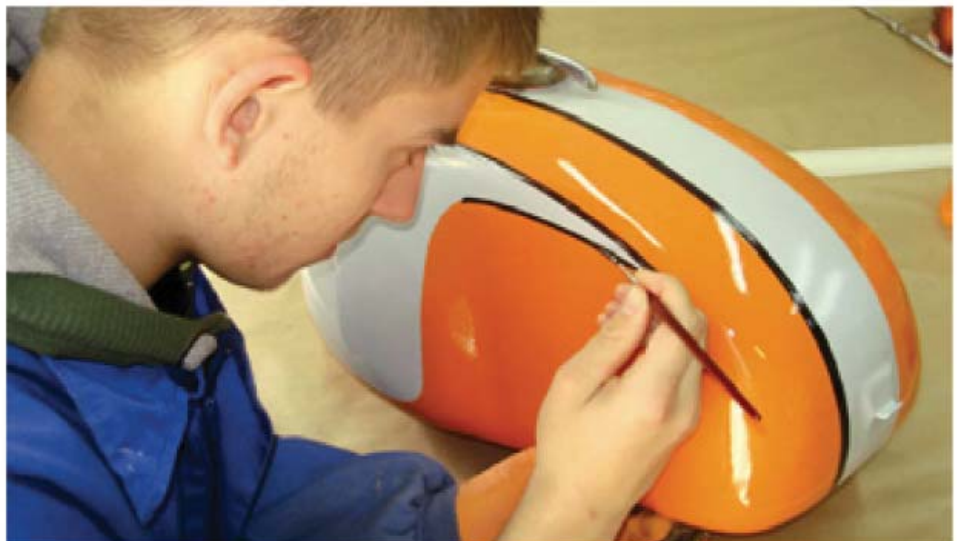
↑8.20. Irudia. Ertzak pintura beltzarekin pintatzea
