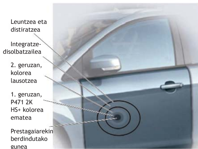
↑7.41. Irudia. Pieza zati batean, lausotze-teknika geruza bakarreko pinturarekin
