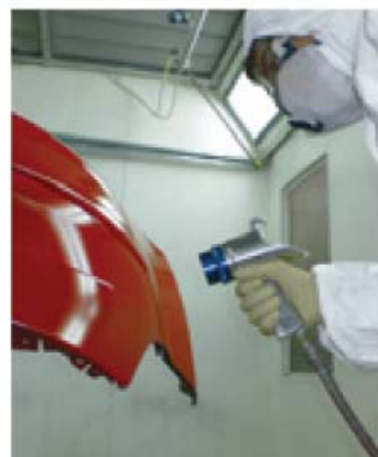
↑5.27. Irudia. Irudian, eskuko venturi lehorgailuarekin pintura lehortzen.
