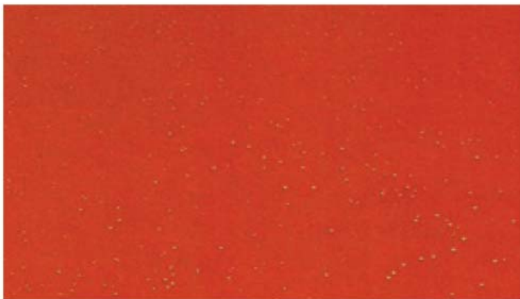
↑7.13. Irudia. Orratz-puntuak eta irakiteak (Iturria: Valentine)
