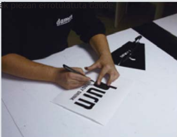
↑8.53. Irudia. Kuterrarekin, b letraren erdigunea moztu eta banatzea
