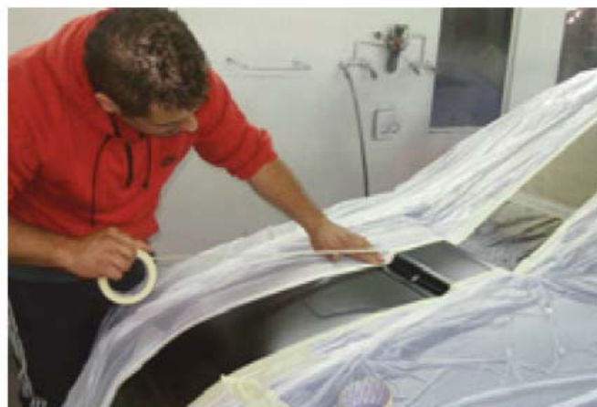
↑8.24.Irudia. Gainerako karrozeria estaltzea
