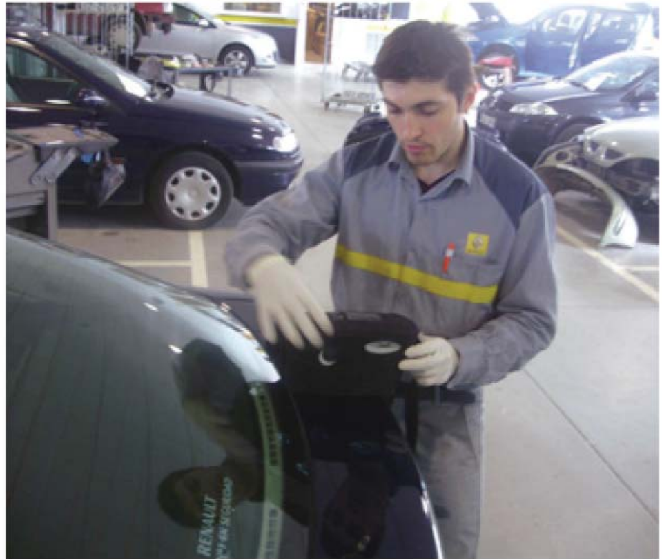
↑4.1. Irudia. Espektofotometroarekin kolore bila
