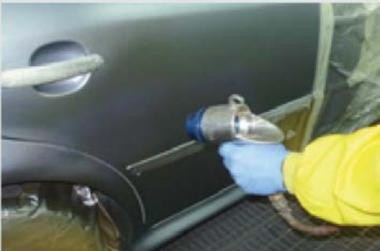
↑7.66.Irudia. Pintura lehortzea Venturi efektuaren bidez
