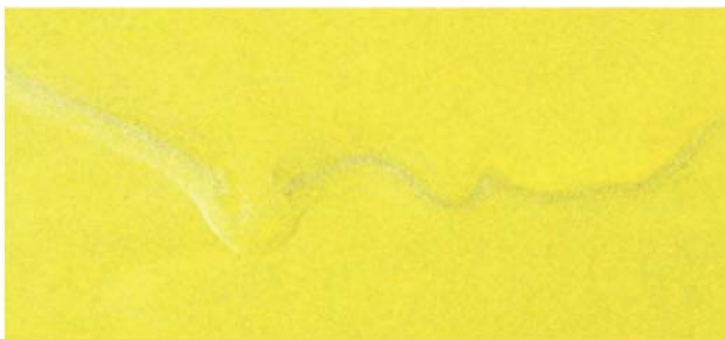
↑7.7.Irudia. Pintura metalizatuaren isuria (Iturria: Valentine)
