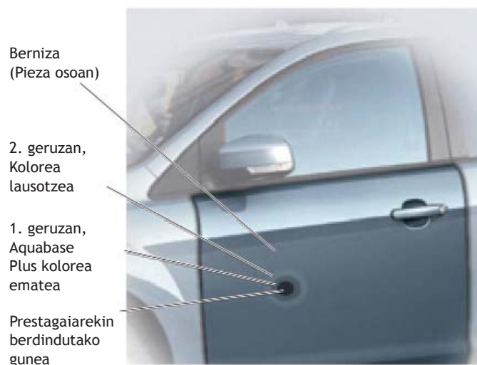
↑7.42. Irudia. Bi geruzako pinturarekin, lausotze-teknika pieza osoan (jatorria: Nexa)
