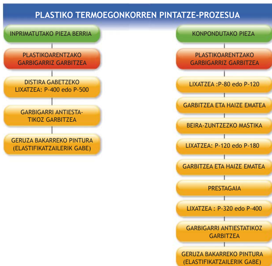
↑6.14. Irudia. Plastikoen termoeogonkorren pintatze-prozesua
