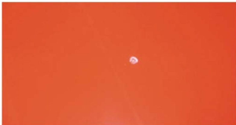
↑7.15.Irudia. Pieza batean, kraterra edo silikona-arrastoa (Iturria: Valentine)
