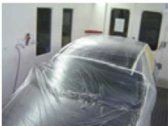
↑3.24. Irudia. Plastikofilmaz estalitako ibilgailua
