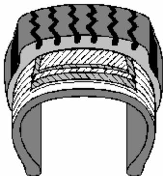
En la construcción radial, las cuerdas de las capas del cuerpo van de ceja a ceja formando semiovalos. Son ellas las que ejercen la función de soportar la carga. Sobre las capas del cuerpo, en el área de la banda de rodamiento, son montadas las capas estabilizadoras. Sus cuerdas corren en sentido diagonal y son ellas las que
