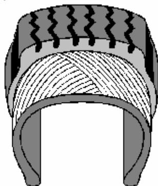
Este tipo de estructura brinda al neumático dureza y estabilidad que le permiten soportar la carga del vehículo.
