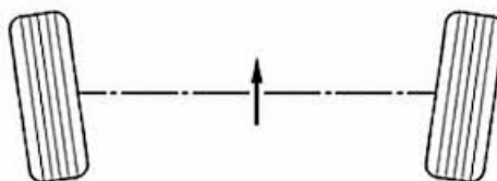
Fig. 18: Falta de paralelismo
