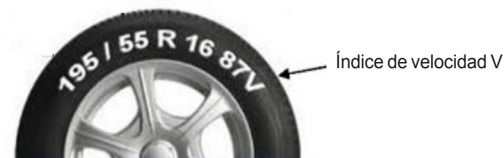
Fig. 5: Localización del índice de carga
