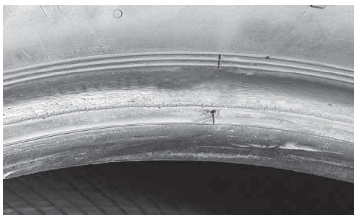
Fig. 25: Daño causado en el neumático por una pérdida de presión
