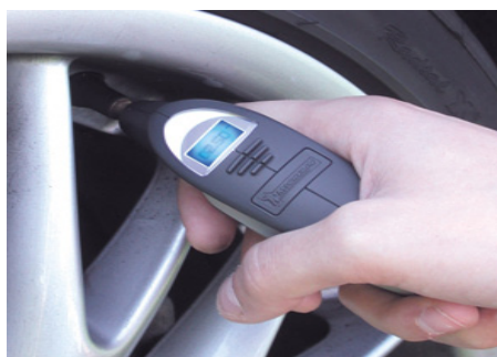
Fig. 15: Manómetro digital para controlar la presión de un neumático
