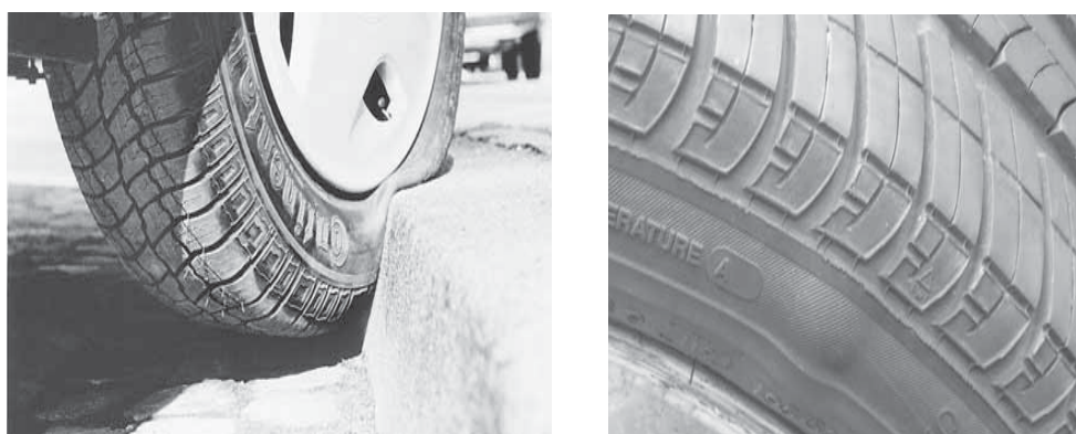
Fig. 27: A la izquierda impacto de un neumático sobre un bordillo, a la derecha deformación producida en el flanco
