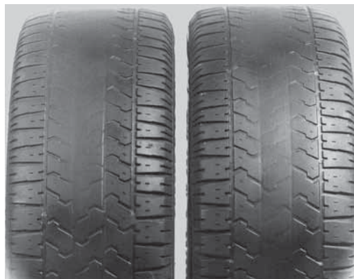
Fig. 22: Desgaste central en dos neumáticos motrices
