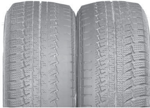
Fig. 21: Desgaste unilateral, a la izquierda o a la derecha según cada uno de los neumáticos
