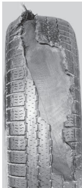
Fig. 26: Neumático con deformación y desprendimiento de goma por incorrecta presión de inflado
