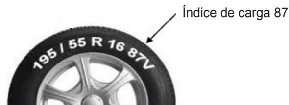
Fig. 3: Localización del índice de carga
