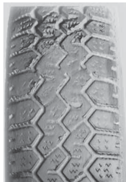
Fig. 29: Desgaste de un neumático causado por un frenado consecuencia de la activación del ABS
