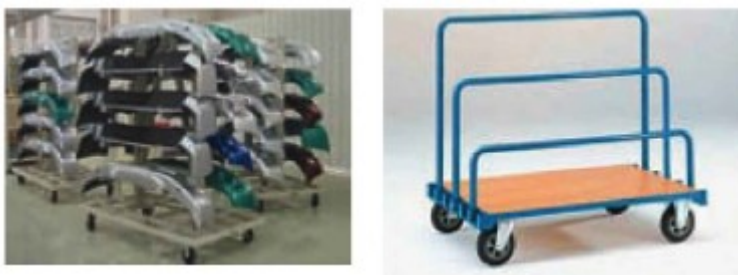
3.17. irudia. Orga garraiatzaileak (pieza, tresna, materialak, etab.).
