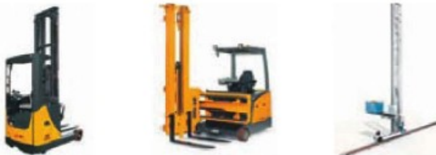
3.20. irudia. Orga jasotzaile erretraktiak, hiru aldeko orgak, garabi pilotzailea.
