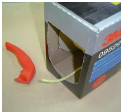
↑ 6.50 irudia. Beiretako molduretarako zumitza eta muntaia.
