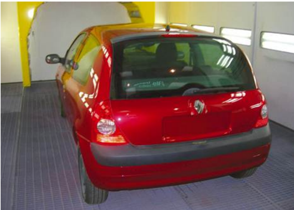
↑ 2.65 irudia. Infragorri bidezko lehortze-arku batez hornitutako pintura-kabina.
