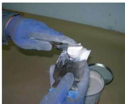
↑ 5.16 irudia. Mastikaren nahaste desegokia, zirkuluak eginez. Mastikaren nahaste egokia, hura moztuz, homogeneizatzen den arte.
