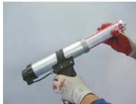
↑ 7.31 irudia. Zigilatzaile-tutu bat pistola pneumatiko batean muntatzea.
