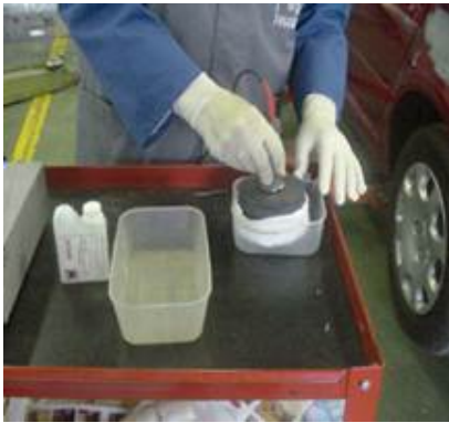
↑ 4.18 irudia. Anodoa zink-disoluzioan hezetzea.
