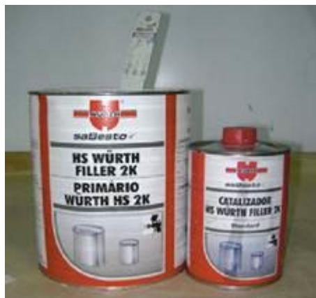
↑ 6.26 irudia. 2K HS prestagai baten eta katalizatzailearen formulazioa.
