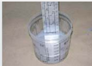
↑ 4.44 irudia. Produktua proportzio-erregelarekin katalizatzea.
