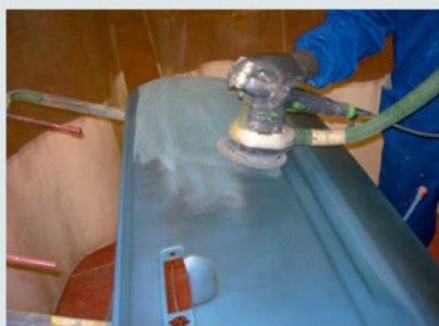
↑ 6.60 irudia. Gainazala lixagailu birakari-orbitalarekin lixatzea.
