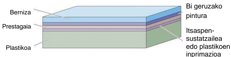
↑ 4.30 irudia. Pintura-geruzak plastiko bat pintatzeko.
