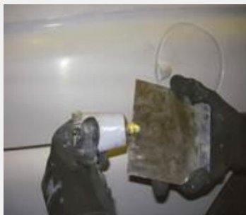
↑ 5.66 irudia. Poroak estaltzeko 1K mastika akrilikoa.
