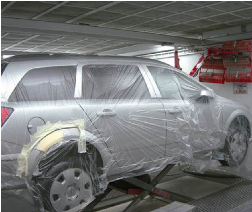
↑ 1.6 irudia. Prestaketa-zona xurgatze-planoz eta jasogailuz hornitua.
