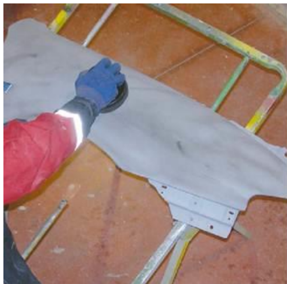
↑ 5.57 irudia. Lixatze-gidaria prestagaia eman zaion pieza baten gainean aplikatzea.
