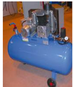
↑ 2.9 irudia. Konpresorean integratutako depositua.
