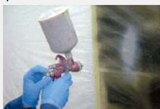
↑ 4.46 irudia. Pistolaren erregulazioa.
