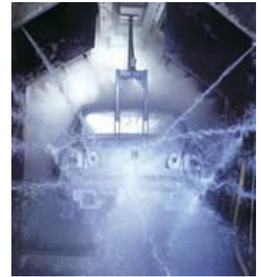
↑ 3.44 irudia. Ur desionizatuaren inhinztatzea (Iturria: VW).
