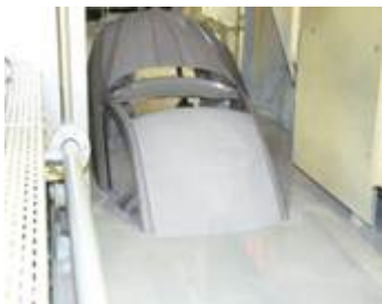
↑ 4.1 irudia. Kataforesi-bainua fabrikazioan.
