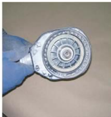
↑ 5.39 irudia. Lixagailu birakari-orbital baten platera ordeztzea.
