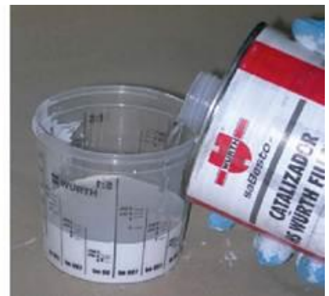
↑ 6.26 irudia. 2K HS prestagai baten eta katalizatzailearen formulazioa.
