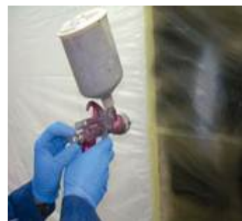
↑ 1.21 irudia. Ekipamendu aerografikoaren erregulazio egokia.
