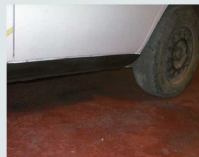
↑ 7.49 irudia. Hartxintzarren aurkako babeslea lehortuta, eta karrozeriako pinturaz pintatzeko prest.
