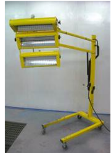
↑ 2.64 irudia. Izpi infragorri bidezko lehortze-ekipamendu modularra.
