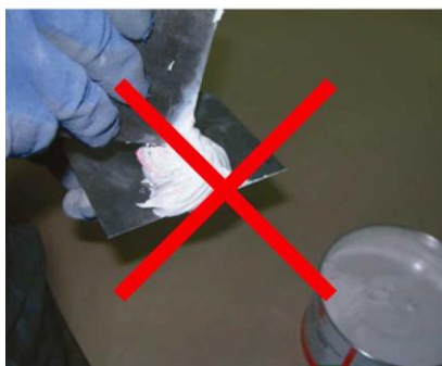
↑ 5.16 irudia. Mastikaren nahaste desegokia, zirkuluak eginez. Mastikaren nahaste egokia, hura moztuz, homogeneizatzen den arte.
