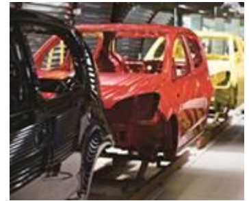
↑ 3.38 irudia. Akabera-pintura korrosioaren aurkako estaldura nagusi gisa.
