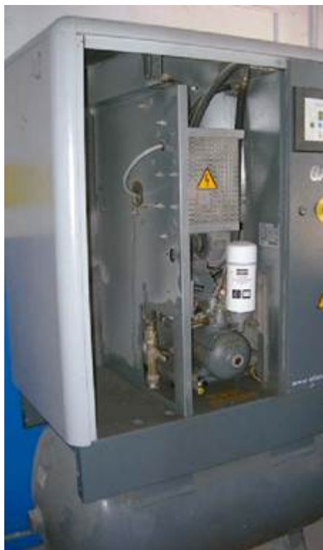
↑ 2.8 irudia. Torloju birakaridun konpresorea, depositua behealdean duena.
