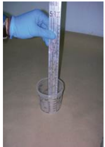
↑ 4.28 irudia. Proporzio-erregelarekin katalizatzea.
