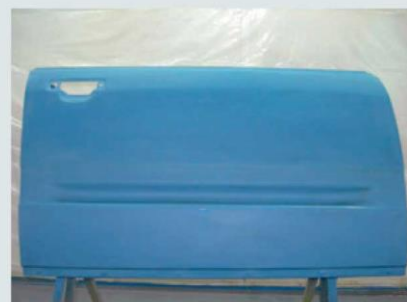
↑ 6.64 irudia. Akaberako pinturaz langartzeko prest dagoen panela.
