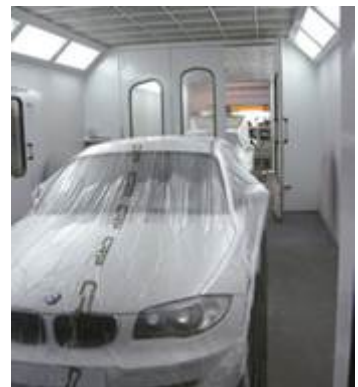
↑ 1.5 irudia. Sarrera alde batetik eta irteera beste aldetik dituen kabina bikoitza.
