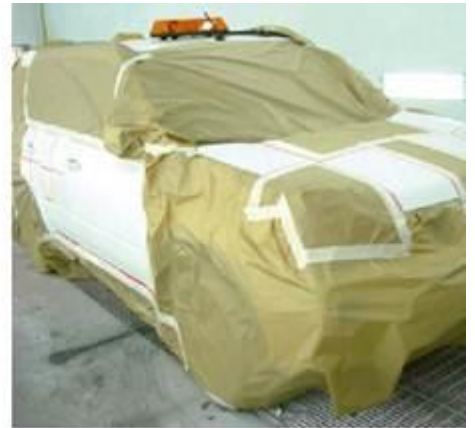
↑ 6.42 irudia. Apaindu beharreko ibilgailu bat maskaratzeko paperez eta zintaz maskaratzea.
