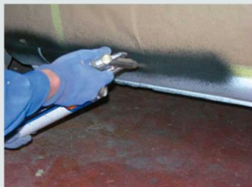
↑ 7.45 irudia. Hartxintzarren aurkako babeslea aplikatzen hasten.
