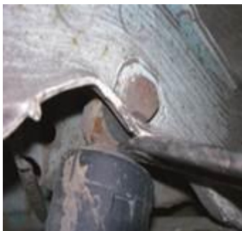
↑ 3.21 irudia. Oxidoa motelgailuak finkatzeko euskarrietan.
