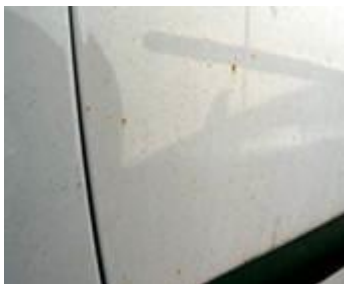
↑ 3.15 irudia. Pikatu-formako korrosioa.
