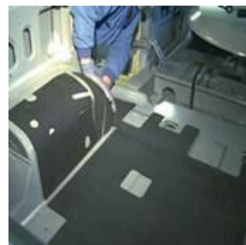
↑ 7.32 irudia. Ibilgailu baten fabrikazioan muntatutako babes akustikoko xaflak.
