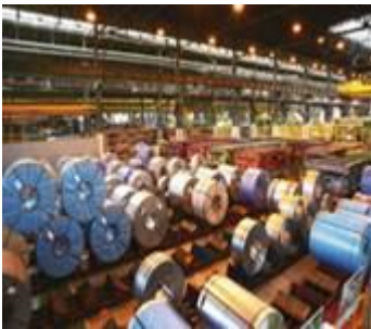
↑ 3.42 irudia. Altzairuzko xaflazko bobinak karrozeriak fabrikatzeko.
