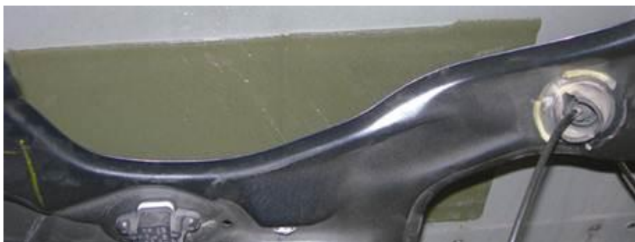
↑ 7.34 irudia. Bibrazioaren aurkako xafla itsasgarria ateen panelaren barruko aldean.
