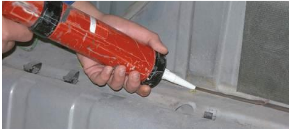
↑ 7.28 irudia. Zigilatzailea pistola pneumatikoz aplikatzen.
