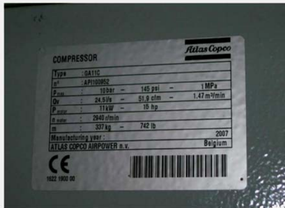
↑ 2.74 irudia. Aire-konpresorearen multzoaren ezaugarri teknikoak dituen plaka.
