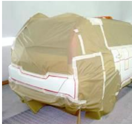
↑ 6.42 irudia. Apaindu beharreko ibilgailu bat maskaratzeko paperez eta zintaz maskaratzea.
