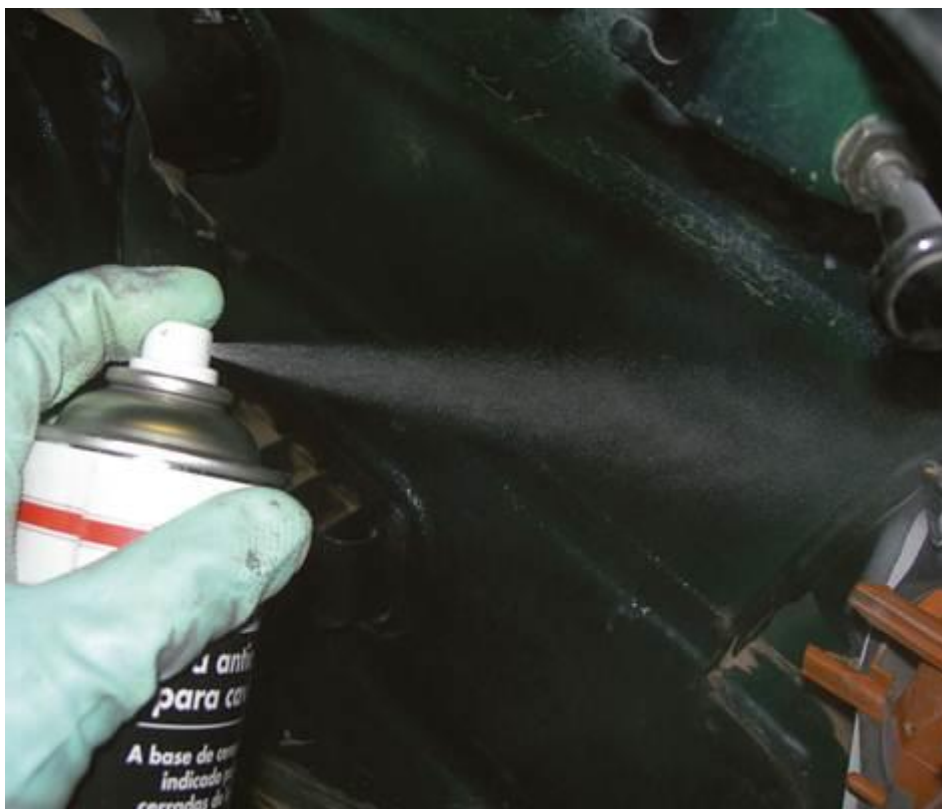
↑ 7.14 irudia. Hutsuneetarako argizaria aerosolez aplikatzen konpondutako panel baten atzeko aldean.
