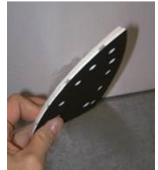
↑ 5.36 irudia. Hauts-xurgaketa duen lixagailu bibratzailerako platera.
