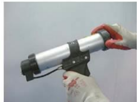
↑ 7.31 irudia. Zigilatzaile-tutu bat pistola pneumatiko batean muntatzea.
