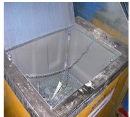
↑ 2.68 irudia. Disolbatzaile-oinarriko pinturetarako ikuzgailu automatiko baten barnealdea.
