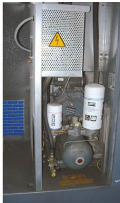
↑ 2.8 irudia. Torloju birakaridun konpresorea, depositua behealdean duena.
