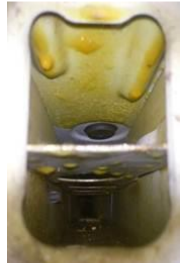
↑ 7.10 irudia. Hutsuneetarako argizaria, bastidorearen punta baten barruko aldean.
