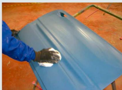
↑ 6.63 irudia. Panela garbitu eta koipegabetzea.
