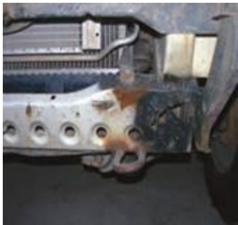
↑ 3.20 irudia. Oxidoa eta herdoila bastidorearen aurrealdeko zeharragan.
