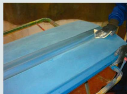
↑ 6.61 irudia. Gune biribilduak kuxin urratzailearekin lixatzea.
