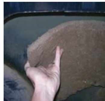
↑ 7.35 irudia. Ehun-zuntzez osatutako zarataren eta bibrazioaren aurkako xaflak.
