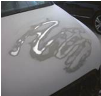
↑ 4.22 irudia. Xafla biluziko zona batzuk kapot batean; haietan, inprimazioa aplikatu behar da.
