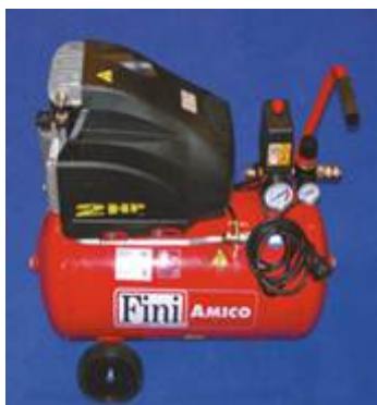
↑ 2.7 irudia. Konpresore eramangarri pistoiduna.
