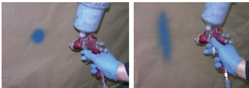
↑ 2.45 irudia. Irteera-konoaren erregulagailua itxita eta irekita
