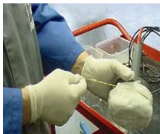
↑ 4.14 irudia. Txanoa anodoaren gainean muntatzen da.
