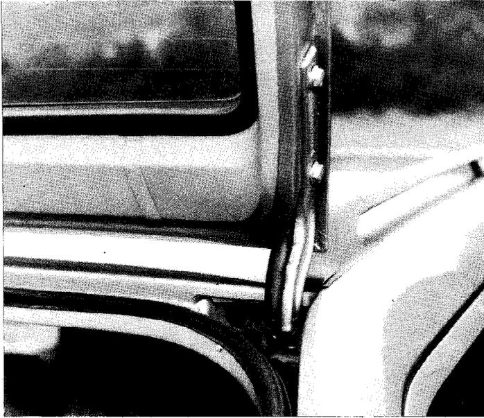
Tornillos de fijación del portón (break).
