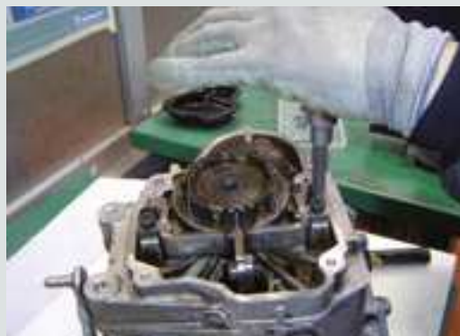
↑ 3.84. irudia. Bosgarren eragintza-sistema desmuntatzen.
