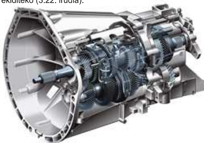
↑ 3.22. irudia. Abiadura-kaxa hortz helikoidaldua eta sinkronizatzaileduna.
