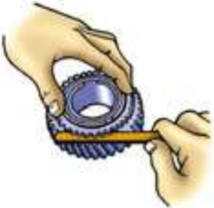
↑ 3.72. irudia. Sinkronizatzailearen eraztunaren higaduraren "a" kota neurtzea lodiera-galgarekin.
