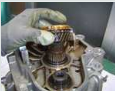
↑ 3.85. irudia. Bosgarren piñoi sekundarioa desmuntatzen.
