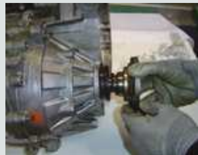
↑ 3.86. irudia. Palierraren ardatz ildaskatua kentzen.
