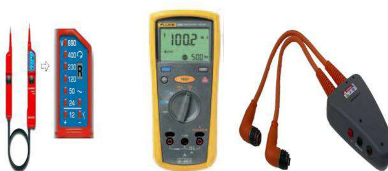
Tentsio-detekttagailua, isolamendu-neurgailua eta neurketa-egokigailu Porsche Cayenne Hybrid modelorako berezia
