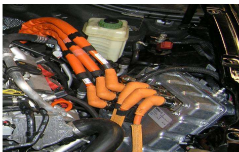
Segurtasun-estalkiak eta kable laranja goi-tentsioko osagaietan
