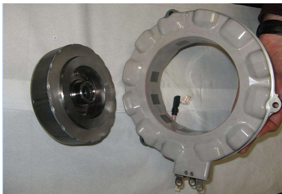
Toyotaren MG1 motorrean, imanak errotorean txertatuta daude
