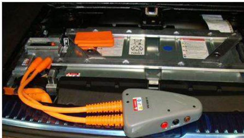
Sistema elektrikoaren kaxan tentsioa egiaztatzea, Porsche Cayenne Hybrid modeloan
