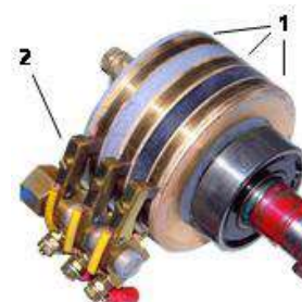
Uztail lerrakorren eta eskuilen xehetasuna
