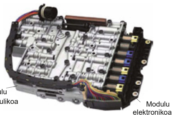
↑ 4.37. irudia. Modulu hidraulikoa eta kontrol-unitateak osatutako multzoa (iturria, Audi).
