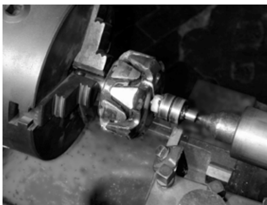
3.14. irudia. Marruskadura-eraztunen torneaketa.
