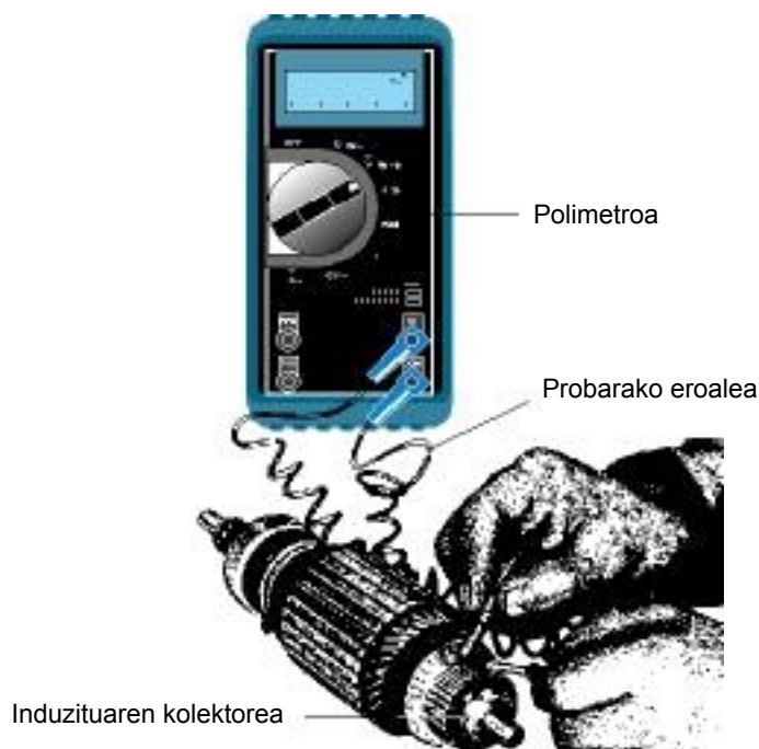
4.26. irudia. Induzituko jarraipen-proba, polimetro bidez.
