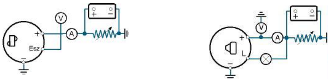
3.30-31. irudia. Alternadorera kontrol-lanpararik gabe konektatzea.
