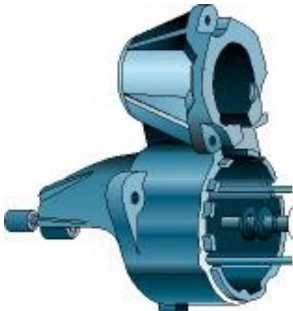
4.5. irudia. Eragintzaren aldeko euskarria, kontaktorearentzako kokalekuarekin.
