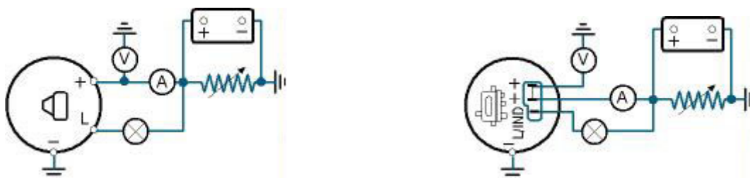
3.28-29. irudiak. Alternadorea kontrol-lanpararekin konektatzea.
