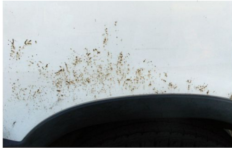
Korrosio kosmetikoaren eredia
