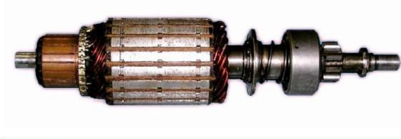
Figura 9.44. Inducido del motor de arranque.
