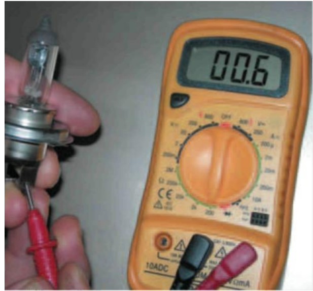
2.15 irudia. Erresistentziaren balioa: 0,6 \Omega .
