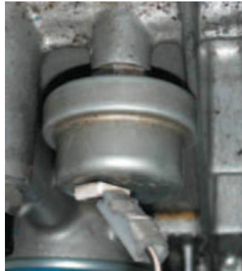
7.14 irudia. Manokontaktuaren muntaia motorrean.
