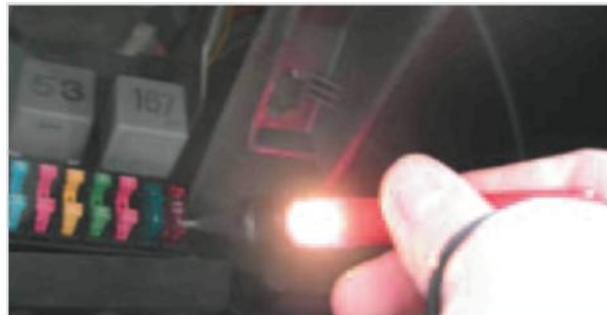
5.24 irudia. Jarraitutasuna egiaztatzea proba-lanpara duen fusiblearen bidez.
