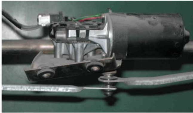
8.3 irudia. Haizetako-garbigailuaren motorraren muntaketa, hagekin.
