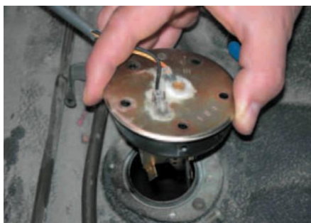
7.23 irudia. Flotatzailea desmuntatzea erregaiaren andeletik.
