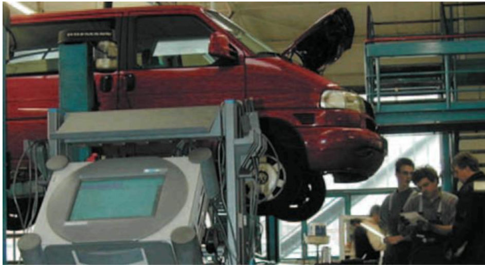
7.21 irudia. Matxura bat topatzea diagnostiko-ekipo baten bidez.
