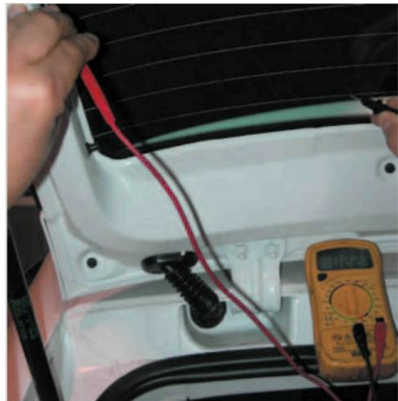
8.24 irudia. Luneta termikoan linea eten bat topatzea.
