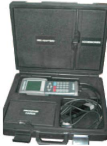
5.21 irudia. Zirkuitu elektronikoak diagnostikatzeko ekipoa, Toyota-ren polimetroa.
