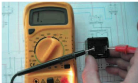
5.27 irudia. Erreleak ez du funtzionatzen.
