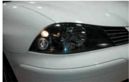
4.67 irudia. Egoera-argiaren funtzionamendua.
