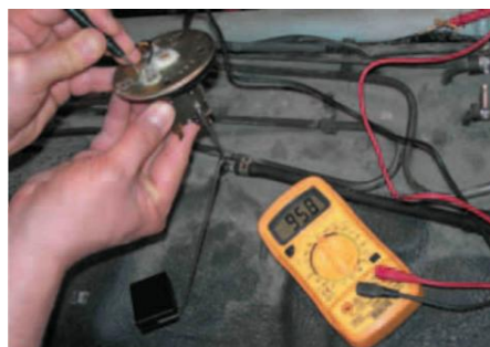
7.24 irudia. Flotatzailearen erresistentzia egiaztatzea.
