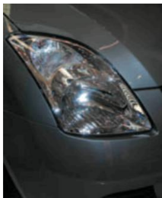
4.23 irudia. Faro nagusia, plastikozko barreiatzaileduna, Suzuki Swift.
