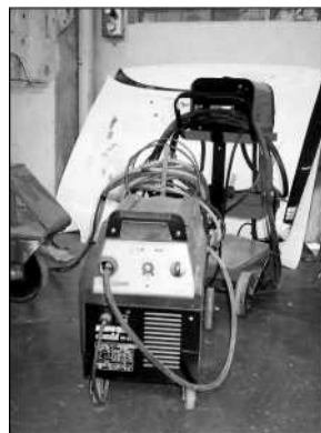
2.7 irudia. Arkuzko eta gasezko soldadura elektrikoa.
