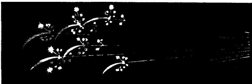
4.45. irudia. % 1,2 C eta % 1 W-dun barauts-altzairua.
