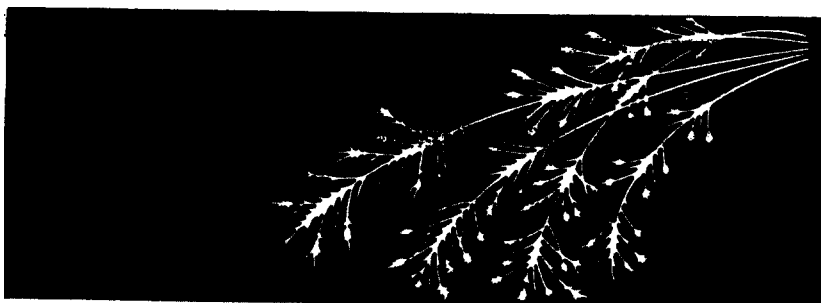
4.41. irudia. 0,7tik 1,3ra bitarteko C duen erreminta-altzairua.
