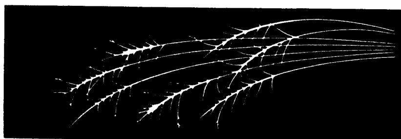
4.39. irudia. % 0,25tik 0,35ra bitarteko C duen karbono-altzairua.
