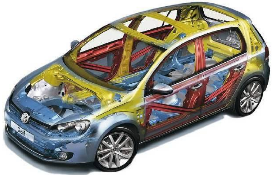
Figura 1.15. Conceptos de seguridad y resistencia en el diseño de una carrocería
