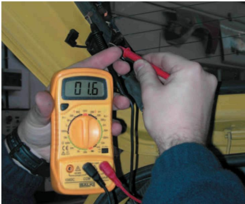
8.18 irudia. Erresistentzia polimetro bidez egiaztatzea.
