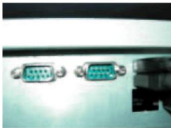
9.15 irudia. Diagnostiko-ekipo baten edo ordenagailu baten serieko atakak.
