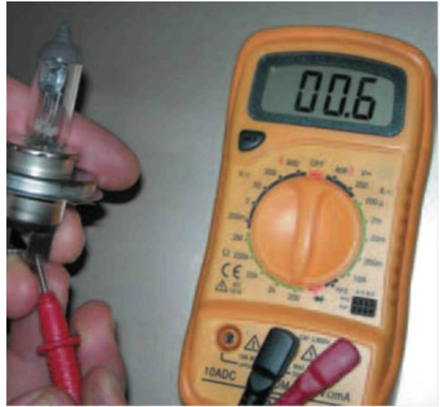
2.15 irudia. Erresistentziaren balioa: 0,6 \Omega .
