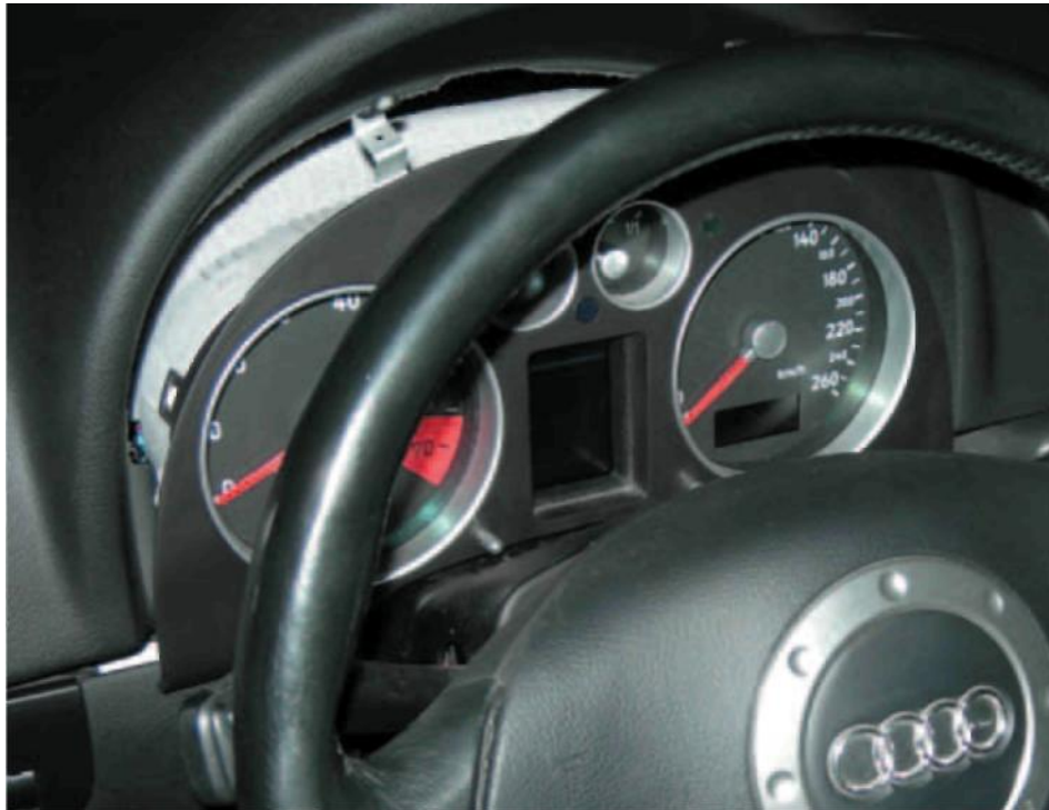
7.20 irudia. Panel bat desmuntatzea, Audi TT.
