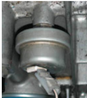
7.14 irudia. Manokontaktuaren muntaia motorrean.
