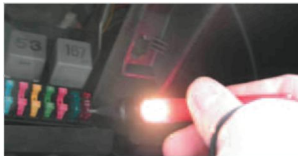
5.24 irudia. Jarraitutasuna egiaztatzea proba-lanpara duen fusiblearen bidez.
