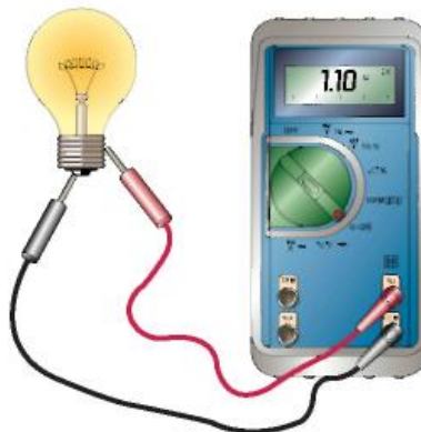
1.24 irudia. Erresistentziaren neurketa, jarraitutasuna.
