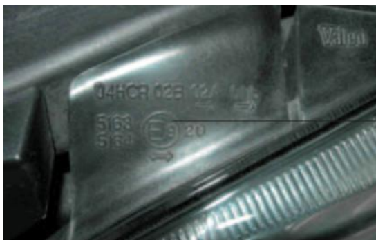
4.9 irudia. Faro baten homologazioaren adibidea.
