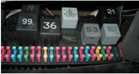
5.25 irudia. Argi keinukarien errelearen identifikazioa.
