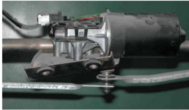
8.3 irudia. Haizetako-garbigailuaren motorraren muntaketa, hagekin.
