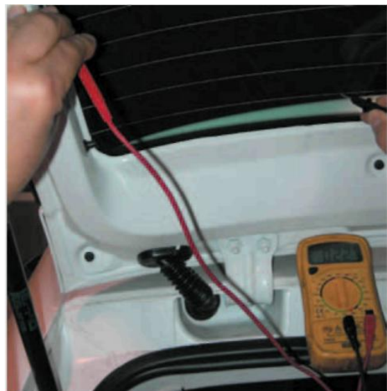
8.24 irudia. Luneta termikoan linea eten bat topatzea.
