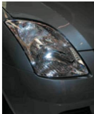
4.23 irudia. Faro nagusia, plastikozko barreiatzaileduna, Suzuki Swift.
