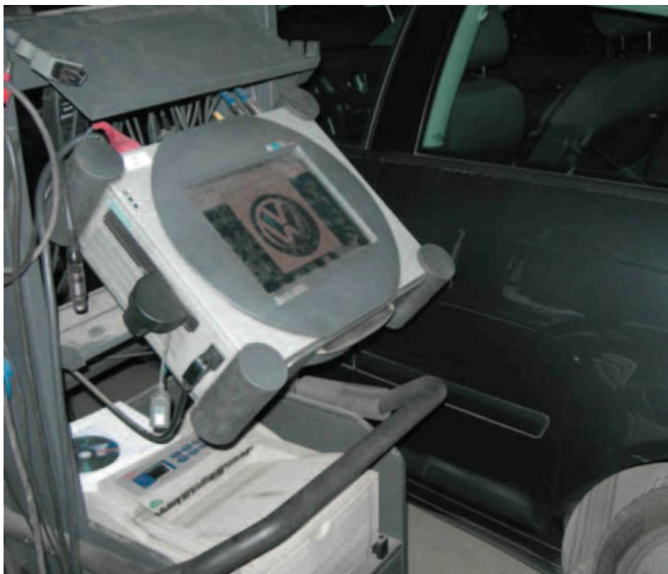
10.2 irudia. Ibilgailu bat diagnostiko-ekipo baten bidez egiaztatzea.
