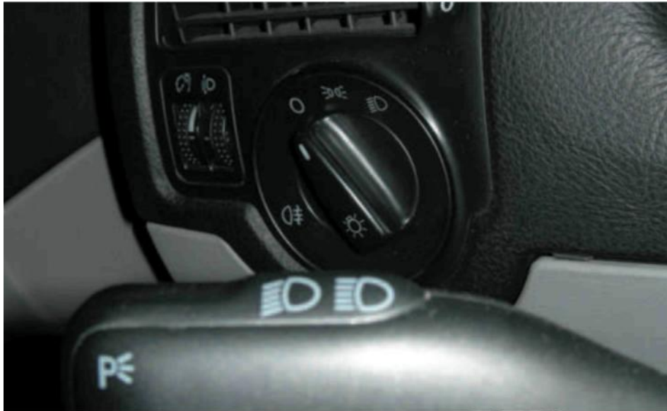
3.10 irudia. Argi-aginteen (luzeak/laburrak), argi-keinuen eta keinukarien agintearen kommutadorea eta funtzio anitzeko etengailua.
