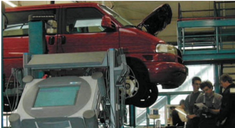
7.21 irudia. Matxura bat topatzea diagnostiko-ekipo baten bidez.
