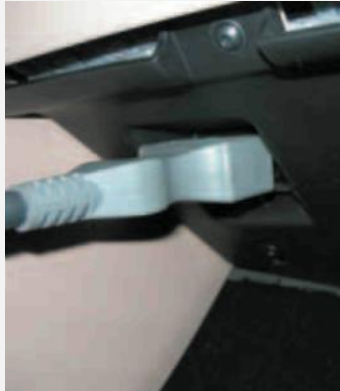
10.1 irudia. Diagnostiko-ekipoaren konexioa.
