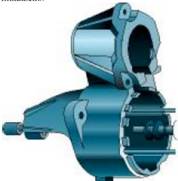
4.5. irudia. Eragintzaren aldeko euskarria, kontaktorearentzako kokalekuarekin.
