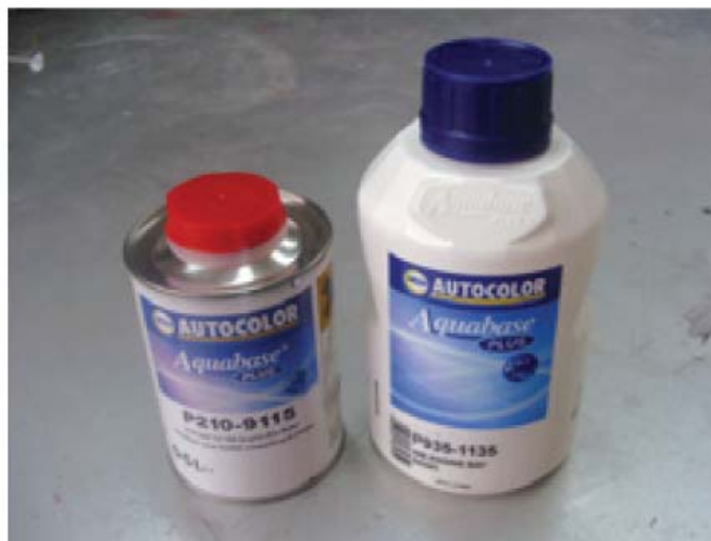
↑5.33.Irudia. Bi geruzako pinturari botatzen zaion gehigarria, geruza bakarreko pintura bihurtzen du.
