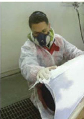
↑5.3.Irudia. Piezak garbitzen, pintatu aurretik
