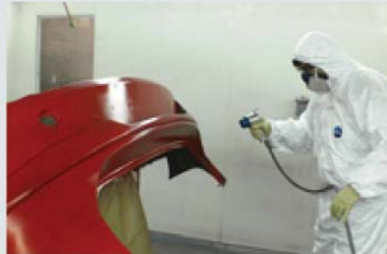
↑6.32.Irudia. Pintura lehortzea Venturi efektuaren bidez
