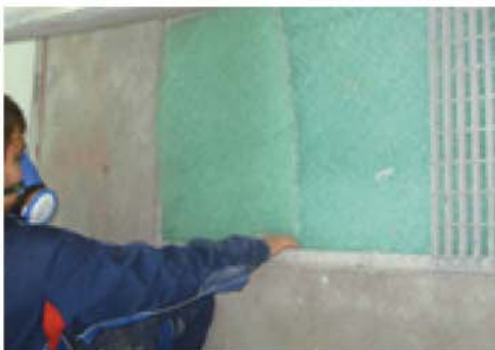
↑1.8.Irudia. Kabina-zuloguneko burdin sarea eta paint stop iragazkiak
