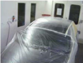
↑3.24.Irudia. Plastikofilmaz estalitako ibilgailua
