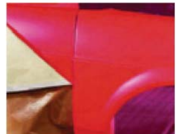
↑7.34. Irudia. Bi piezetan, kolorea gaizki berdinduta
