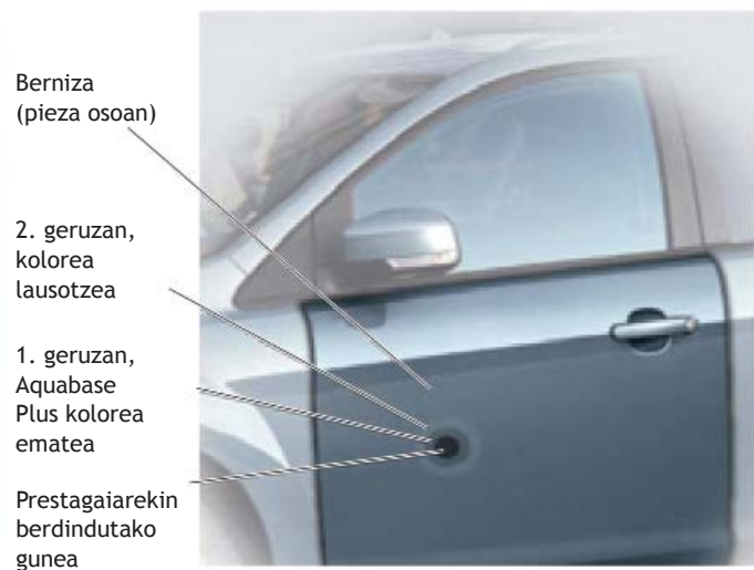
↑7.42.Irudia. Pieza osoan, lausotze-teknika bi geruzako pinturarekin (jatorria: Nexa)
