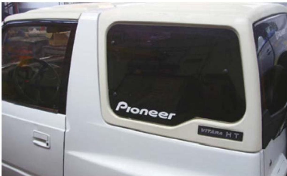
↑6.6.Irudia. 4x4 ibilgailu baten beira-zuntzezko kapota
