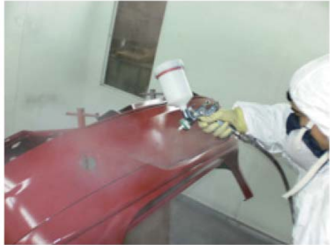
↑2.27.Irudia. Pintura bernizatzea
