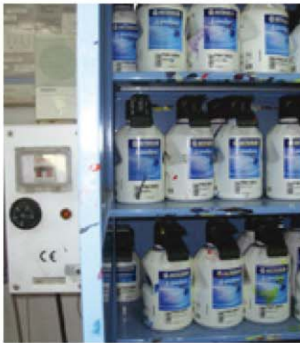
↑1.17.Irudia. Termostatoaren bidez kontrolatutako armairua
