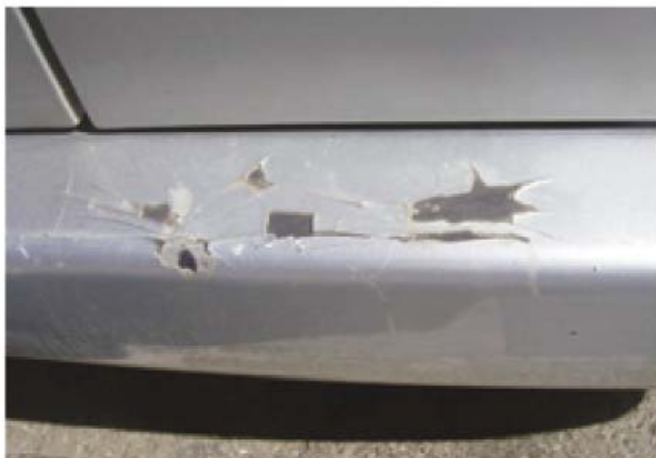
↑7.3.Irudia. Kolpe-leungailuan, pintura-kalteak
