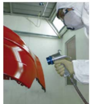
↑5.27.Irudia. Irudian, eskuko Venturi lehorgailuarekin pintura lehortzen.
