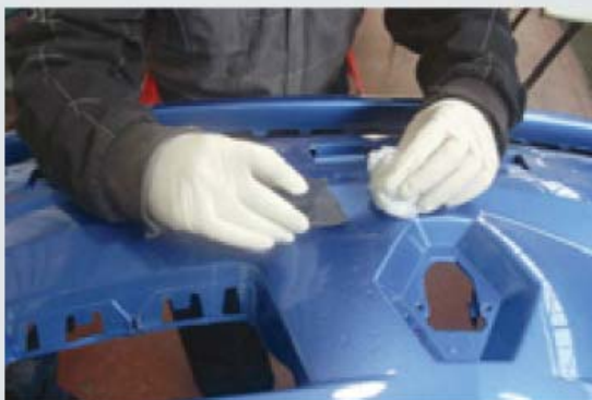
↑6.29.Irudia. P-1200 eta P-2000 ur-lixekin, lixatzea
