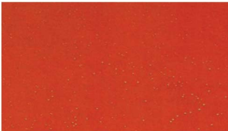
↑7.13.Irudia. Orratz-puntuak eta irakiteak (Iturria: Valentine)
