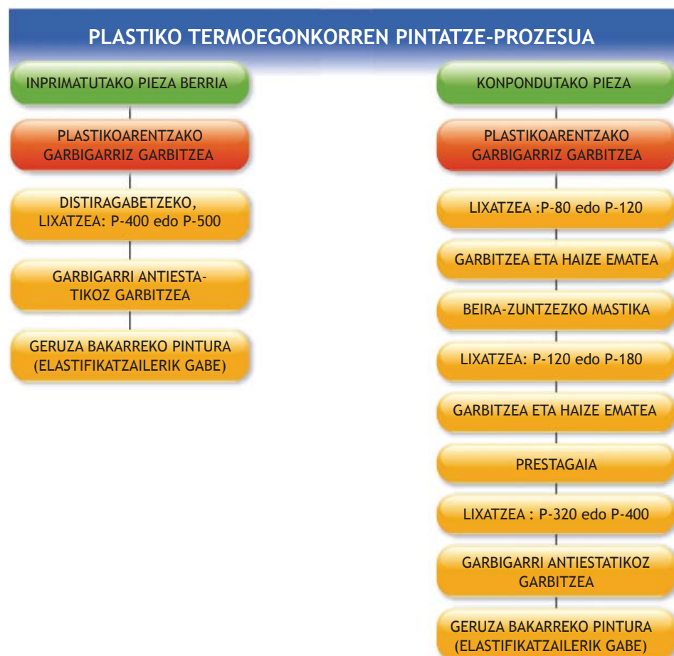
↑6.14. Irudia. Plastikoen termoeogonkorren pintatze-prozesua
