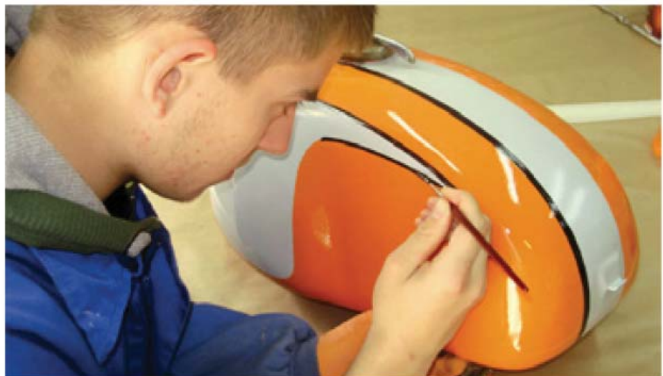
↑8.20. Irudia. Ertzak pintura beltzarekin pintatzea
