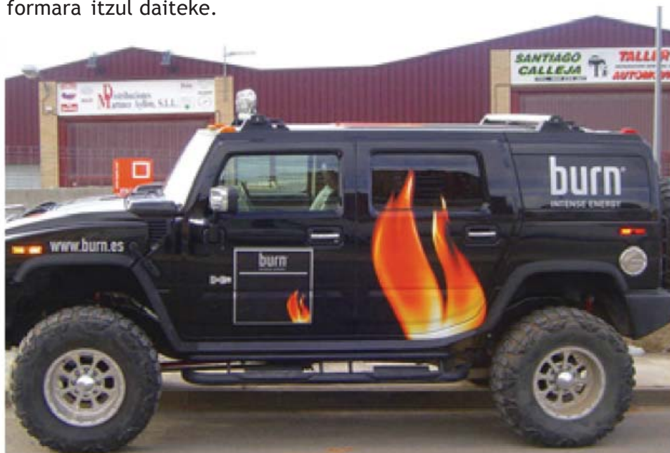
↑8.45. Irudia. Biniloa ibilgailuan itsatsita
