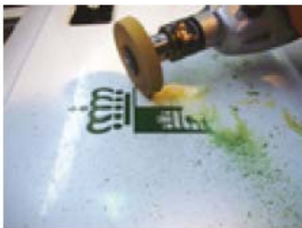
↑8.40. Irudia. Erraminta pneumatikoarekin eta arrabola bereziarekin, biniloa kentzea
