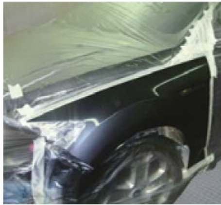
↑3.2. Irudia. Hegats baten ondoko piezak estaltzea
