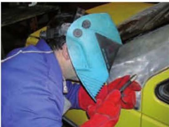
Figura 11.96. Posición correcta para soldar.
