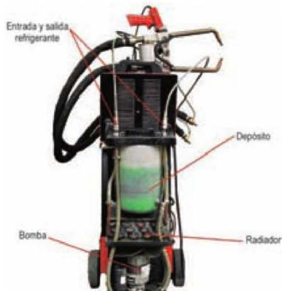
Figura 11.146. Circuito de refrigeración de los electrodos.
