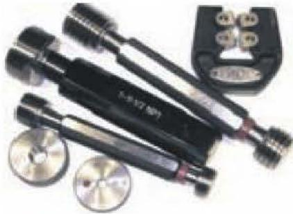
Figura 2.89. Útiles de comprobación de roscas.
