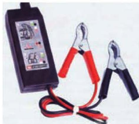
Figura 11.93. Protector para circuitos electrónicos.
