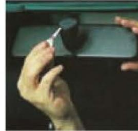
Figura 5.108. Adhesivos para retrovisores interiores.
