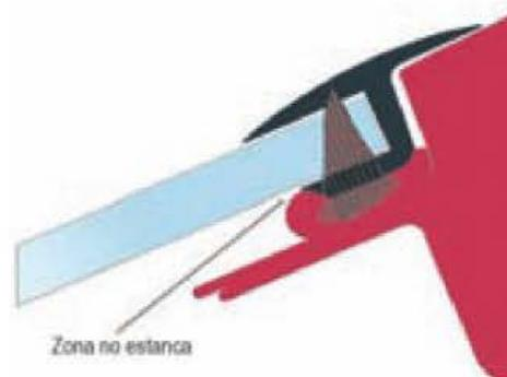
Figura 7.81. Zona no estanca por no haber aplicado el adhesivo sobre el cristal.
