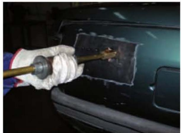
Figura 8.63. Tracción de una estrella soldada con el martillo de inercia.
