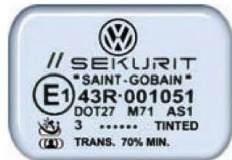
Figura 7.21. Marcaje de una luna parabrisas.
