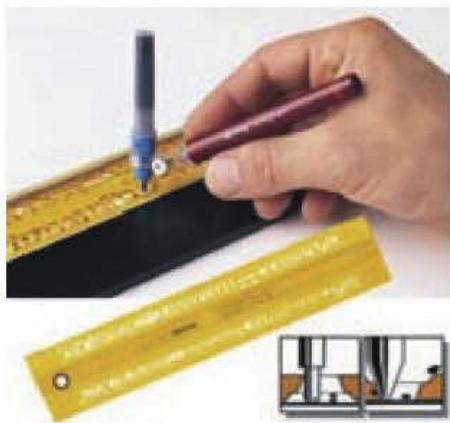
Figura 1.13. Utilización de plantillas de rotular.
