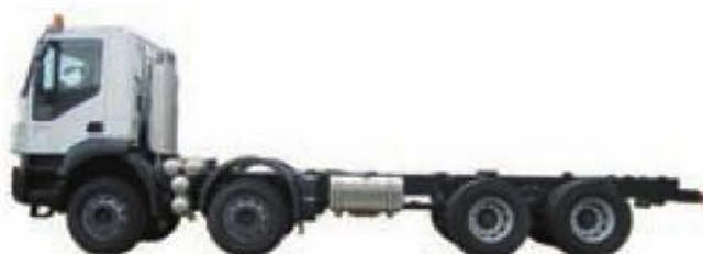
Figura 4.37. Vehículo industrial pesado tipo «chasis-cabina».
