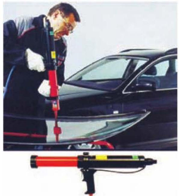
Figura 10.49. Aplicador monocomponente neumático.
