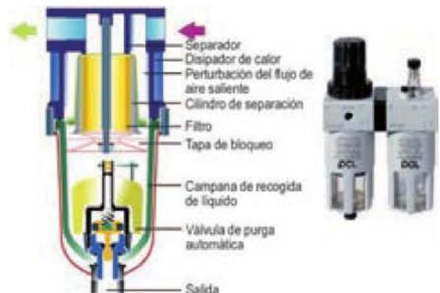
Figura 3.29. Constitución de un filtro decantador.
