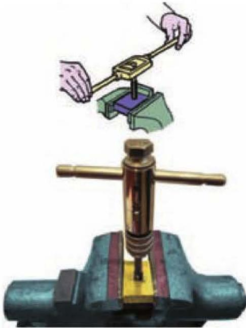
Figura 2.100. Ejecución del roscado.
