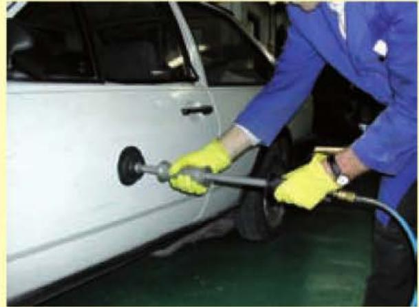
Figura 1. Acoplar la ventosa neumática sobre la superficie, y lanzar la masa de inercia para extraer la abolladura.
