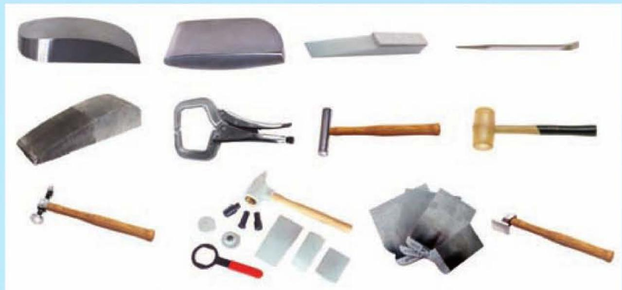
Figura 8.21. Herramientas para la reparación de aluminio.
