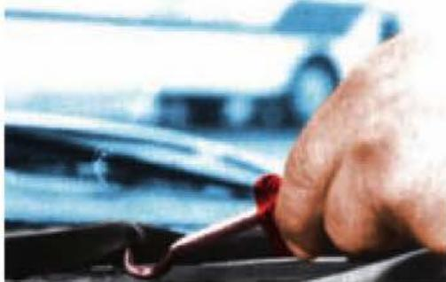
**Figura 7.40.** Utilización de un gancho para facilitar la colocación de la goma de contorno.
