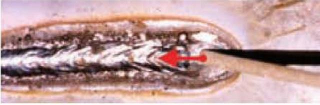
Figura 11.46. Proceso para retirar el electrodo del cordón de soldadura.
