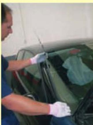
10. Desmontaje del espejo retrovisor.
