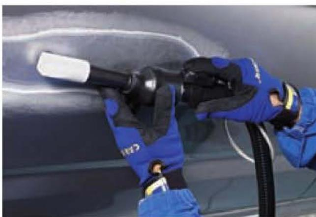
Figura 8.40.b. Aplicación de calor con el equipo de inducción.
