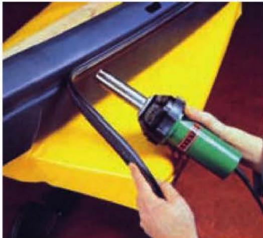
Figura 9.85. Despegado de molduras con soldador de aire caliente.
