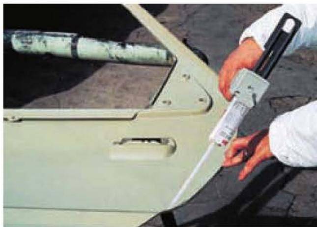
Figura 10.34. Unión panel exterior.
