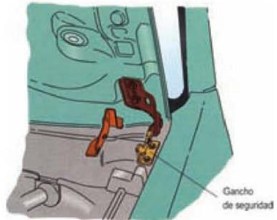
**Figura 6.62.** Fijación del capó al pase de ruedas.
