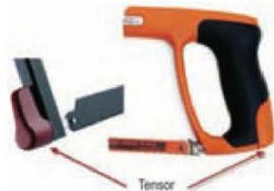
Figura 2.24. Dispositivos tensores.
