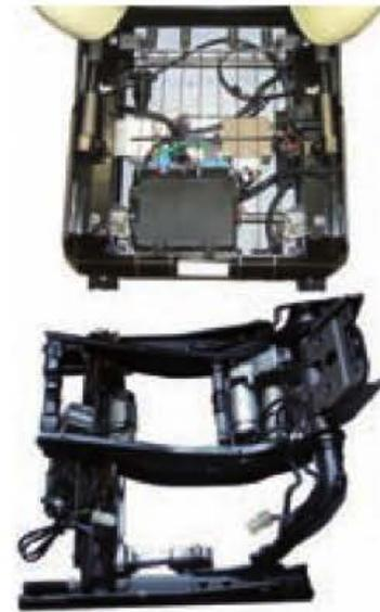
Figura 6.186. Aspectos que presenta la estructura de la base del asiento, una vez desmontado el cojín.
