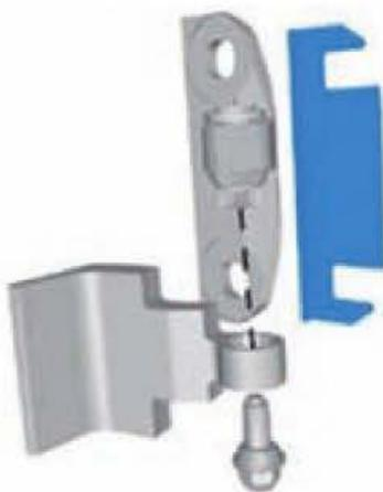
Figura 6.18. Bisagra mixta: atornillada y soldada.
