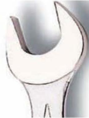
Figura 3.55. Llave con boca deformada.
