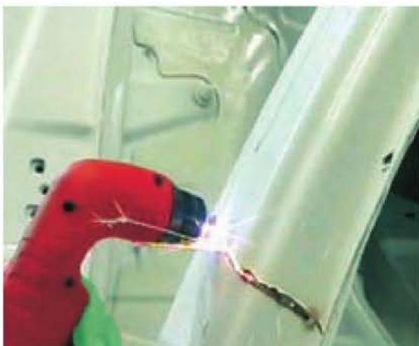
Figura 12.50. Cortando pilar central con plasma.
