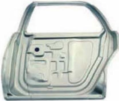
Figura 6.4. Bastidor de chapa embutida de la estructura de una puerta.
