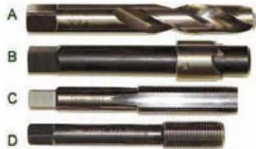
Figura 5.55. Equipo de colocación de casquillos roscados.
