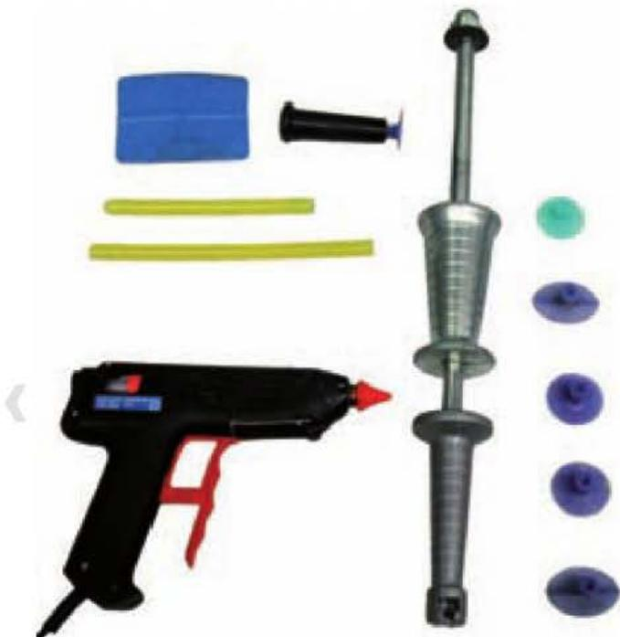
Figura 8.91. Útiles del equipo de ventosas adhesivas con martillo de inercia como sistema de tracción.
