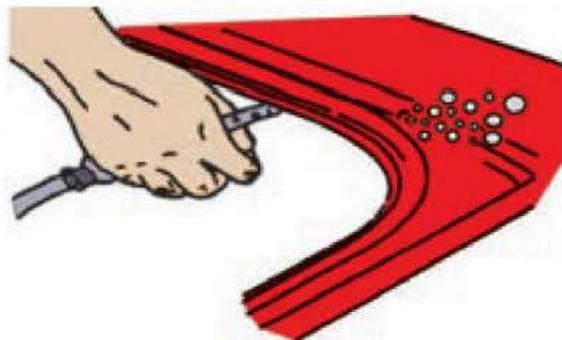
Figura 6.157. Soplado con aire a presión. Donde existan fugas saldrán burbujas.
