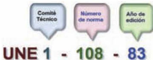
Figura 1.5. Estructura de una norma UNE.
