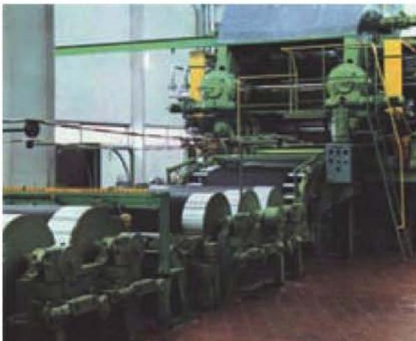
Figura 9.45. Proceso de fabricación de calandrado.
