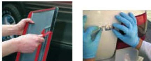
Figura 5.101. Aplicación de cintas adhesivas de doble cara.
