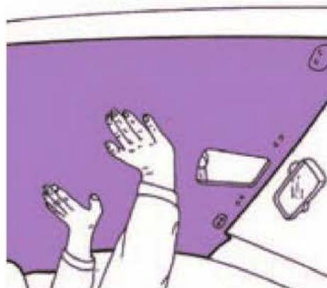
Figura 6.206. Ejercer presión sobre el techo para completar el montaje.
