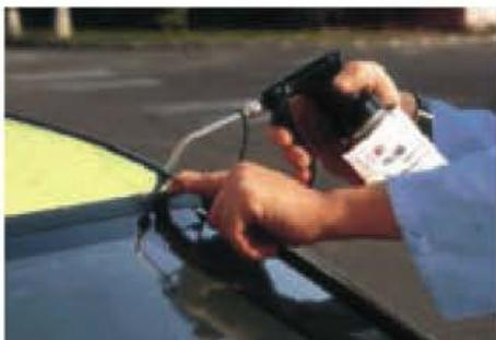
Figura 7.64. Aplicación de masilas para lunas.
