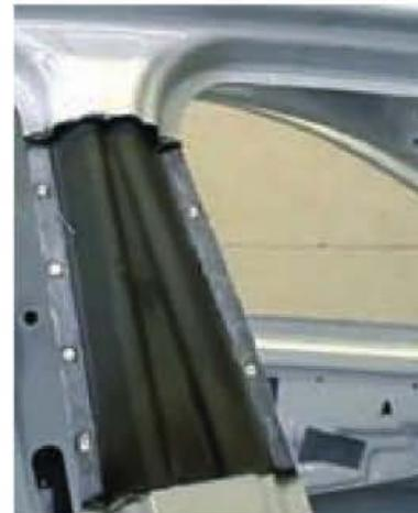
Figura 12.27. Poca deformación en la pieza base.
