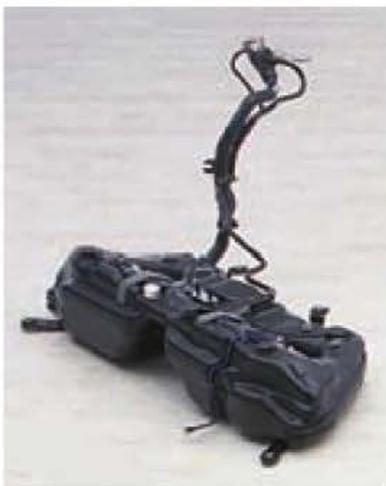
Figura 9.42. Depósito de combustible.
