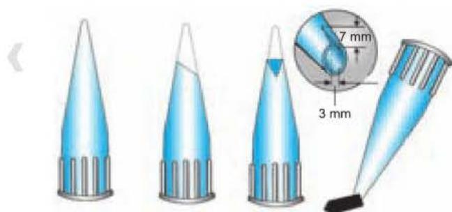
Figura 7.78. Corte correcto de la boquilla de aplicación.
