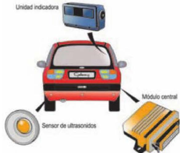
Figura 6.125. Elementos del sistema de aparcamiento.
