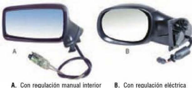
Figura 6.40. Espejos retrovisores exteriores.
