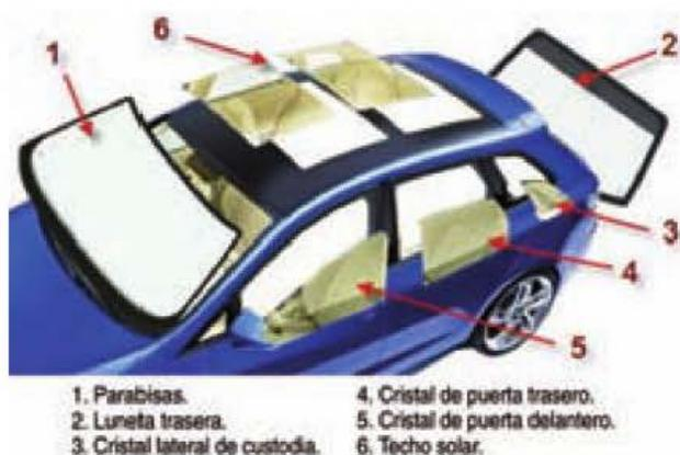
Figura 7.3. Elementos del acristalamiento del vehículo.
