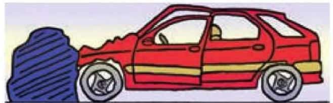
Figura 8.29. La deformación del techo se ha producido por la transmisión de fuerzas a través de la estructura, a causa del golpe en la parte frontal y de la inercia del resto de vehículo.
