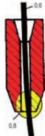
Figura 11.67. Tubo de contacto erróneo.
