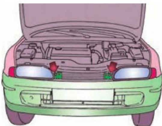
**Figura 6.119.** Desmontar los tornillos de fijación a la travesía delantera.
