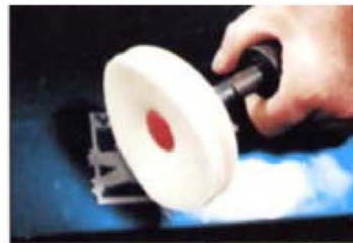
Figura 6.212. Eliminación del adhesivo con discos específicos.
