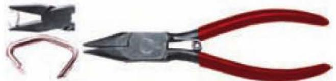
Figura 6.187. Herramienta para insertar grapas de fijación del relleno y tapizado del asiento.
