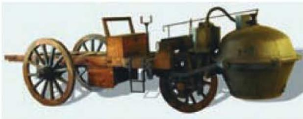
**Figura 4.1.** El vehículo autopropulsado más antiguo que se conserva es un tractor de artillería de tres ruedas construido por el ingeniero francés José Cugnot.
