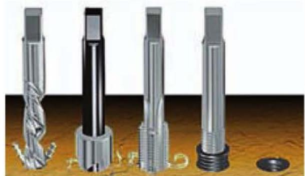
Figura 5.56. Proceso de colocación de casquillos roscados.
