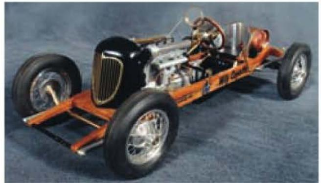
**Figura 4.3.** Bastidor fabricado con largueros de madera.
