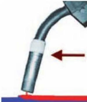
Figura 11.99. Desplazamiento hacia adelante.
