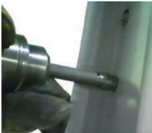
Figura 12.20. Despuntado con fresa
