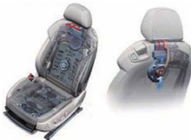
Figura 6.172. Estructura de un asiento motorizado y con sistema de ventilación.
