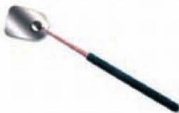
Figura 6.158. Espejo orientable con mango telescópico.
