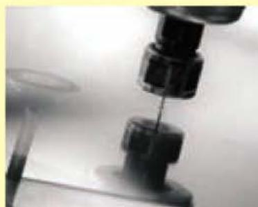
Figura 7.3. Taladrado de la capa de vidrio para facilitar la entrada de la resina.
