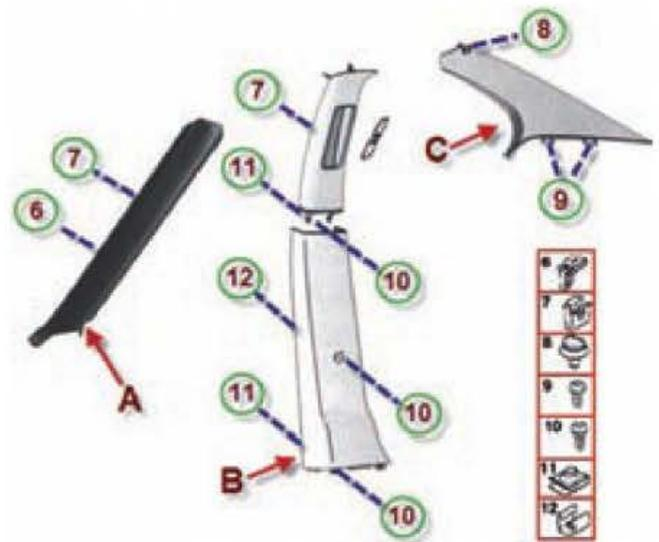
Figura 6.194. Revestimientos y sistema de fijación de los pilares: delantero (A), central (B) y trasero (C).
