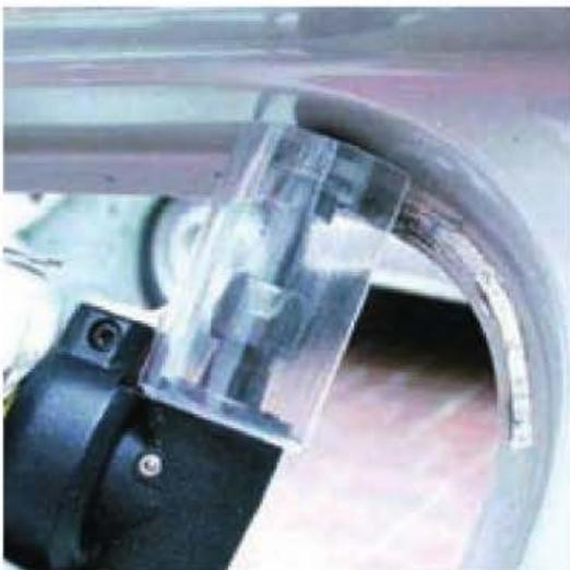
Figura 12.41. Láser Cutter con protector.
