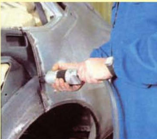
19.º Montar de nuevo la aleta, ajustándola correctamente y marcando el extremo del montante para realizar una unión a tope.
