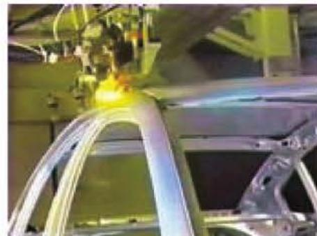
Figura 11.128. Unión del techo con láser.
