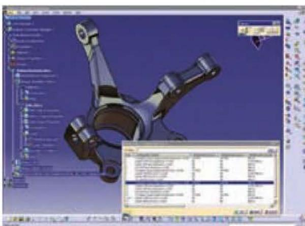
Figura 1.74. Diseño realizado mediante el programa CATIA.
