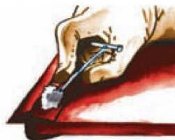
**Figura 7.77. Aplicación del activador sobre la junta vulcanizada.**
