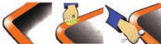
Figura 7.72. Limpieza y aplicación de imprimación sobre la luna con recubrimiento cerámico.
