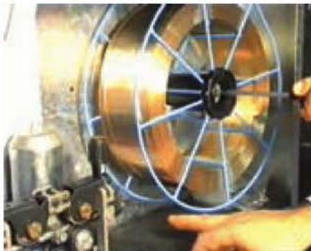
Figura 11.64. Comprobar la tensión de la bobina.
