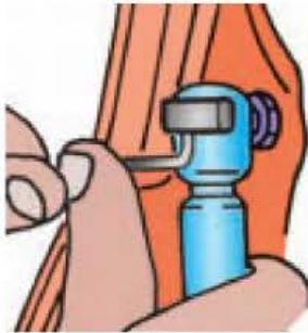
Figura 6.80. Extracción de la grapa del amortiguador.
