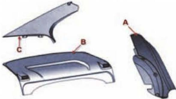
Figura 6.195. Revestimientos del pilar trasero.
