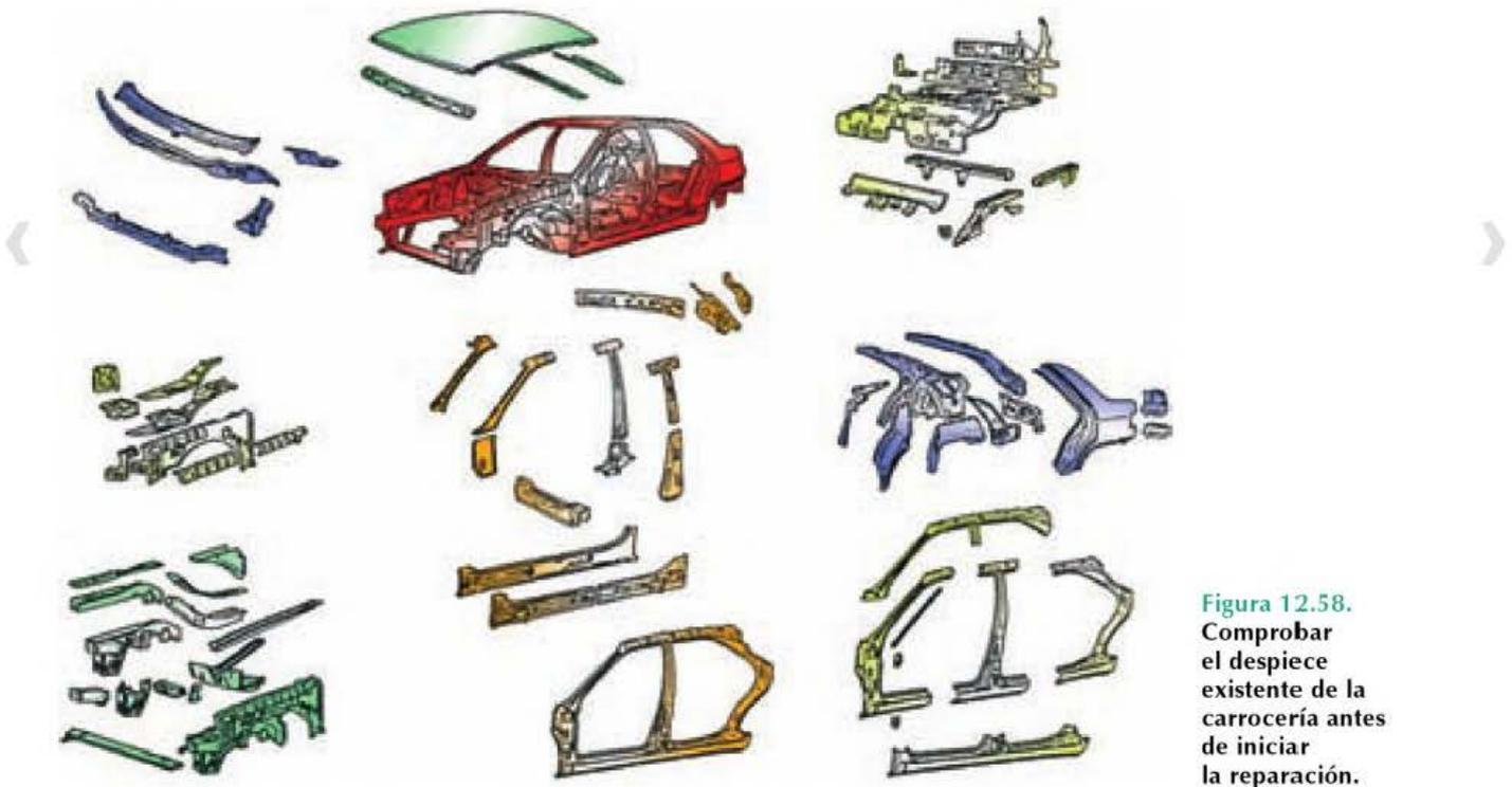
Figura 12.58. Comprobar el despiece existente de la carrocería antes de iniciar la reparación.
