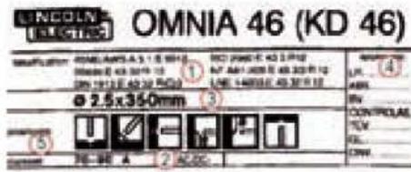
Figura 11.37. Etiqueta de identificación de los electrodos.
