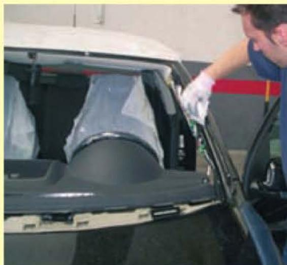
21. Retirada del parabrisas deteriorado.
