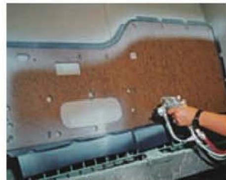
**Figura 5.98.** Aplicación de adhesivos de base acuosa.
