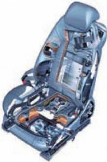
**Figura 6.173.** Estructura de un asiento que incorpora el sistema integrado del cinturón de seguridad.
