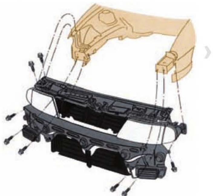
Figura 6.111. Desmontaje del frente delantero.
