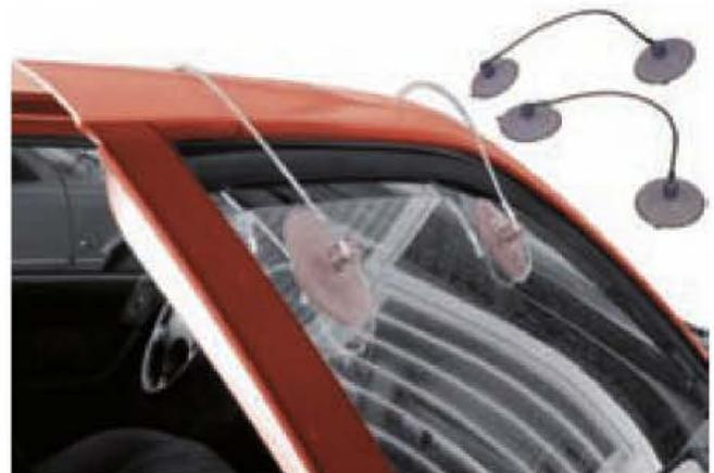
Figura 6.50. Ventosas para sujetar la luna de puerta.
