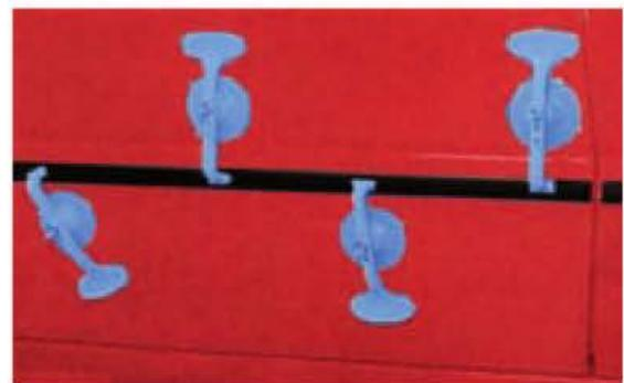
**Figura 6.216.** Utilización de ventosas para sujetar la moldura mientras «cura» el adhesivo.
