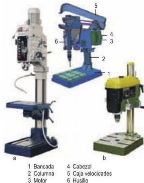
Figura 2.71. Taladradoras fijas: a) de columna; b) sensitivas (de sobremesa).
