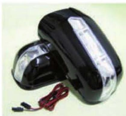
Figura 6.41. Espejo retrovisor con intermitente incorporado.
