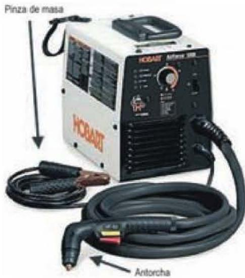
Figura 12.45. Máquina para cortar por plasma.
