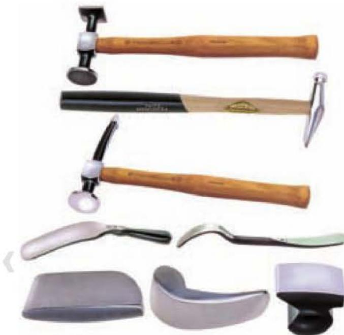
Figura 3.46. Diferentes tipos de martillos, tases y palancas.
