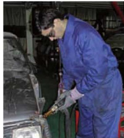
Figura 11.161. Soldar siempre con protección.
