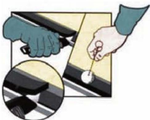
**Figura 7.91.** Nivelado del cordón de adhesivo residual y aplicación de activador en caso necesario.
