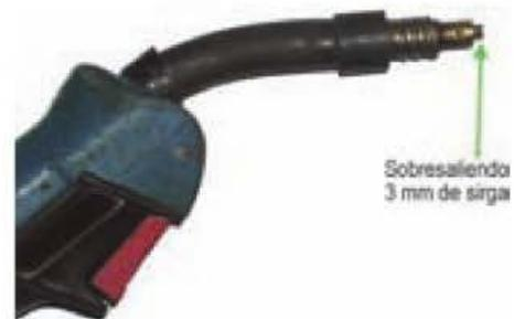
Figura 11.74. Comprobar la longitud de la sirga.
