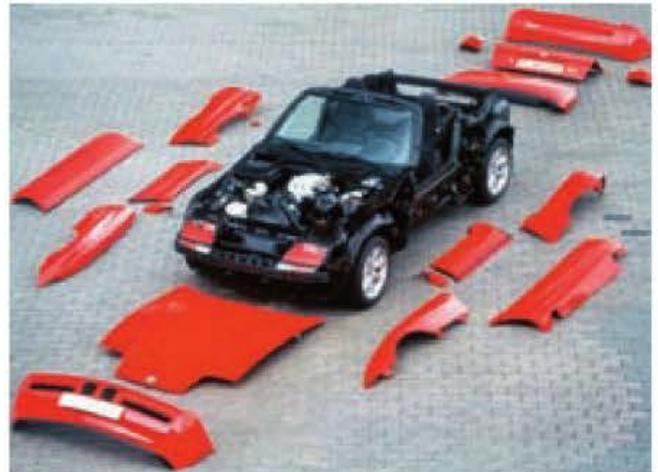
Figura 9.28. Piezas más habituales fabricadas en material termoplástico.
