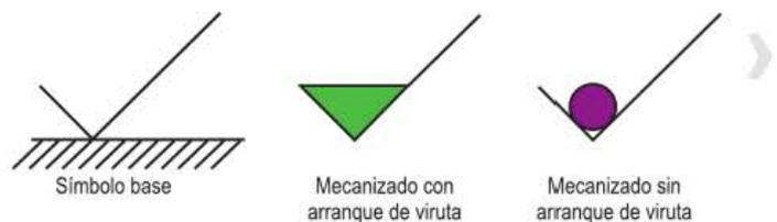
Figura 1.55. Simbología para el mecanizado.
