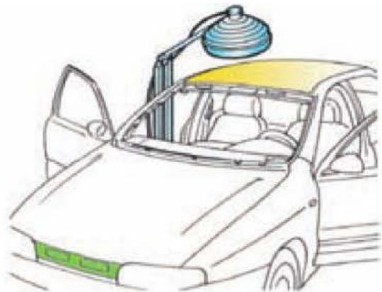
**Figura 6.202. Calentamiento del techo para reblandecer el adhesivo.**
