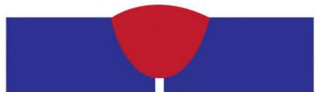
Figura 11.23. Falta de penetración.
