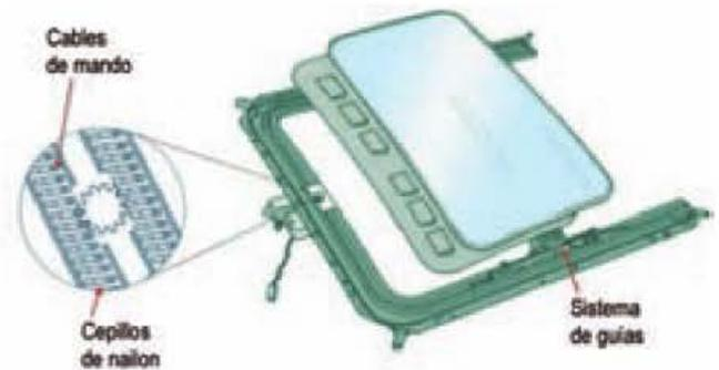
Figura 6.130. Cables de mando de un techo desplazable.
