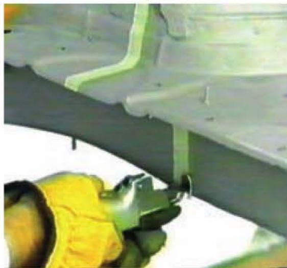
Figura 12.2. Marcado de línea de corte con cinta de enmascarar.
