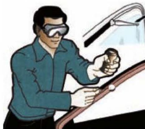
**Figura 7.69. Aplicación de un producto activador por todo el perímetro del cordón.**
