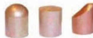
Figura 11.139. Punta de electrodos
