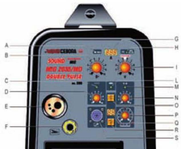
Figura 11.75. Mando de control de máquina MIG/MAG.
