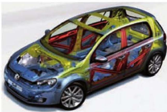
Figura 8.2. Elementos interiores de la carrocería.
