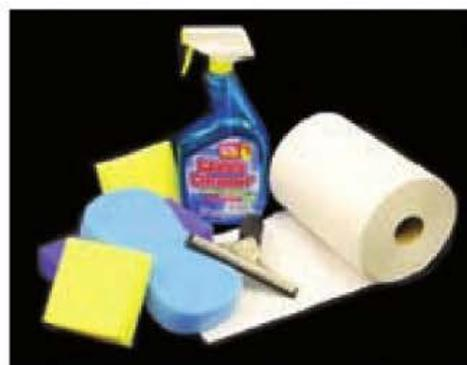
**Figura 7.104.** Útiles de limpieza adecuados para la operación de instalación de láminas solares.
