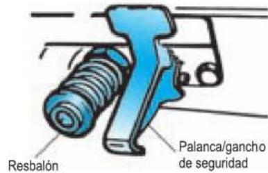
Figura 6.65. Conjunto de resbalón y palanca de seguridad.
