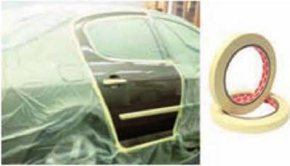
**Figura 5.104.** Aplicación de la cinta adhesiva de enmascarar.
