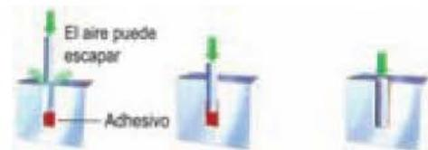
Figura 5.33. Aplicación de fijadores de roscas en agujeros ciegos.
