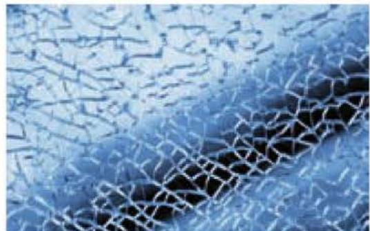
Figura 7.26. Rotura de un vidrio templado.
