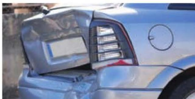
**Figura 9.75.** Ejemplo de daños en la parte trasera de un vehículo
