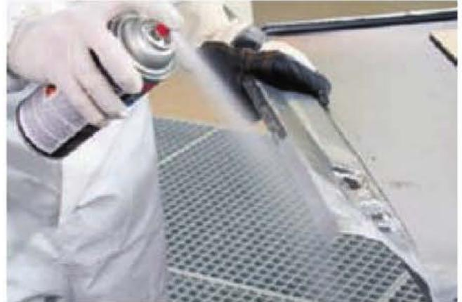
Figura 10.20. Imprimación con aerosol.
