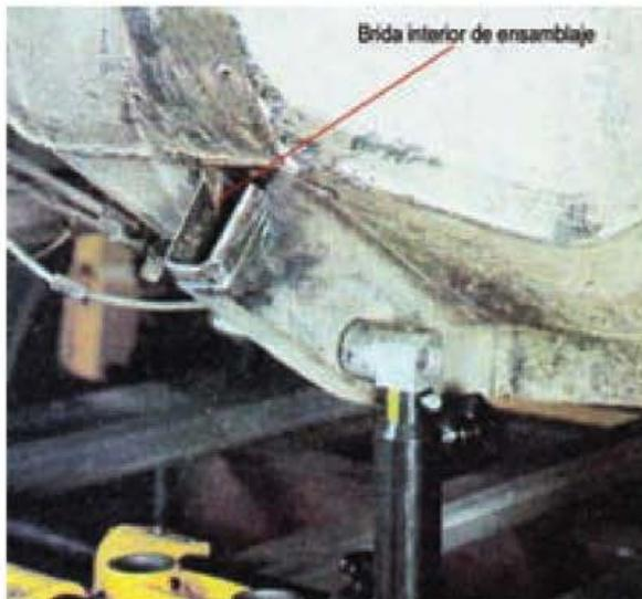
Figura 10.8. Unión con refuerzo de brida.
