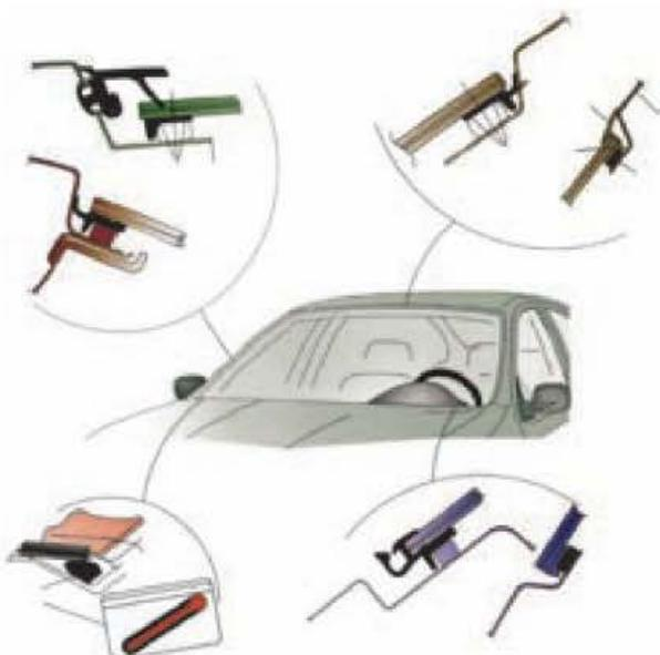
**Figura 7.75. Fijación de una luna parabrisas con perfil premontado.**
