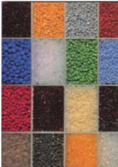
Figura 9.36. Materia prima utilizada en la elaboración de termoplásticos.
