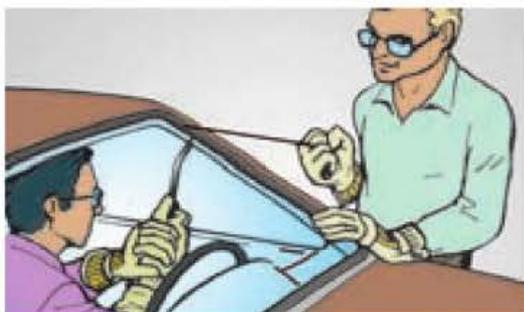
Figura 7.56. Ejecución del corte del adhesivo con el alambre acerado.
