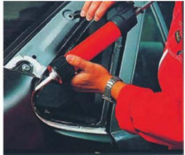
Figura 10.48. Aplicador monocomponente manual.
