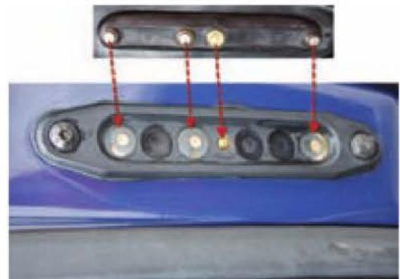
Figura 6.79. Contactos eléctricos móviles.
