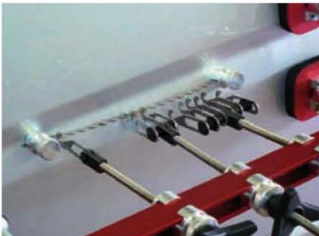
Figura 8.77. Acoplamiento del equipo de palancas sobre el útil de tracción soldado.
