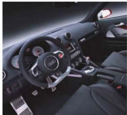
Figura 9.48. Elementos fabricados por espumación.
