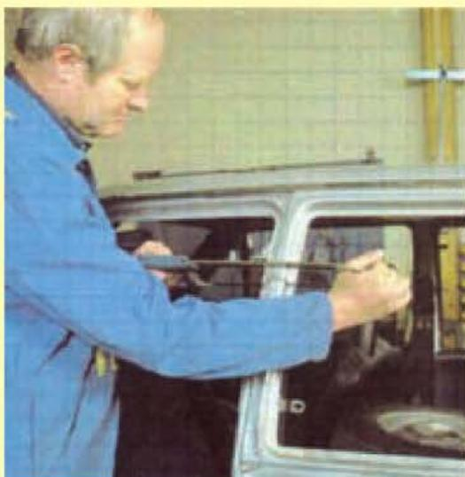
9.º Realizar el corte de la aleta por la línea marcada y retirar la sección de aleta que se quiere sustituir.
