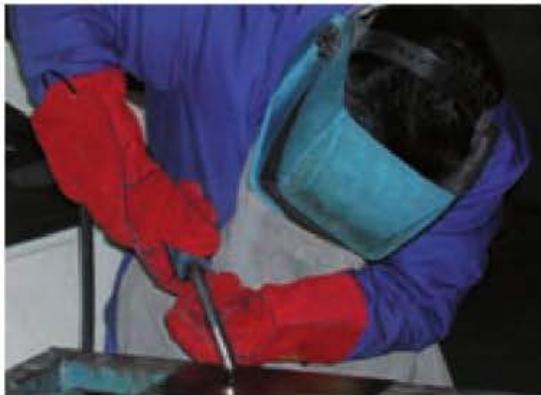
Figura 11.95. Posición correcta para soldar.
