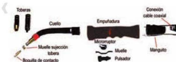
Figura 11.65. Elementos del soplete MIG/MAG.
