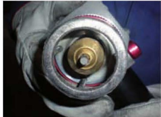
Figura 8.87. Vista del electrodo y anillo de tracción.
