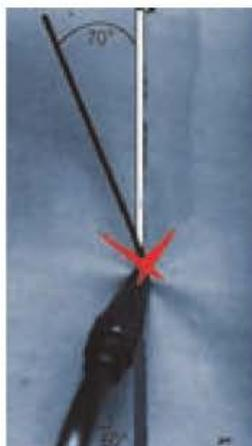
Figura 11.20. Soldadura ascendente.
