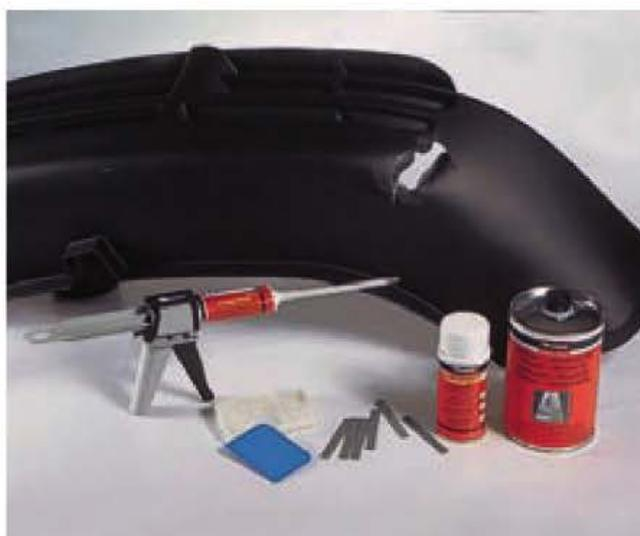
Figura 9.81. Rotura de paragolpes con desprendimiento de material junto con el equipo de reparación.
