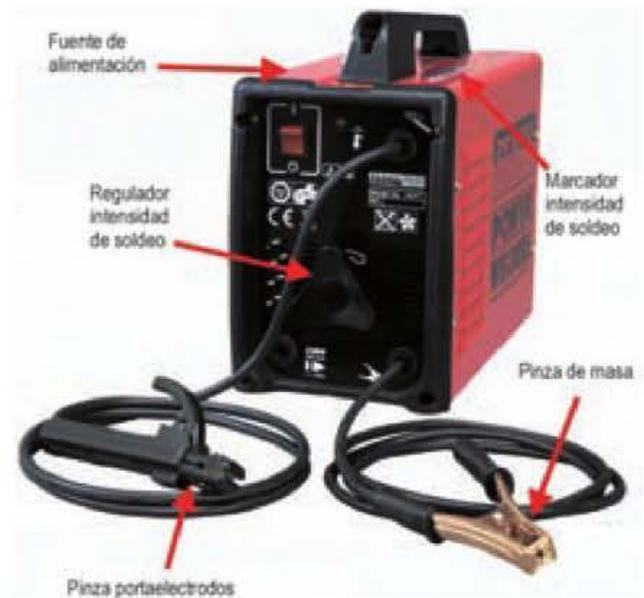
Figura 11.26. Elementos que componen el equipo de soldadura.
