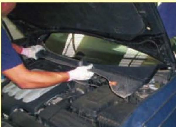
9. Desmontaje del protector exterior.
