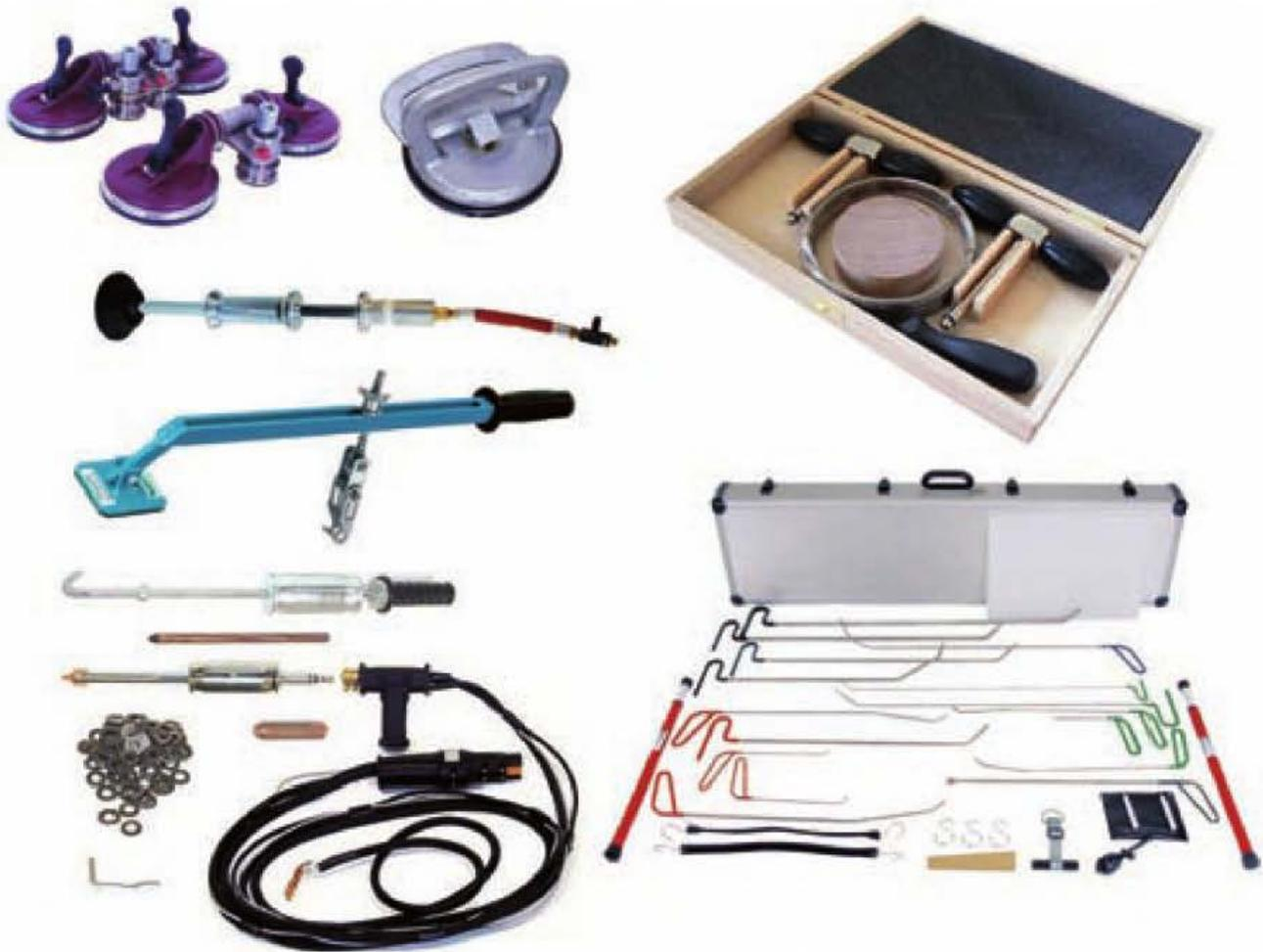
Figura 3.48. Útiles para los procesos de reparación de carrocerías.
