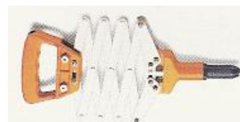
Eskuzko errematxagailua. Badago buru birakaria duen aldaera bat, muntaia zailtara iristea ahalbidetzen duena.
