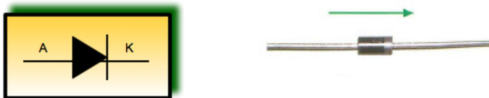
Cualquiera que sea su aplicación, siempre debe ir asociado con una resistencia limitadora, ya que en caso contrario, cuando son conductores la intensidad de corriente sería muy alta y podría destruirlos. A menudo, el propio circuito realiza esa función de limitación.
