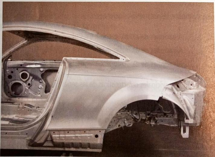
Aleta trasera del Audi TT, fabricada en aluminio
