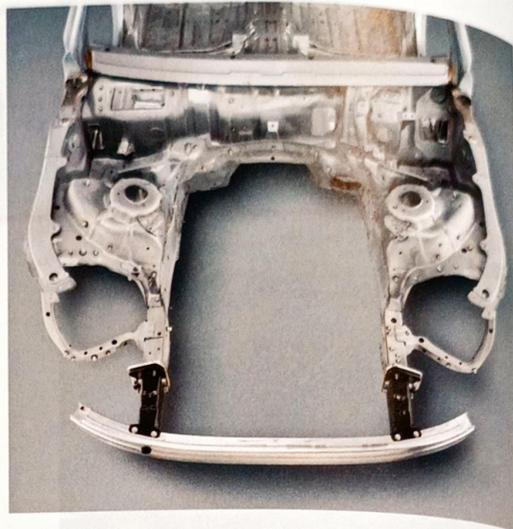
El automóvil actual es un conglomerado de materiales de la más diversa naturaleza, adaptados a diferentes necesidades y requisitos. Entre ellos, destacan el acero, el aluminio, el magnesio, los materiales plásticos y compuestos, etc. También puede encontrarse una mezcla de ellos para la fabricación de una misma pieza, dando lugar a elementos híbridos (por ejemplo, se construyen frentes híbridos de acero y poliamida)<sup>1</sup>.
