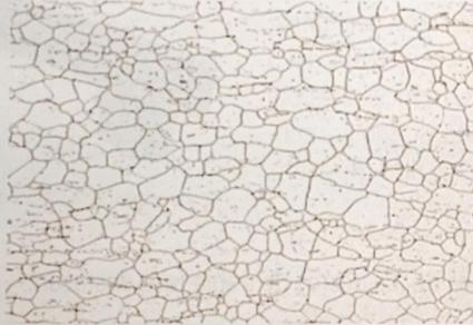
Microestructura del grado IS 220
