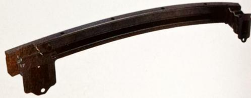
Travesía delantera fabricada en acero de doble fase
