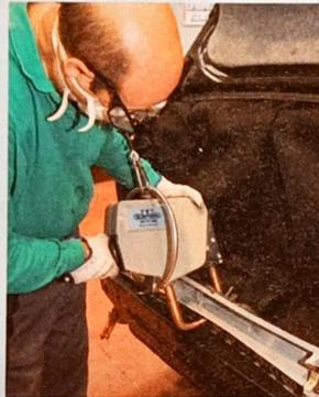
Soldadura por puntos de resistencia en acero ALE
