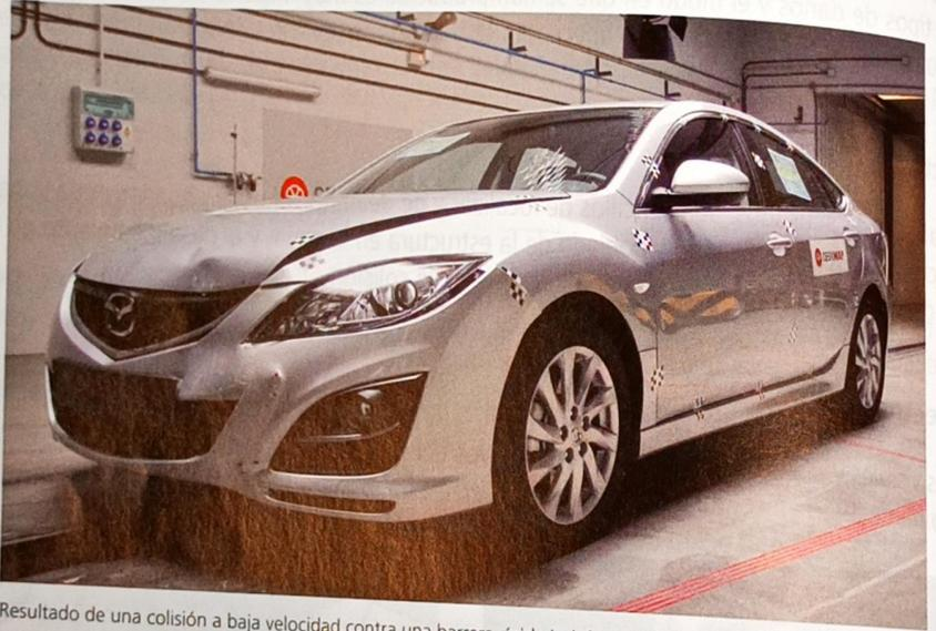
Resultado de una colisión a baja velocidad contra una barrera rígida indeformable
