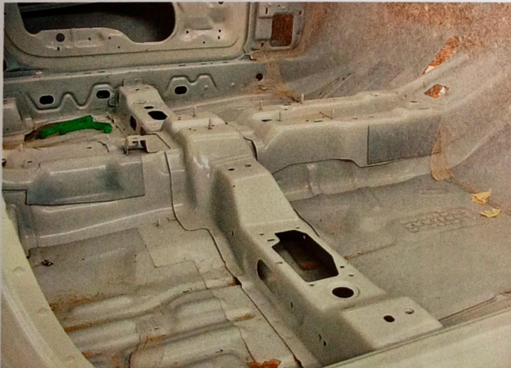
Túnel central y refuerzos transversales
