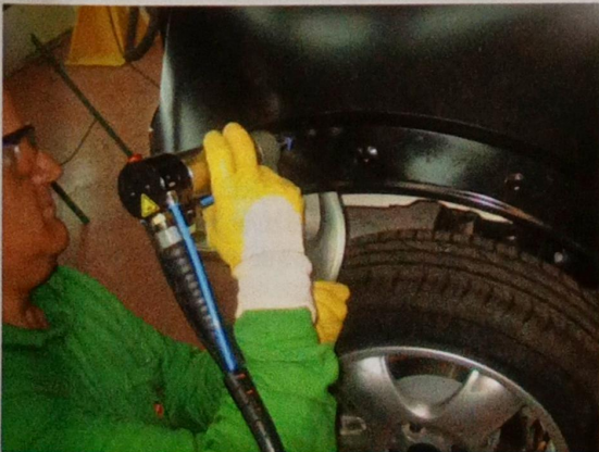
Aplicación de remaches en reparación
