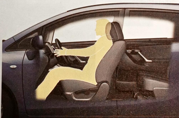
Funcionamiento del reposacabezas activo
