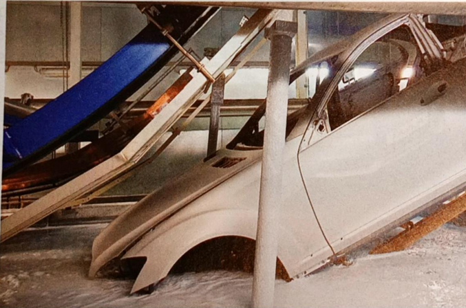
Inmersión de la carrocería en cuba de cataforesis
