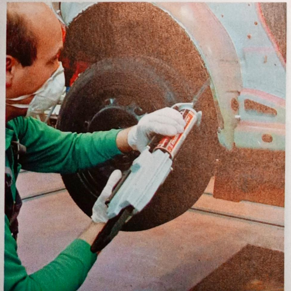
Aplicación de adhesivos estructurales
