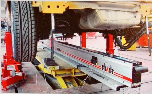
Disposición del medidor en la bancada
