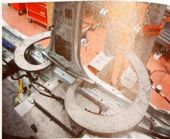
Para contrarrestar el efecto de las fuerzas de deformación, con el objetivo de corregir los daños de la estructura, se aplican sobre las carrocerías determinadas fuerzas de dirección similares a las que provocaron las deformaciones, pero de sentido contrario. Éste es el trabajo en bancada.
