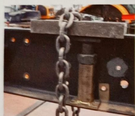
Protector para evitar marcas de la cadena y refuerzo interno
