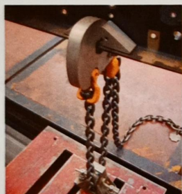
Útil para empujar hacia abajo el larguero, salvando la ballesta
