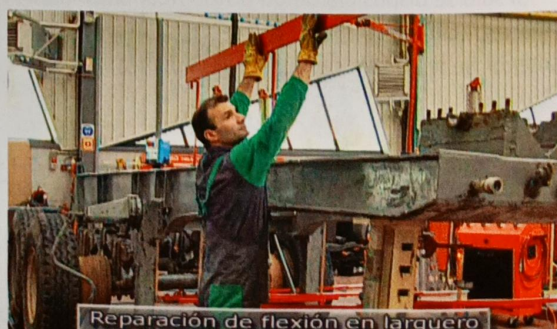
Reparación de flexión en larguero
