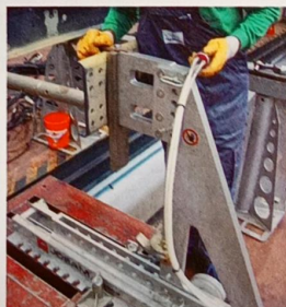
Protector de larguero para el empuje con torre
