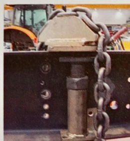
Refuerzo y interno y útil específico para el guiado de la cadena
