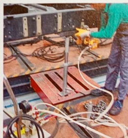
Empleo del protector del ala del larguero en un empuje con pistón
