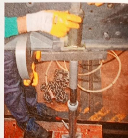
Protección del larguero mediante útil específico y refuerzo interno
