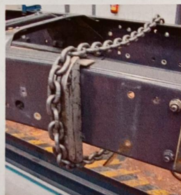
Protector para evitar marcas de la cadena
