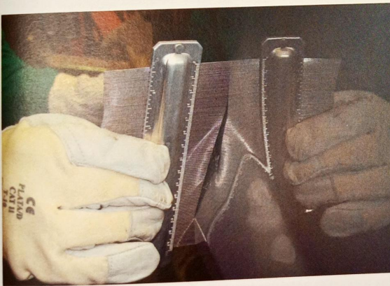
Comprobación de deformaciones con el peine de siluetas
