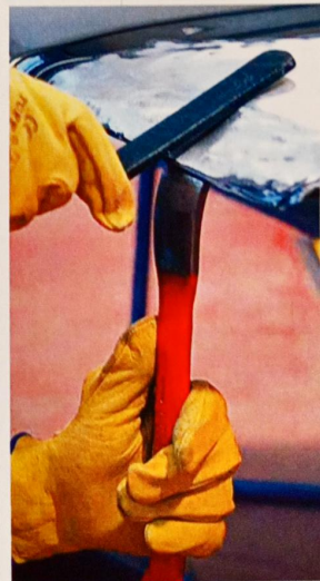
Repaso de chapa con una palanca en una zona de acceso limitado
