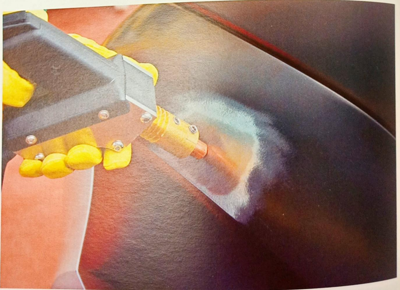
Recogida de chapa con electrodo de carbono
