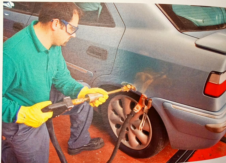
Aplicación del martillo de inercia
