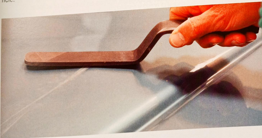
Suavizado de un panel con lima de repasar
