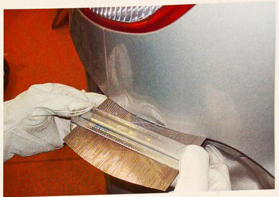
Comprobación de deformaciones con el peine de siluetas
