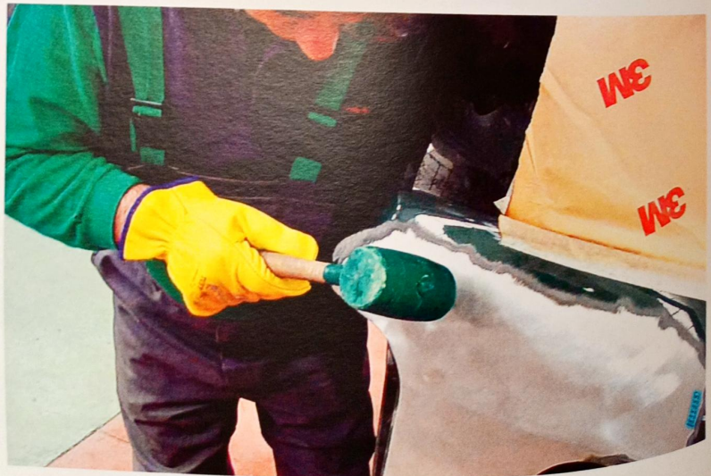
Alivio de tensiones con mazo de madera
