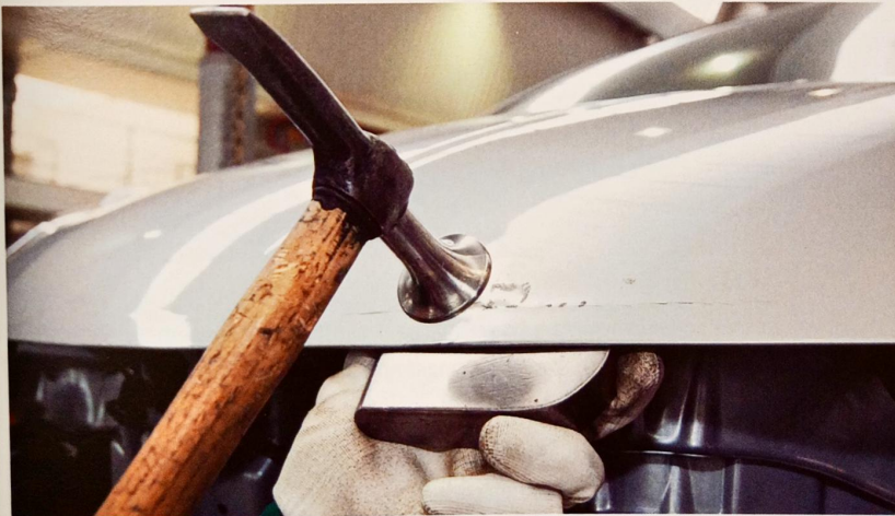
Empleo de un martillo de acabado en el repaso de un panel
