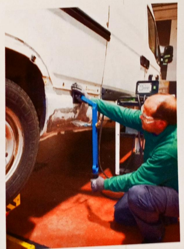
Reparación en zona sin acceso directo
