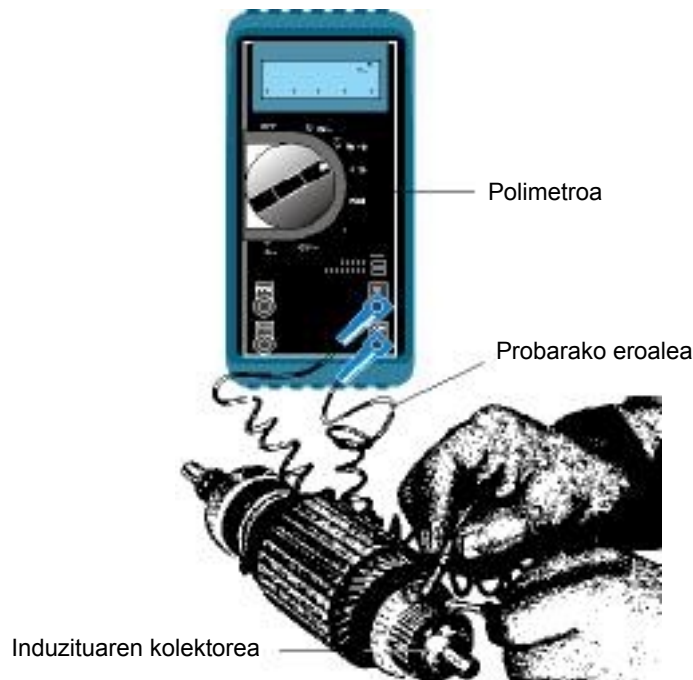
4.26. irudia. Indusituko jarraipen-proba, polimetro bidez.
