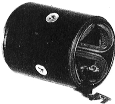
4.3. irudia. Karkasa, multzo induktorearekin.
