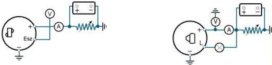
3.30-31. irudia. Alternadorera kontrol-lanpararik gabe konektatzea.
