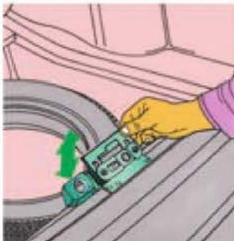
**Figura 6.90.** Ajuste del cierre del portón interponiendo suplementos.
