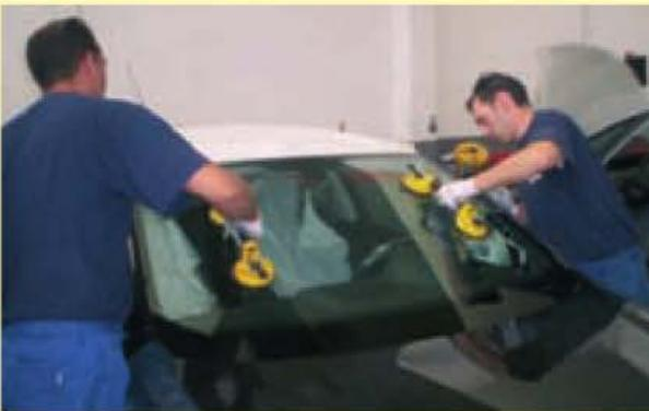
39. Fijación del parabrisas para que no se deslice sobre el cordón blando por su peso.
