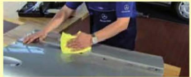
Si al realizar la tracción, la ventosa se desprende fácilmente y el adhesivo queda adherido a ella, puede ser síntoma de que la zona a desabollar tiene restos de grasa o cera en la pintura. Por el contrario, si el adhesivo se ha quedado adherido a la carrocería, puede ser síntoma de que la ventosa está sucia y con falta de adherencia.
