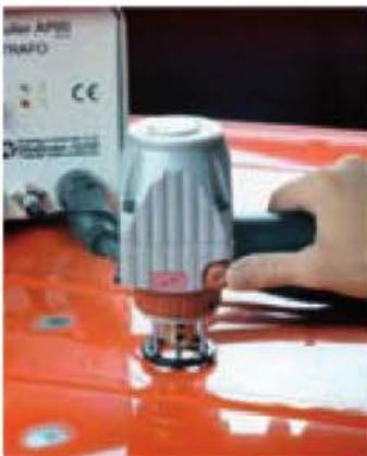
Figura 8.83. Desabollado de pequeños daños con pistola Airpuller.
