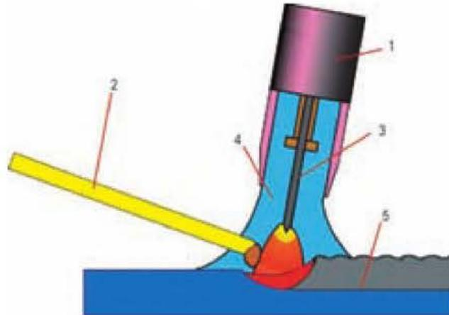
**11.27.** Anota los nombres de los elementos del equipo de soldadura TIG de la siguiente figura:
