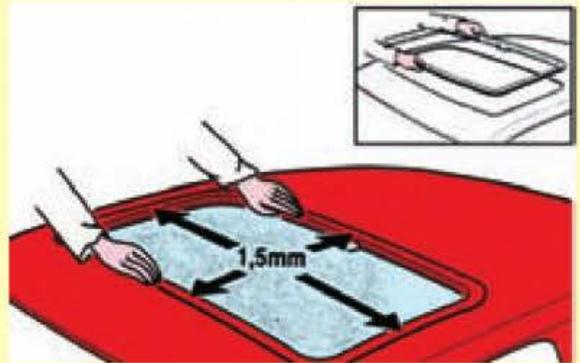
Imprimir convenientemente el borde de corte, para evitar la oxidación de la chapa.
