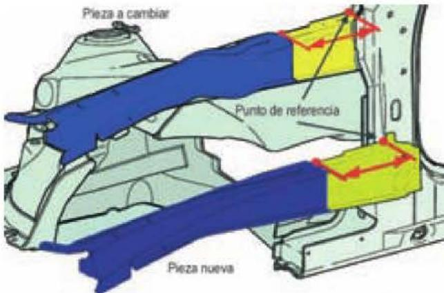
Figura 12.56. Marcaje de la línea de corte de la pieza a cambiar y la nueva partiendo del mismo punto de referencia.
