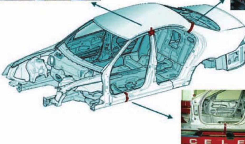
Figura 12.55. Utilización de plantillas para establecer las líneas de corte
