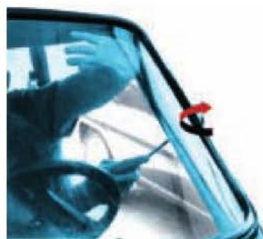
Figura 7.30. Desalajo de la goma de contorno sobre el marco de la carrocería.
