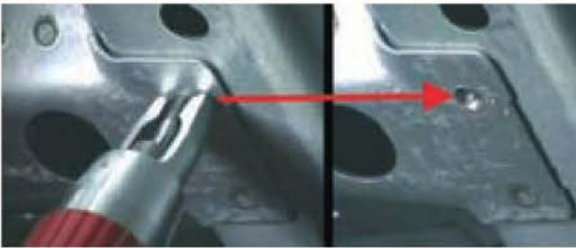
Figura 12.29. Acceso a solo un lado de la unión.
