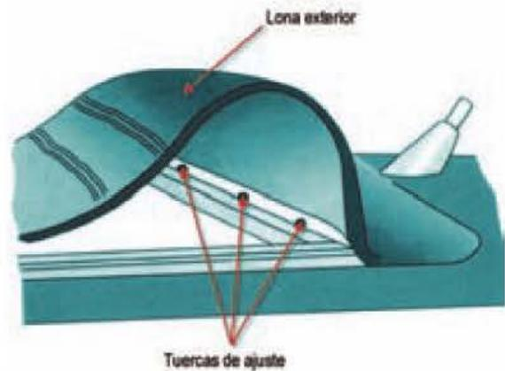
Figura 6.144. Tensado de la lona.
