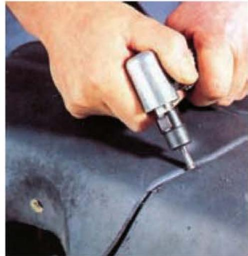
Figura 9.91. Realización de una ranura en «v» con una fresa de 90°.
