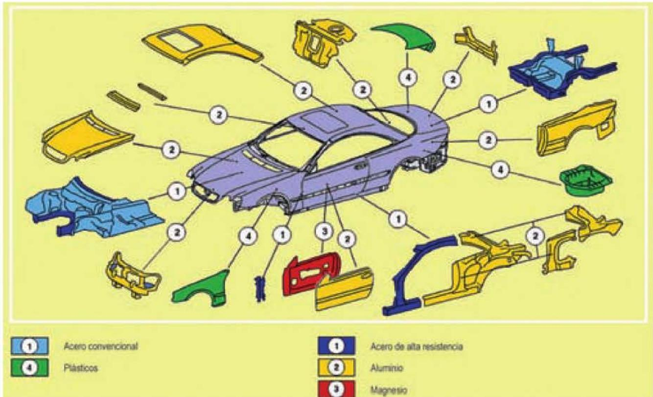
Figura 8.4. Ejemplo de materiales empleados en la fabricación de una carrocería Mercedes Benz.
