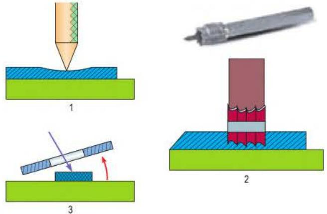
Figura 12.21. Proceso de despuntado con fresa.
