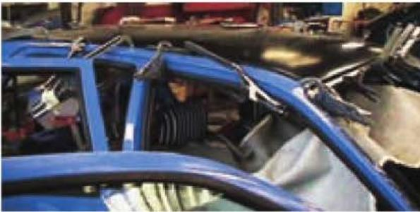
Figura 10.13. Sujeción del techo con mordazas de presión.
