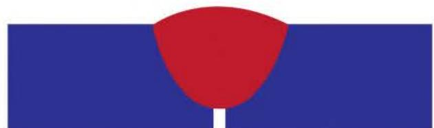
Figura 11.23. Falta de penetración.
