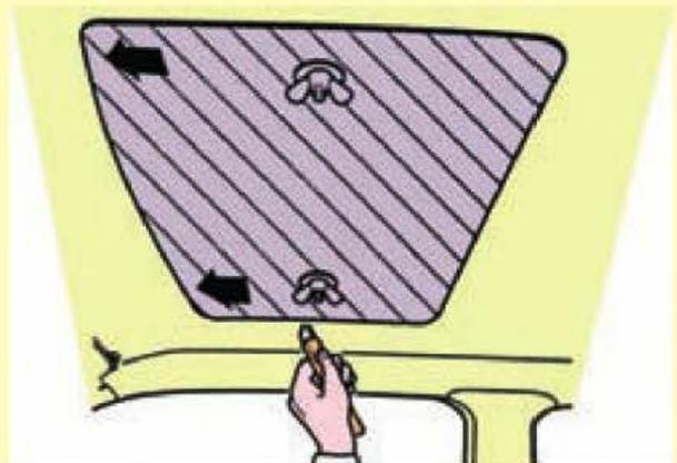
Si aparece una travesía de techo en el área de montaje, proceder a su desmontaje (en caso de ensamblaje atornillado). En caso de fijarse mediante soldadura, habrá que cortarla en un ángulo de  $45^\circ$ , durante la operación de recorte de la chapa del techo.
