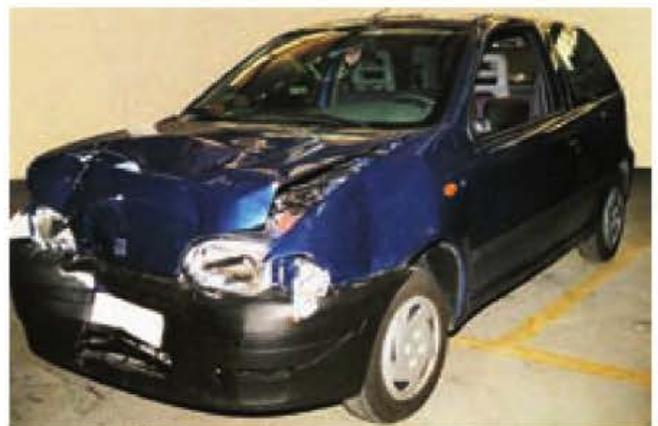
Figura 8.30. Vehículo con deformación estructural también fuera de la zona de impacto.
