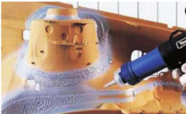
Figura 10.26. Sellado por pulverización.
