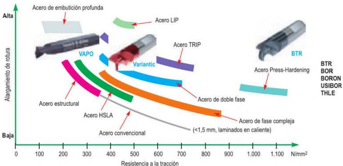
Figura 12.31. Tipos de aceros de fabricación de las carrocerías y broca a utilizar.
