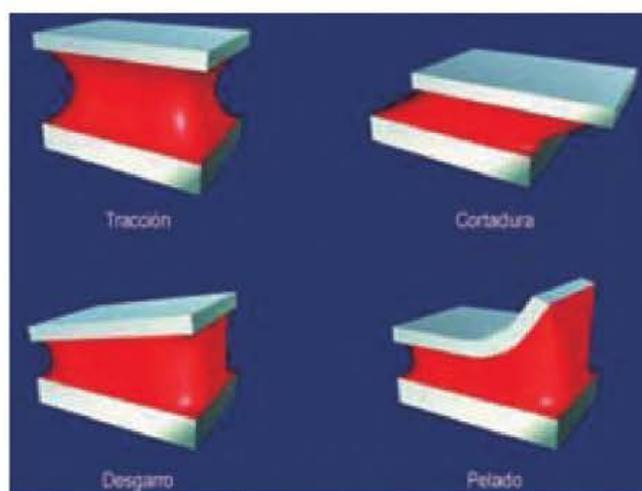
Figura 10.41. Distintos requerimientos de las uniones adhesivas.
