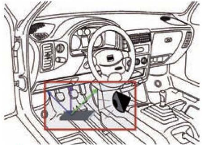
Figura 6.159. Utilización de un espejo para visión indirecta en lugares de difícil acceso.
