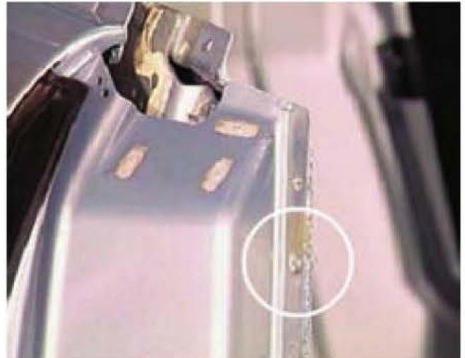
Figura 10.55. Unión remachada y pegada.
