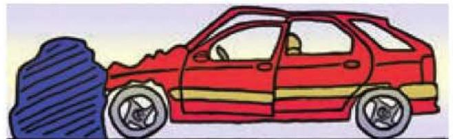
Figura 8.29. La deformación del techo se ha producido por la transmisión de fuerzas a través de la estructura, a causa del golpe en la parte frontal y de la inercia del resto de vehículo.
