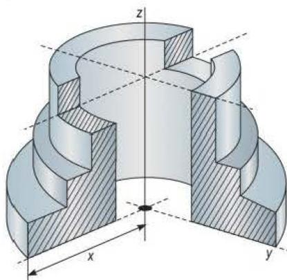
Figura 1.3. Dibujo técnico de una pieza en perspectiva, seccionada.
