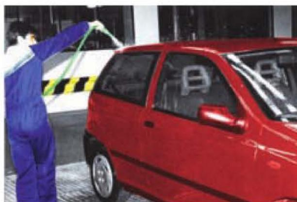
Figura 6.155. Rociado con agua para buscar filtraciones.
