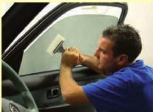
Figura 7.13. Eliminación de burbujas residuales.
