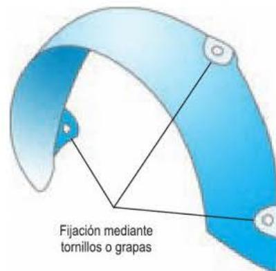
Figura 6.103. Revestimiento interior del pase de ruedas.
