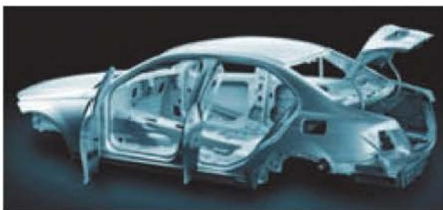
Figura 6.1. Carrocería completa.
