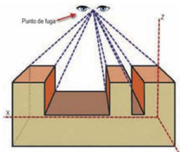
Figura 1.46. Representación de una pieza mediante perspectiva cónica.
