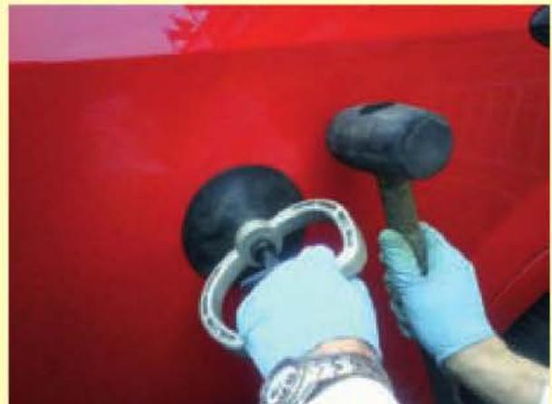
Figura 2. Tirar de la ventosa a la vez que se golpean, con un mazo de goma, las costillas de la superficie dañada para liberar tensiones en la chapa.
