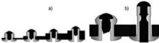
Figura 5.70. Uso de los remaches de tracción.
