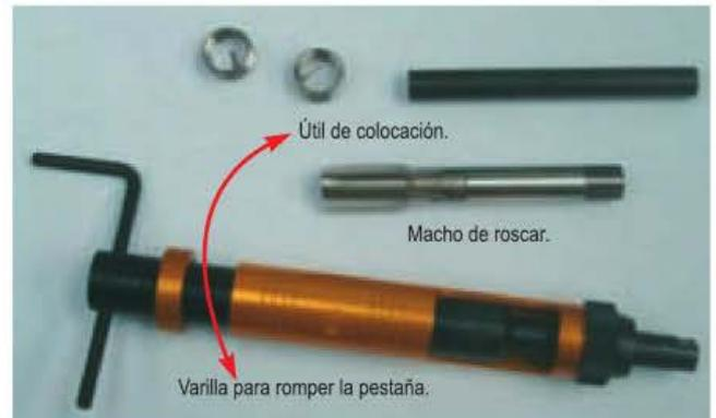
Figura 5.51. Equipo para el montaje de roscas insertadas.
