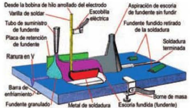
Figura 11.130. Soldadura por arco sumergido.
