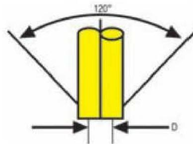
Figura 11.142. Dimensión punta electrodo troncocónico.
