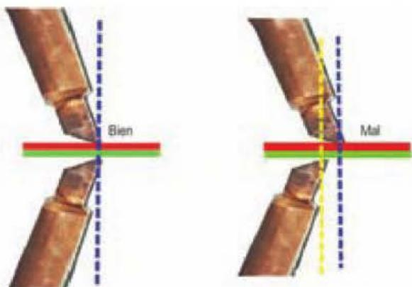
Figura 11.144. Alineación de los electrodos.
