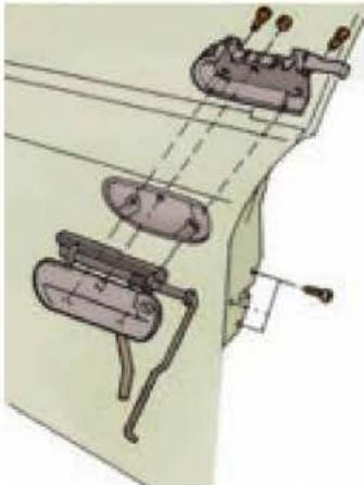
Figura 6.36. Desmontaje de una manilla exterior.
