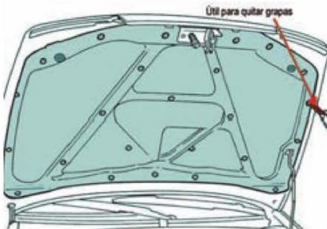
**Figura 6.67.** Desmontaje del guarnecido insonorizante del capó.
