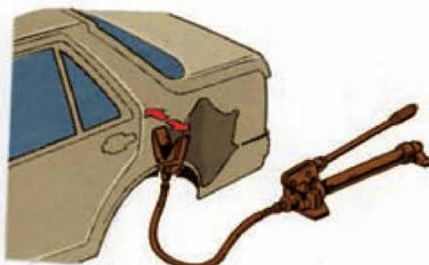
Abolladura donde se requiere equipo hidráulico para expandir la chapa
