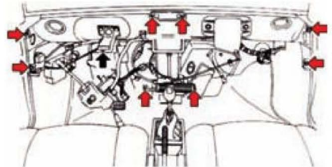
**Figura 6.166.** Fijaciones del panel de instrumentos a la carrocería.
