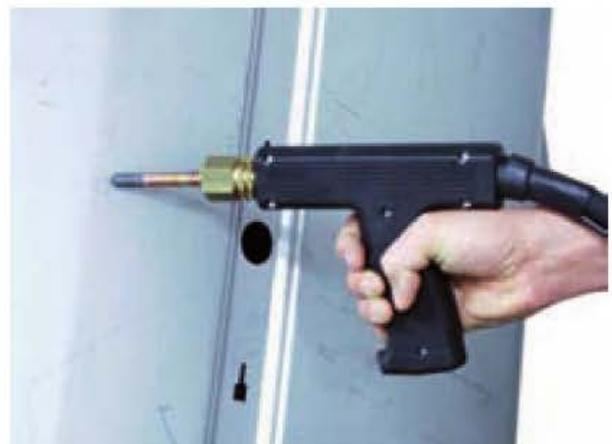
Figura 8.64. Aplicación del electrodo de carbón.
