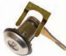
Figura 6.34. Fijación del bombín a la puerta.
