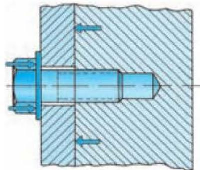
**Figura 5.5. Ensamblaje atornillado mediante tornillo con cabeza y la pieza.**
