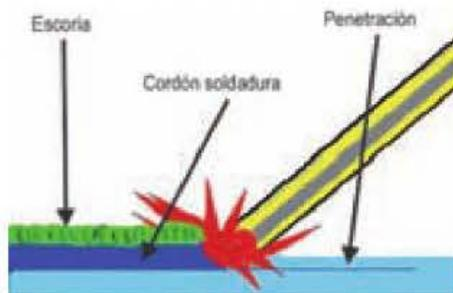
Figura 11.25. Composición del cordón de soldadura.
