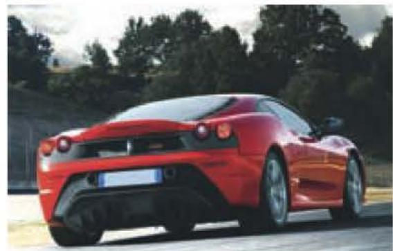
Figura 8.7. Vehículos con elementos exteriores de la carrocería fabricados en materiales sintéticos.
