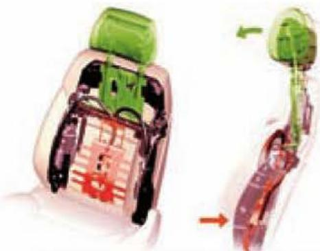
Figura 6.177. Configuración del respaldo y reposacabezas del asiento.
