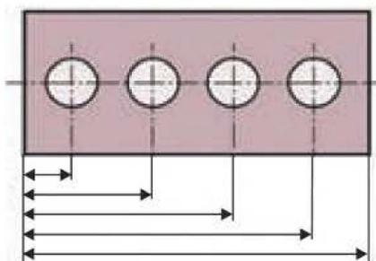
Figura 1.24. Cuando varias cotas de la misma dirección tienen un elemento de referencia común, se acotan con líneas paralelas comenzando por la menor.
