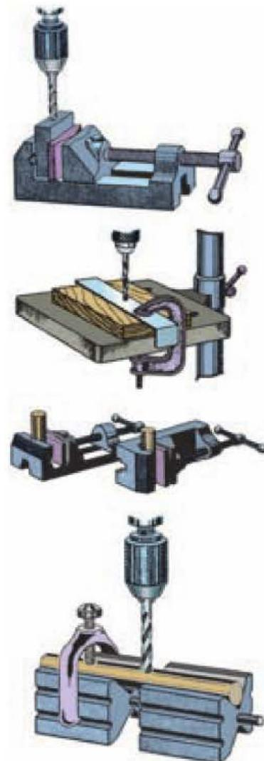
Figura 2.73. Sujeción correcta de piezas.
