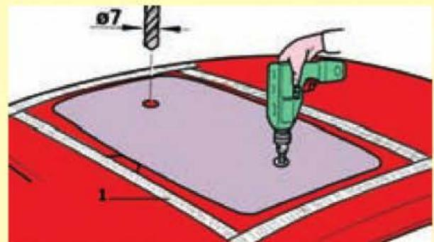
Colocar la plantilla interior y marcar con un rotulador el contorno de la misma sobre el revestimiento de techo. A continuación, recortar el revestimiento utilizando un cúter o cualquier otra herramienta similar. Seguidamente, desmontar la plantilla extrayendo los tornillos de fijación.
