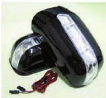
Figura 6.41. Espejo retrovisor con intermitente incorporado.
