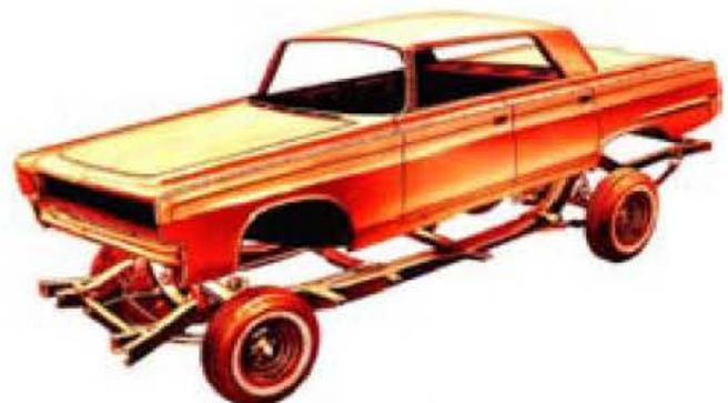
**Figura 4.4.** Constitución de un vehículo con bastidor de acero.
