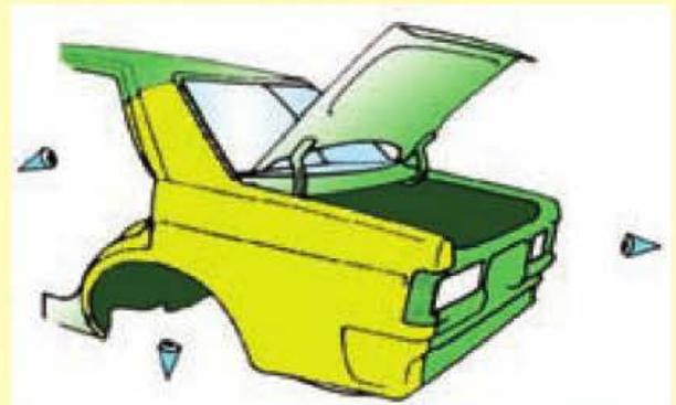
En muchas ocasiones para posicionar correctamente la nueva pieza es indispensable utilizar útiles de posicionamiento.
