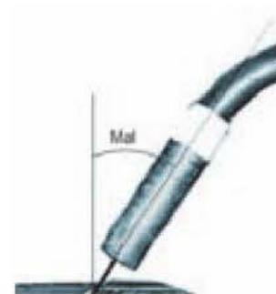
Figura 11.98. Posición incorrecta para soldar.
