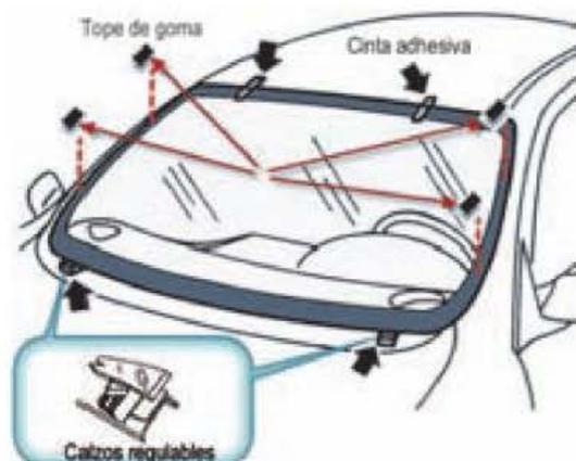
Figura 7.70. Colocación preliminar del parabrisas.
