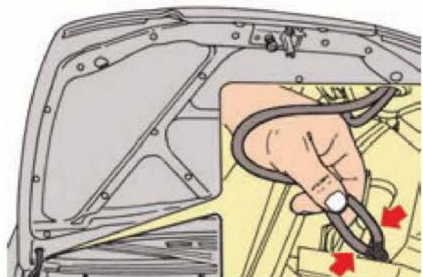
**Figura 6.63.** Desconexión de los difusores del lavaparabrisas.
