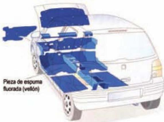
Figura 6.208. Revestimientos de espuma fluorada.
