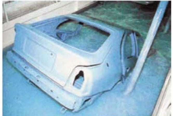
Figura 10.18. Electroimprimación por inmersión cataforésica.
