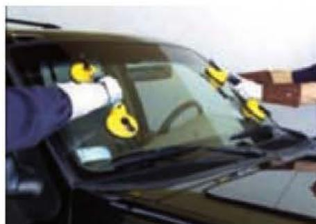
Figura 7.29. Sujeción de la luna con ventosas.
