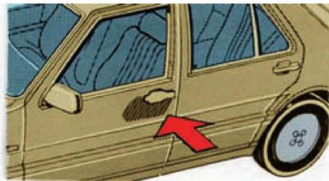
Abolladura en puerta cerca de la cerradura. Requiere empleo de hojas perfiladas para la reconstrucción
