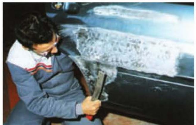
Figura 8.37. Repaso con la espátula para eliminar tensiones.
