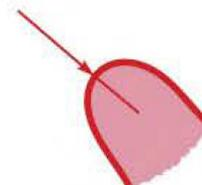
Figura 1.27. Los arcos de pequeño radio se acotarán dejando fuera la cota con la flecha en la dirección del centro del arco.
