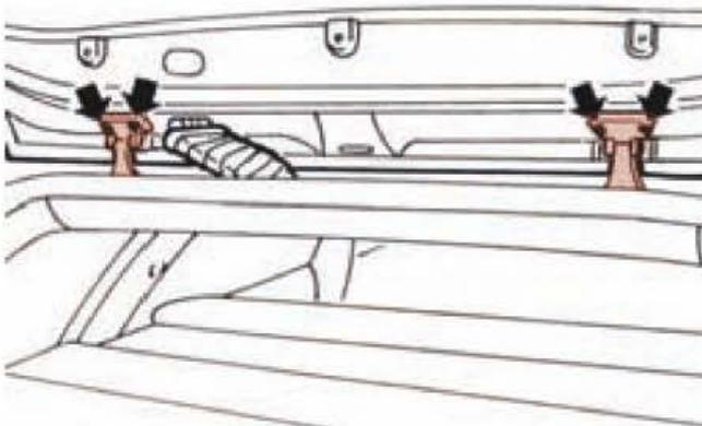
Figura 6.81. Desmontaje de las bisagras del portón.
