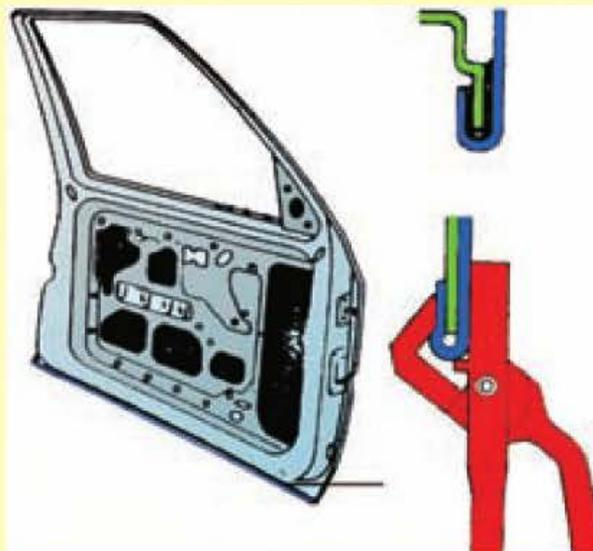
• Una vez realizado el pliegue, aplicar masilla selladora a lo largo del pliegue y los protectores cerosos a través del hueco de la puerta.
