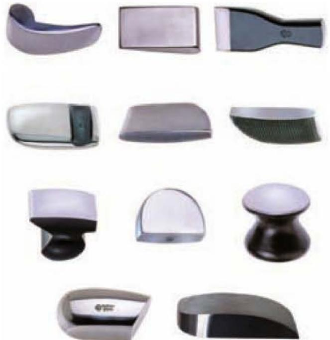
Figura 8.14. Distintos tipos de tases. Nombre de los tases de la figura, de izquierda a derecha y de arriba abajo: coma, cuña, trancha corta, dactilado, dactilado de recoger, de raíl, de tacón, de tampón o diábolo, dactilado redondeado, de cuña alomada.
