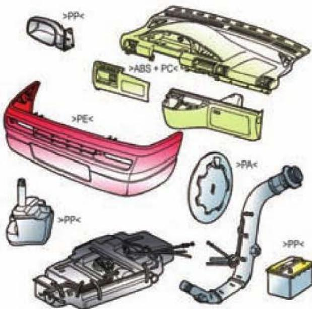
Figura 9.4. Elementos plásticos del automóvil.
