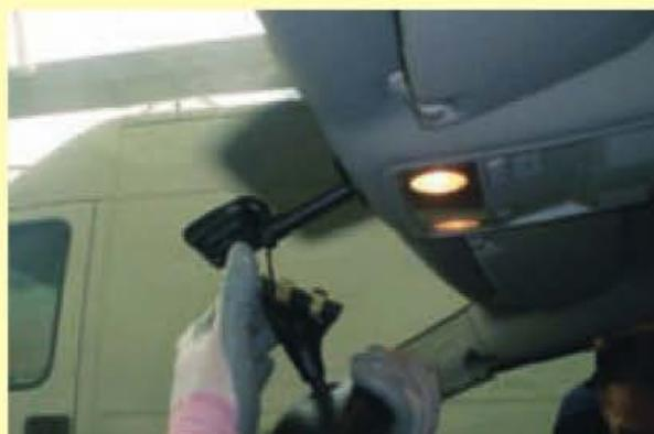
11. Desmontaje de la fijación del guarnecido del pilar.
