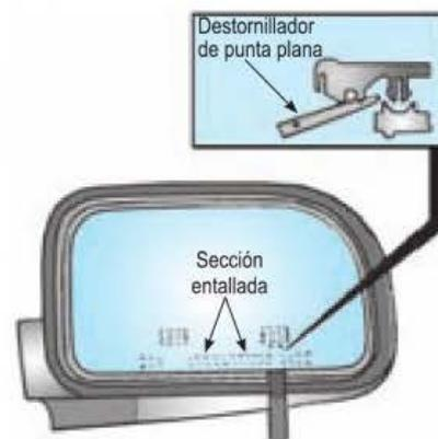
Figura 6.43. Sustitución de la placa del espejo.
