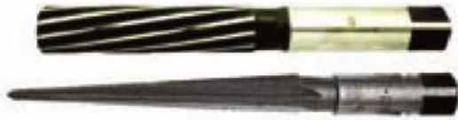
Figura 2.79. Escariador cilíndrico y cónico.
