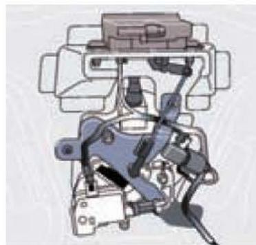
Figura 6.30. Conjunto de palancas y varillaje de una cerradura.
