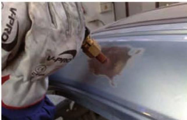
Figura 8.40.a. Aplicación de calor con el electrodo de cobre.
