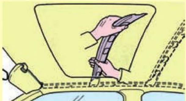
Utilizando una herramienta de corte apropiada (sierra de calar, roedora, cizalla, etc.), recortar el contorno de la plantilla exterior del techo. En caso necesario, retocar con una lima el borde del corte realizado. Al acabar esta operación, es recomendable limpiar el vehículo de los restos de metal, generados durante el corte.
