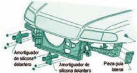
Figura 6.114. Amortiguadores de impacto montados como soporte del paragolpes.
