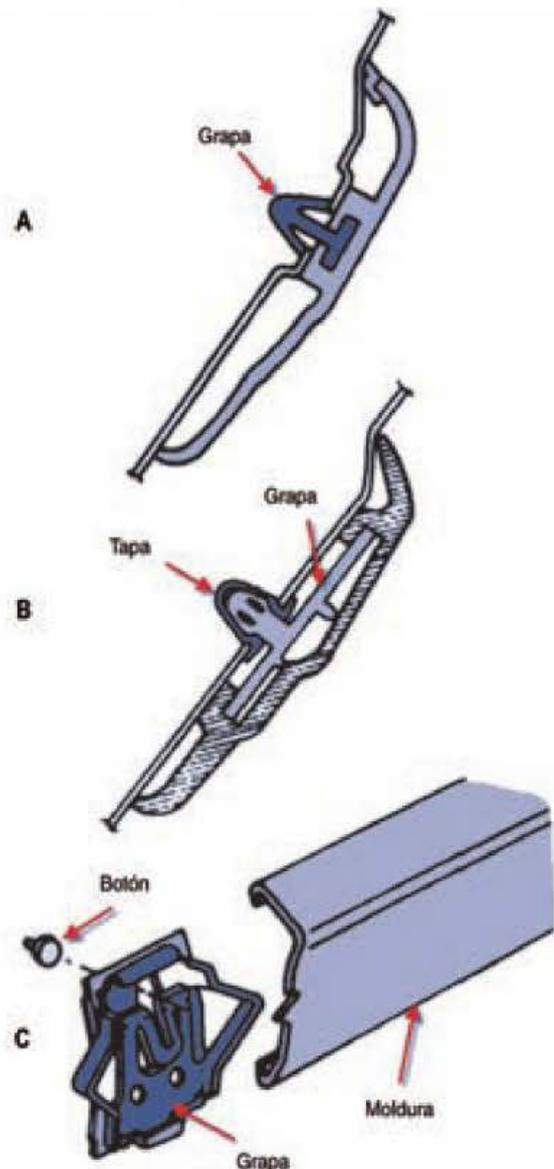
Figura 6.209. Grapas de fijación de molduras.
