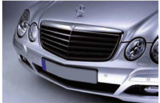
Figura 9.17. Rejilla fabricada en ABS.
