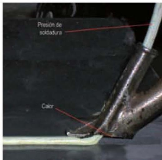
Figura 9.88. Posición de soldadura.
