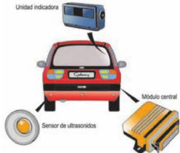
Figura 6.125. Elementos del sistema de aparcamiento.
