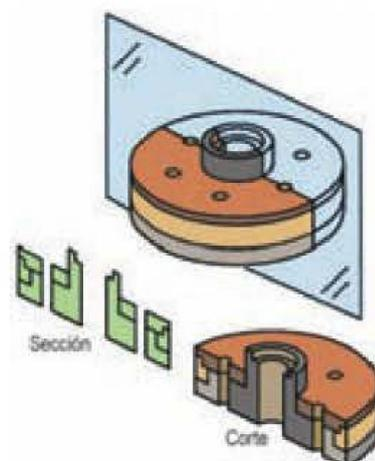
Figura 1.48. Diferencia entre corte y sección.
