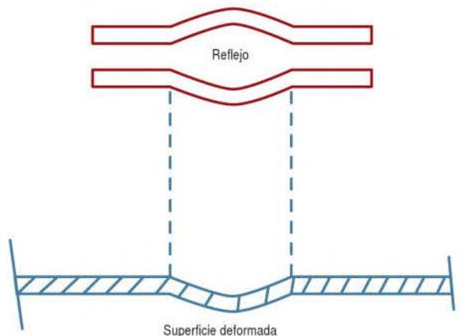
Figura 8.98. Una superficie deformada hacia el interior del vehículo proyectará un reflejo de dos líneas que aumenta su divergencia en el punto más bajo de la deformación. El reflejo será del tipo que aparece en la figura.
