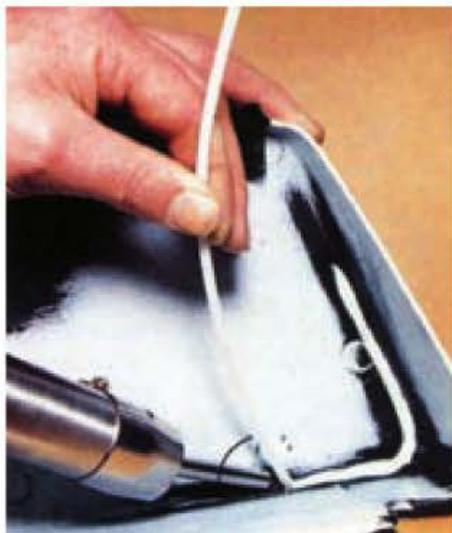
Figura 9.94. Soldadura pendular.
