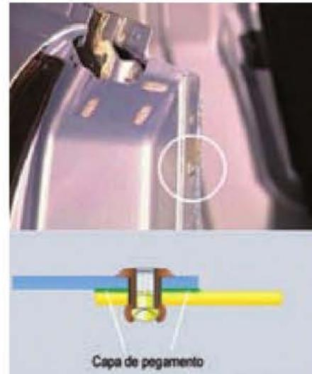
Figura 5.72. Unión remachada y pegada.
