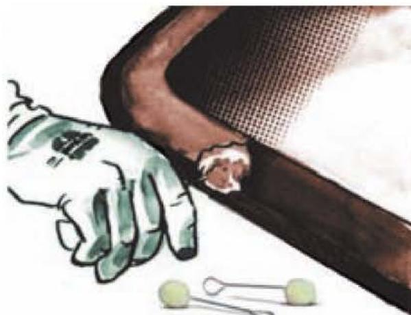
Figura 7.90. Aplicación de imprimación sobre una luna con perfil de extrusión.
