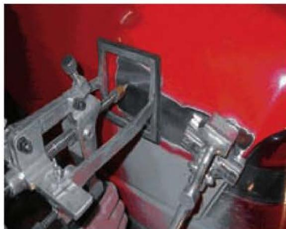
Figura 8.73. Retracción de una abolladura mediante la soldadura de un electrodo y sistema de palancas.
