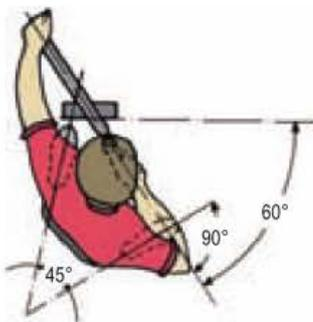
Figura 2.46. Posición adecuada para el limado.
