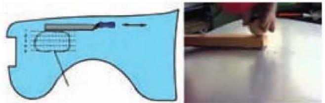
Figura 8.26. Esquema de utilización de la lima como control de la reparación.
