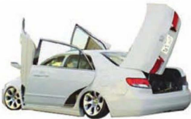
**Figura 6.221.** Modificaciones en los sistemas de apertura de elementos amovibles.
