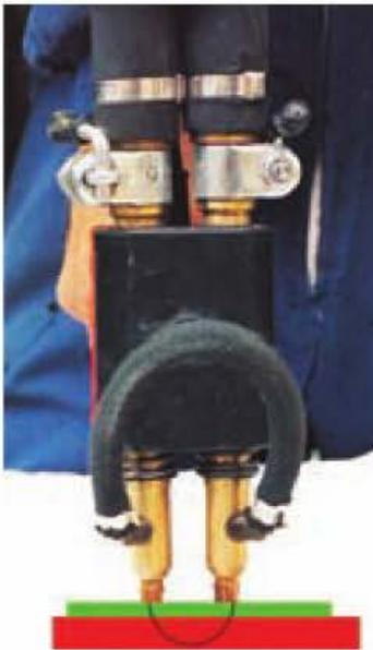
Figura 11.155. Soldadura con doble punto.
