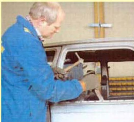
8.º Utilizando una sierra manual o neumática, cortar la parte exterior del montante de la puerta. Téngase en cuenta que los montantes suelen tener refuerzos interiores que no deben ser cortados.
