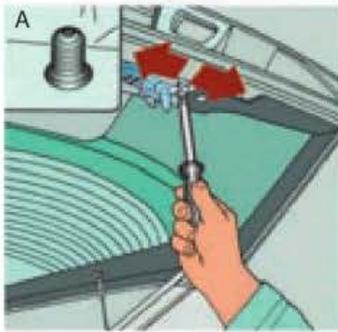
**Figura 6.89.** Ajuste del cierre del portón moviendo la cerradura.
