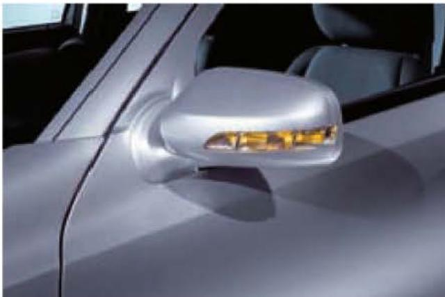
Figura 9.24. Espejo retrovisor fabricado en poliamida.
