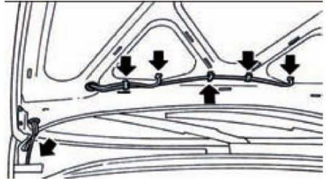
**Figura 6.68.** Extracción de las tuberías de agua de los difusores.
