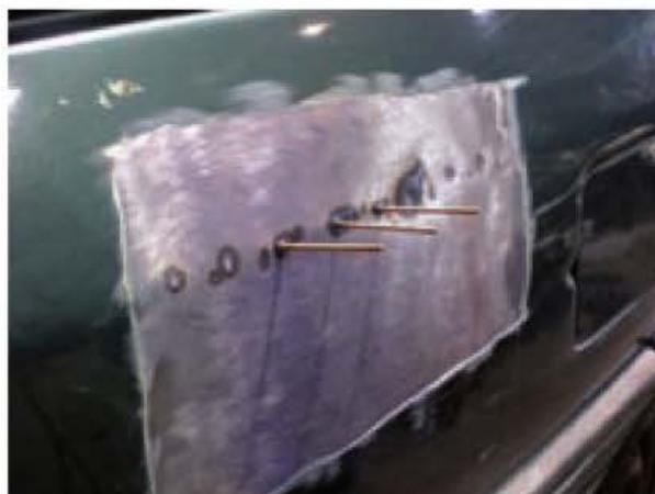
Figura 8.49. Clavos de tracción soldados.
