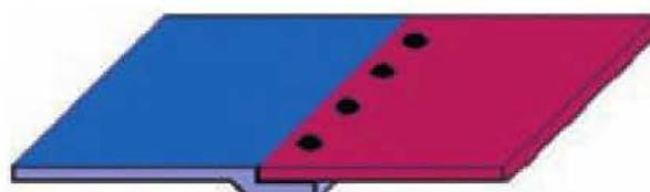
Figura 10.2. Unión a solape escalonado.
