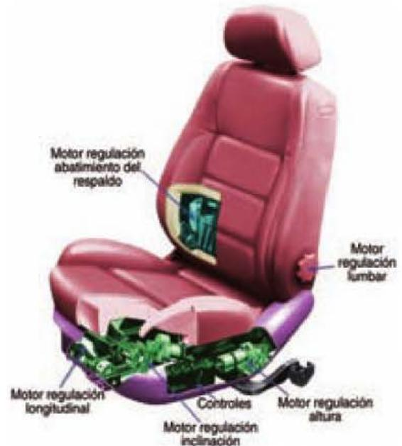
Figura 6.180. Ubicación de los motores de regulación del movimiento del asiento.
