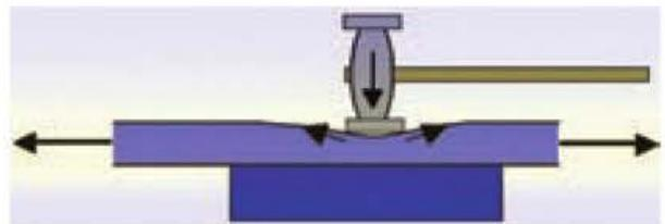
Figura 8.36. Estirado de la chapa provocado por excesivos golpes.
