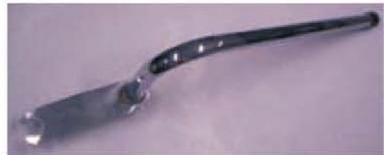
**Figura 6.56.** Útil especial para el alineado de la puerta.
