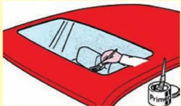
Colocar la junta de estanqueidad (apropiada a cada caso), sobre el marco exterior. En el caso de utilizar espuma adhesiva de poliuretano, la unión de los extremos cortados ha de realizarse a solape.
