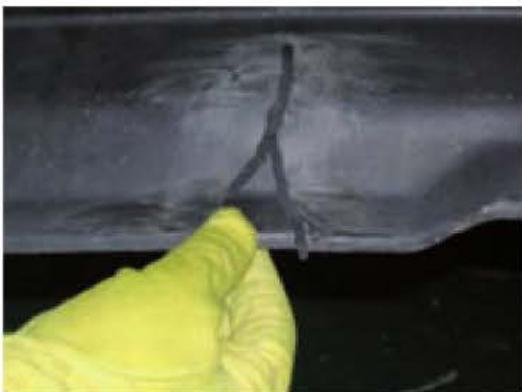
Figura 9.90. Recorte de material para proceder al relleno de la reparación.
