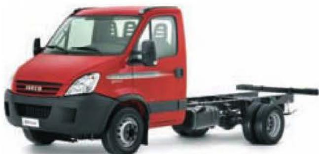
Figura 4.36. Vehículo industrial tipo «chasis-cabina mediano».
