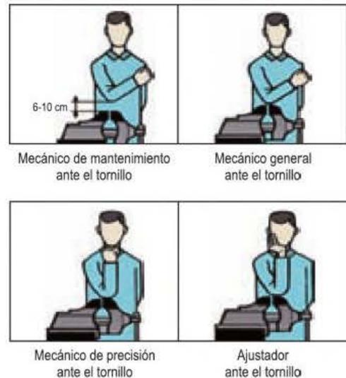
Figura 2.43. Altura del puesto de trabajo.
