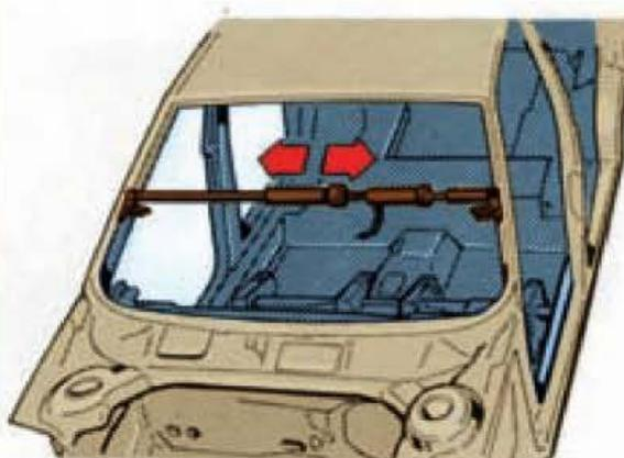
Abolladura en montantes laterales y travesaño superior del parabrisas. Requiere la aplicación del equipo hidráulico
