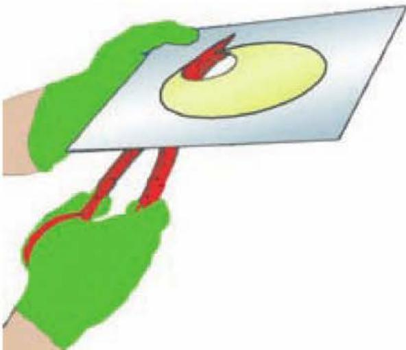
Figura 12.7. Corte curvo con cizalla manual.
