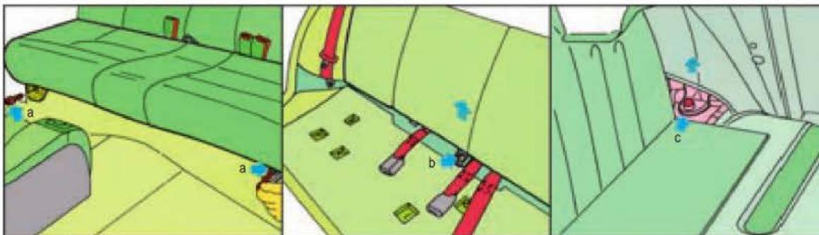
Figura 6.182. Desmontaje de un asiento trasero de una pieza.
