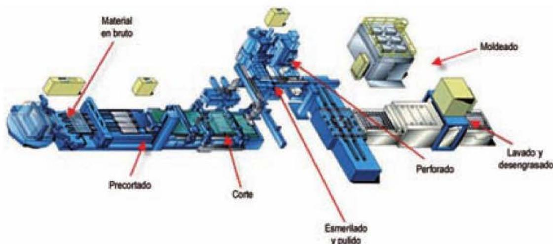
Figura 7.19. Fabricación del vidrio laminado. Corte y moldeo.
