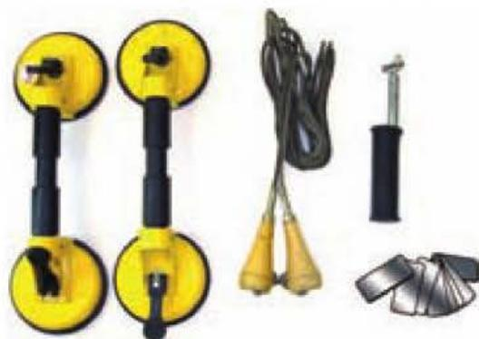
Figura 7.34. Útiles para el montaje de lunas calzadas.
