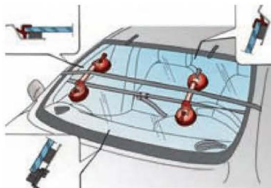
Figura 7.88. Equipo de correas y ventosas para fijar la luna mientras cura el adhesivo.
