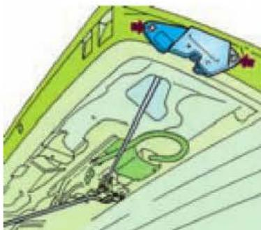
Figura 6.84. Varillaje de reenvío.
