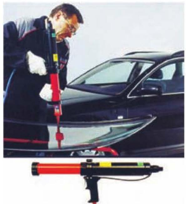
Figura 10.49. Aplicador monocomponente neumático.
