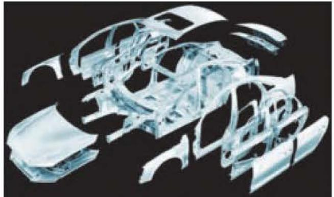
Figura 6.2. Elementos exteriores de una carrocería.
