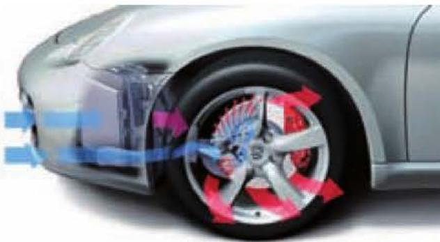
**Figura 6.218.** Corriente de aire para ventilar los frenos delanteros.
