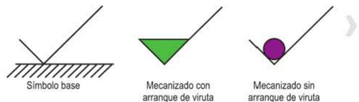
Figura 1.55. Simbología para el mecanizado.
