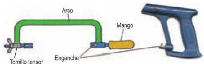
Figura 2.23. Partes del arco de sierra.
