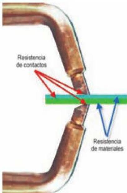
Figura 11.133. Resistencias en un punto de soldadura.
