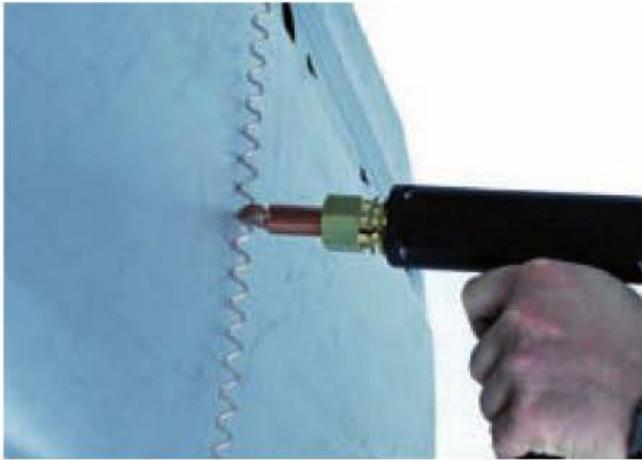
Figura 8.76. Soldadura de un útil específico de tracción.
