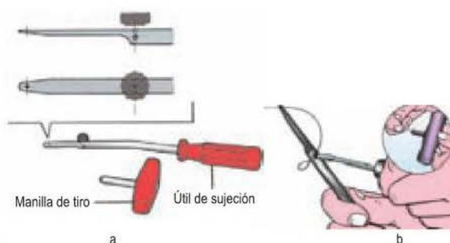
Figura 7.54. Fijación del alambre acerado en el extremo de la manilla de tiro y en el útil de sujeción.
