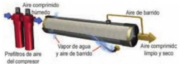
Figura 3.23. Secador de membrana.
