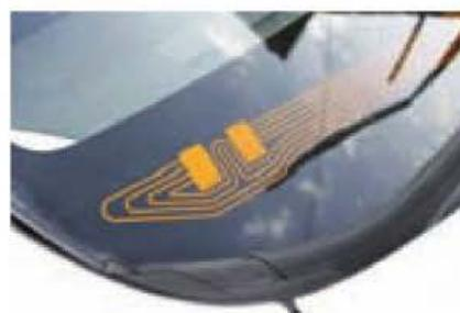
Figura 7.11. Circuito impreso de antena serigrafiado sobre el vidrio.
