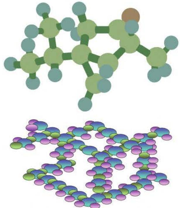
Figura 9.25 A y B. Red de malla cerrada de los termoestables.
