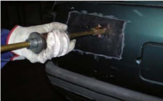
**Figura 8.51.** Soldadura de una estrella mediante el martillo de inercia.
