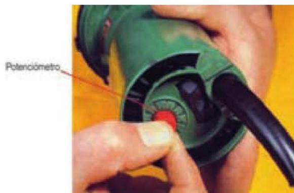
Figura 9.83. Potenciómetro para la regulación de la temperatura.
