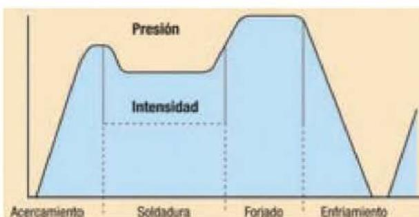
Figura 11.135. Secuencia de la soldadura por resistencia.
