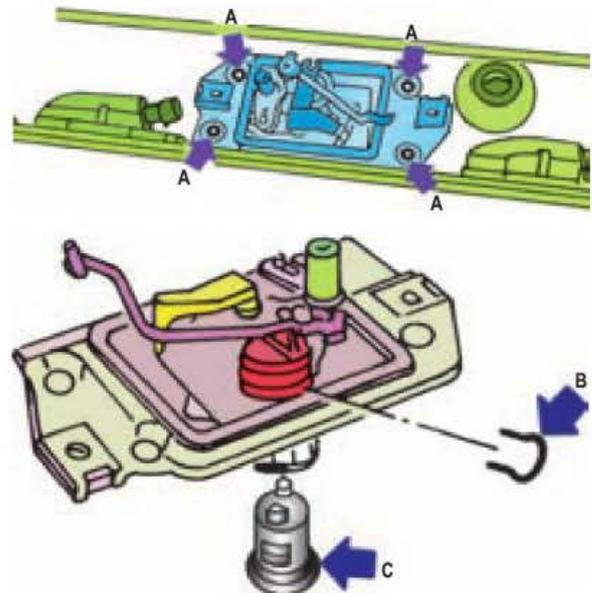
Figura 6.85. Desmontaje de la cerradura del portón y del bombín.
