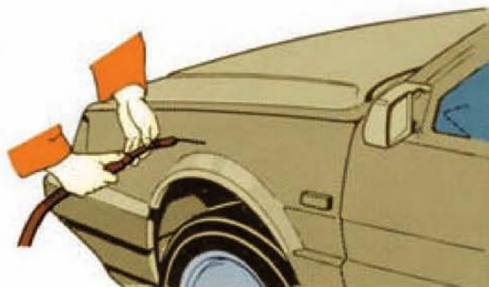
Corte en la aleta. Requiere el enderezado y la unión de los bordes mediante equipo de soldadura
