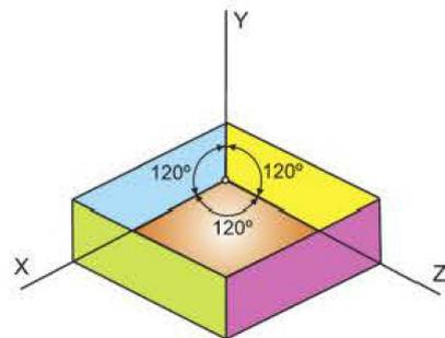
Figura 1.35. Ejes de la perspectiva axonométrica isométrica.
