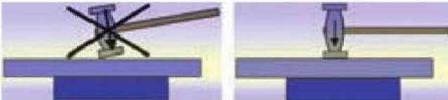
Figura 8.12. Forma de asentar el martillo sobre la chapa: Izquierda incorrecta. Derecha correcta.
