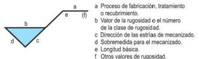
Figura 1.56. Forma de colocar las especificaciones del estado superficial.
