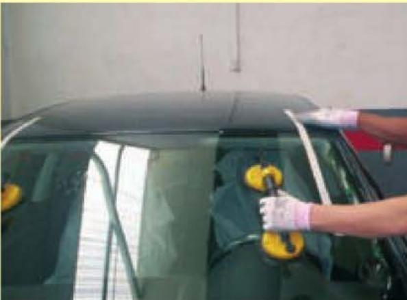
40. Reposición de los accesorios, revestimiento del pilar.
