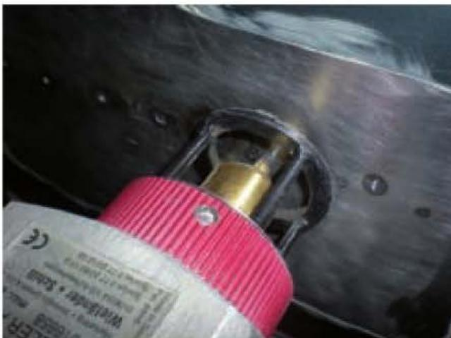
Figura 8.84. Cuando se suelda el electrodo, el anillo de tracción se desplaza contra la superficie para restaurar la chapa a su posición original.
