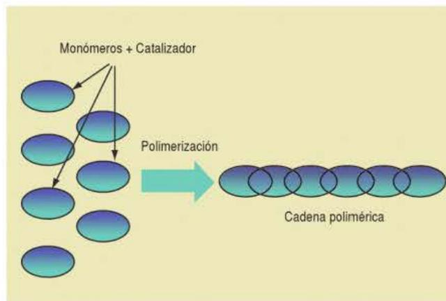
Figura 9.8. Proceso de polimerización.
