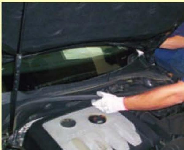
8. Desmontaje de la tapa del torpedó.
