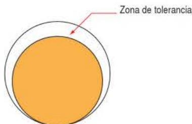
Figura 1.70. Tolerancias. Zona de tolerancia.
