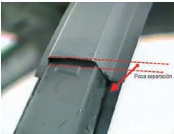
Figura 12.59. Tener cuidado con el espacio entre elementos antes de cortar.
