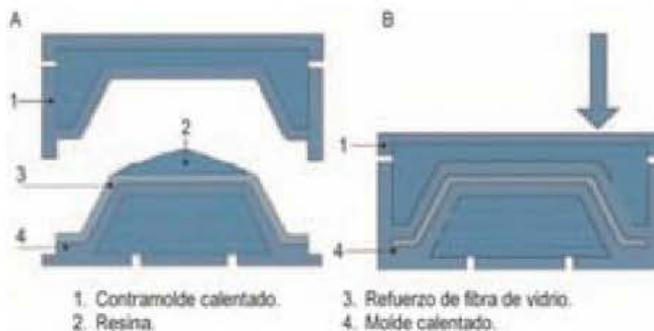
Figura 9.53. Proceso de fabricación por presión en caliente.
