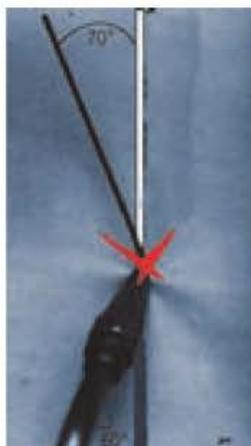
Figura 11.20. Soldadura ascendente.
