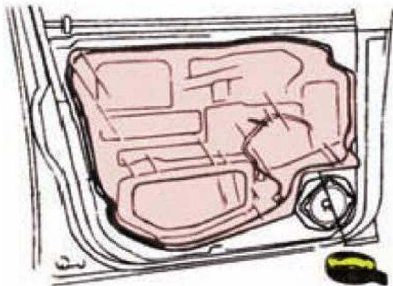
Figura 6.51. Montaje de la lámina impermeabilizante.
