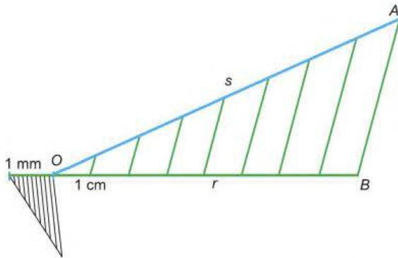
Figura 1.17. Construcción de una escala gráfica.
