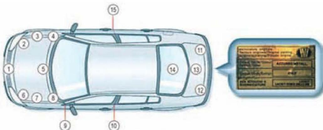
Figura 4.13. Ubicaciones más frecuentes de la placa de datos para la identificación de la pintura de un vehículo.
