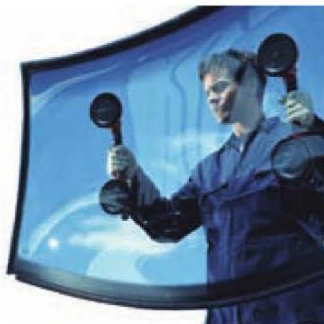
Figura 7.58. Retirada y manipulación de la luna mediante ventosas.
