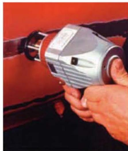
Figura 8.86. Reparación de una puerta con desabollador neumático.
