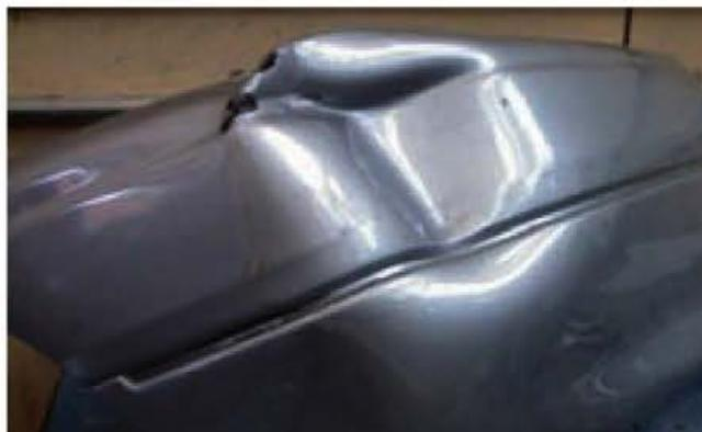
Figura 9.80. Deformación de paragolpes con rotura.
