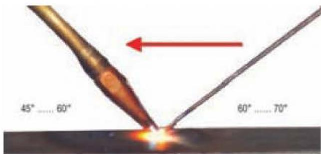
Figura 11.16. Soldadura a izquierda.
