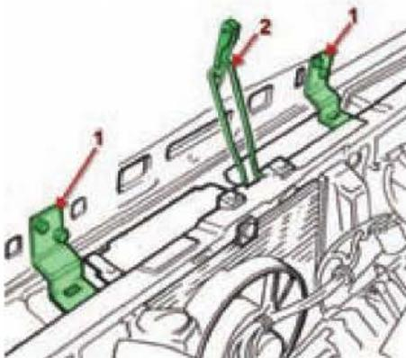
**Figura 6.61.** Fijación del capó al frente delantero.
