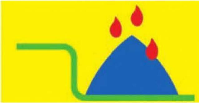
Figura 10.23. Sellador por absorción de humedad (PUR).
