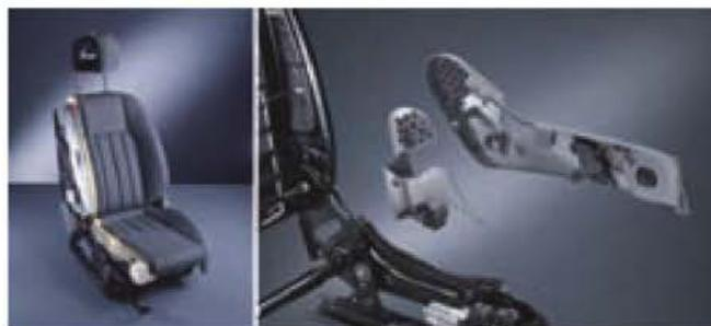
Figura 9.33 A y B. Interior de un asiento con componentes de poliuretano.
