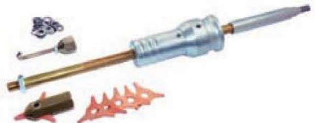
Figura 8.59. Martillo de inercia con algunos elementos específicos.
