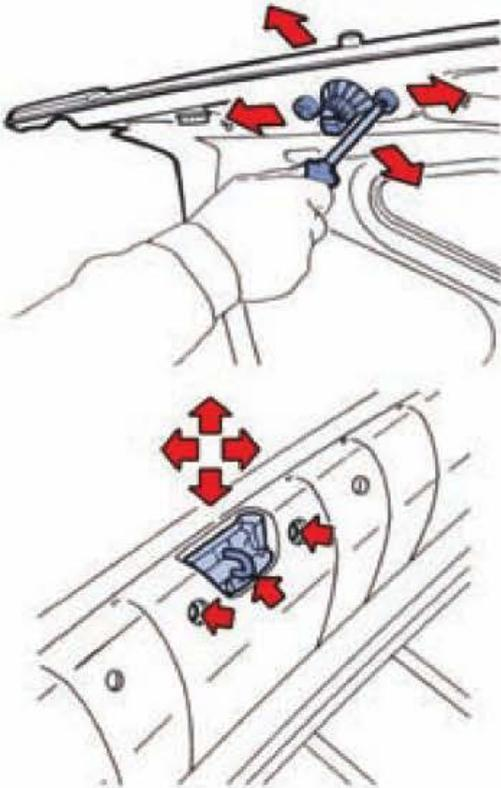
Figura 6.101. Ajuste del conjunto de cierre de la tapa de maletero.
