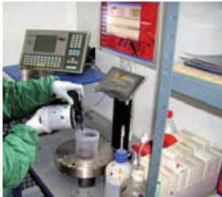
Figura 3.54. Operación de pesado con una báscula de precisión.
