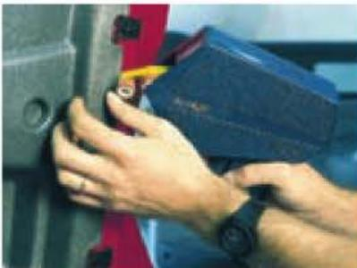
**Figura 5.105.** Aplicación de la cinta adhesiva para láminas aislantes de puertas.
