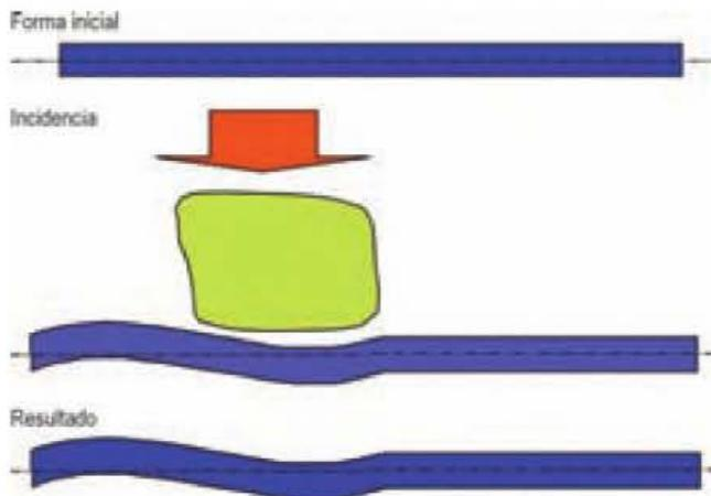
Figura 8.27. Como resultado de una incidencia, la chapa del vehículo solamente resulta dañada en la zona de la incidencia.
