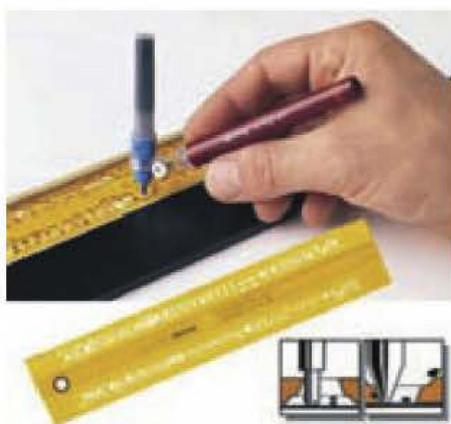
Figura 1.13. Utilización de plantillas de rotular.
