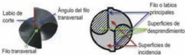
**Figura 2.56.** Constitución y ángulo del filo transversal de la punta de la broca.
