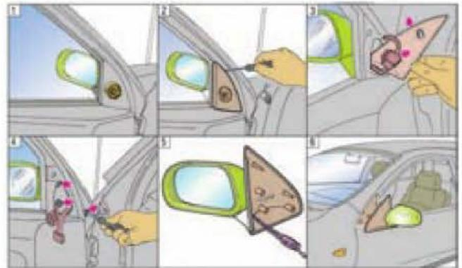
Figura 6.42. Proceso de desmontaje de un espejo retrovisor.
