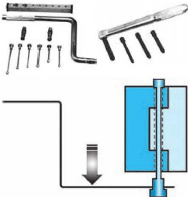
Figura 6.20. Útiles y forma de desmontar pasadores.
