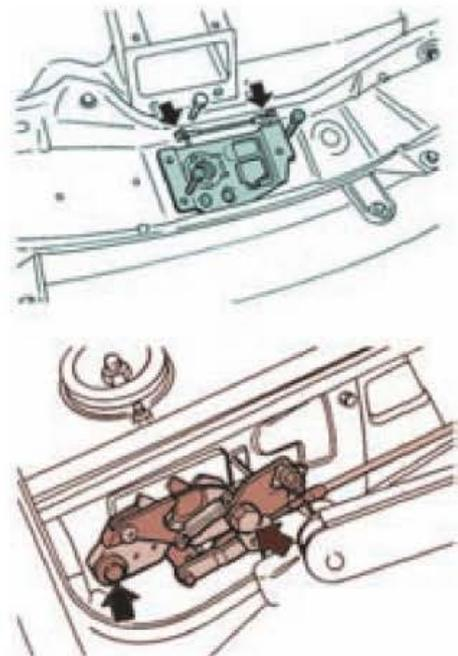
Figura 6.66. Desmontaje de la cerradura del capó.
