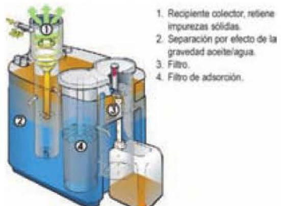
Figura 3.24. Radiografía de un separador de condensado.
