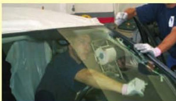
21. Retirada del parabrisas deteriorado.
