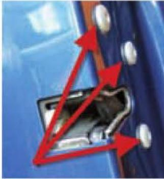
Figura 6.31.b. Desmontaje de la cerradura.
