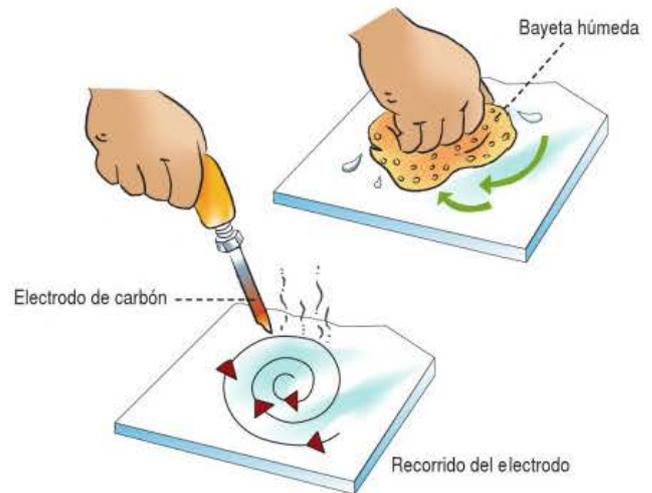
Figura 8.42.b. La operación de recogida se potencia calentando la zona con el electrodo de carbón y enfriándola rápidamente con un paño.
