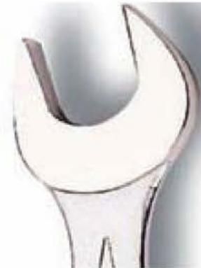
Figura 3.55. Llave con boca deformada.
