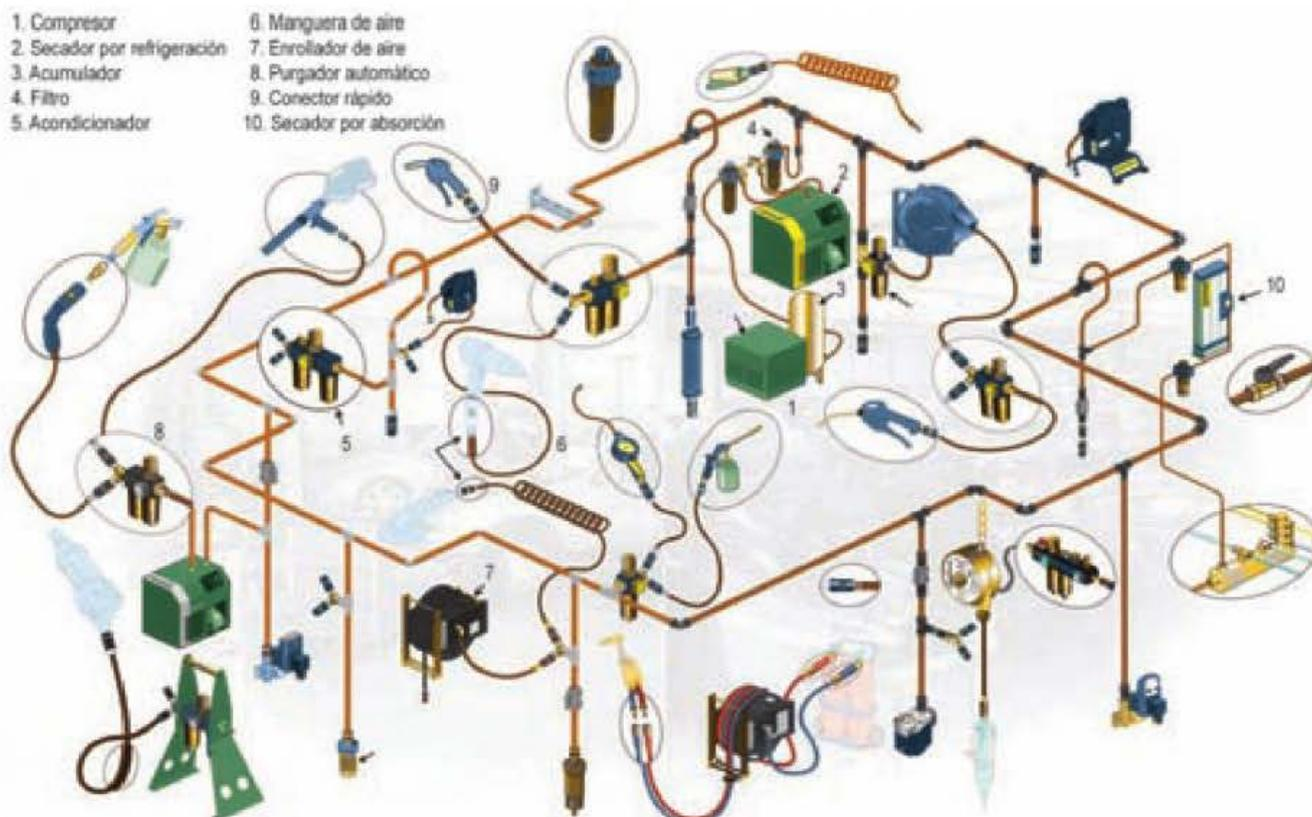
Figura 3.18. Esquema general de un sistema de tratamiento y distribución de aire comprimido.
