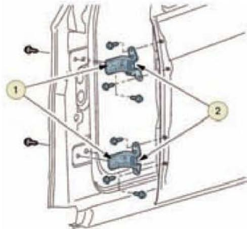
Figura 6.15. Bisagras fijadas con tornillos.
