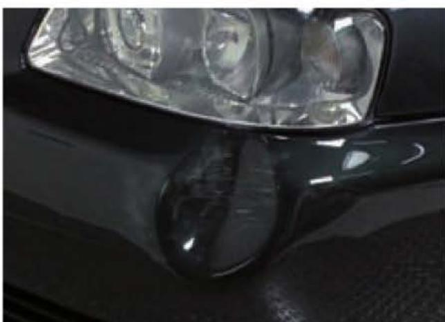
Figura 9.79. Deformación de paragolpes.
