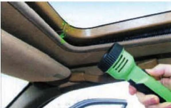
Figura 6.161. Detector con solución fluorescente y rayos UV.
