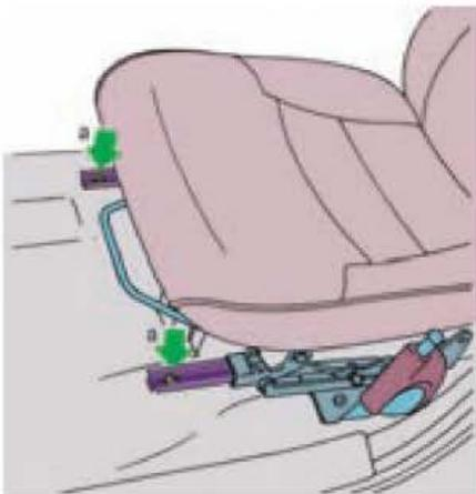
**Figura 6.174.** Fijación del asiento al piso del habitáculo mediante guías.
