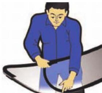
Figura 7.73. Montaje de las molduras de impermeabilización.
