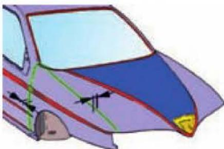
**Figura 6.107.** Alineación de la aleta con el capó y el pilar delantero.
