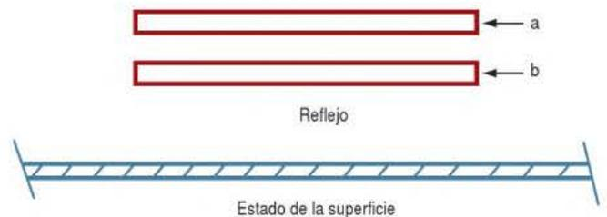
Figura 8.97. El reflejo de la pantalla sobre una superficie no deformada siempre será paralelo.
