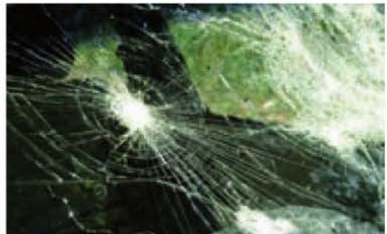
Figura 7.25. Rotura de un vidrio laminado.
