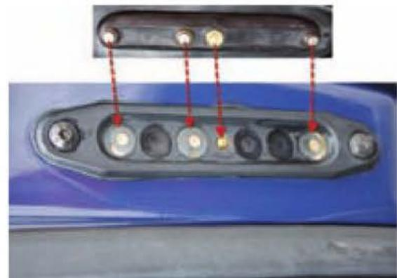
Figura 6.79. Contactos eléctricos móviles.
