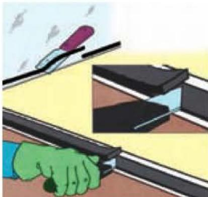
**Figura 7.66.** Nivelado del cordón de adhesivo residual.
