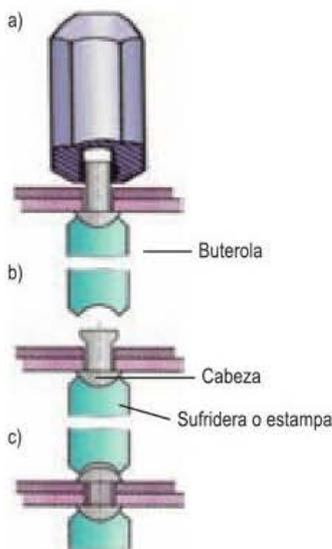
Figura 5.67. Proceso de conformación de un remache de compresión.
