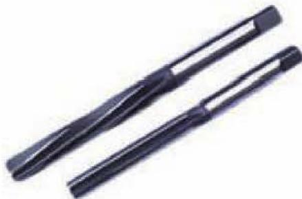
Figura 2.81. Escariador de arista helicoidal y de arista recta.
