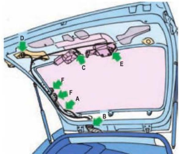
Figura 6.78. Desmontaje de las conexiones eléctricas.
