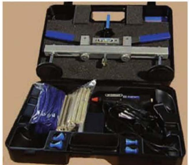
Figura 8.93. Equipo de ventosas adhesivas con sistema de tracción por palancas.
