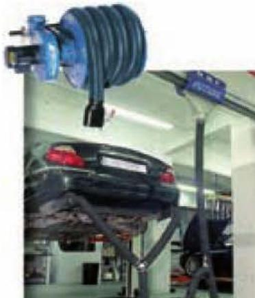
Figura 3.39. Sistemas de extracción de gases de escape.
