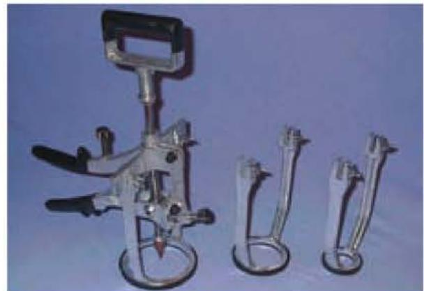
Figura 8.71. Útiles diseñados para controlar el tiro sobre los elementos soldados adaptables a diferentes tipos de superficies.
