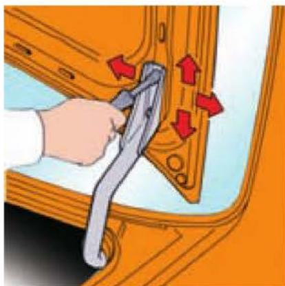
Figura 6.99. Ajuste de las bisagras para corregir el alineamiento.
