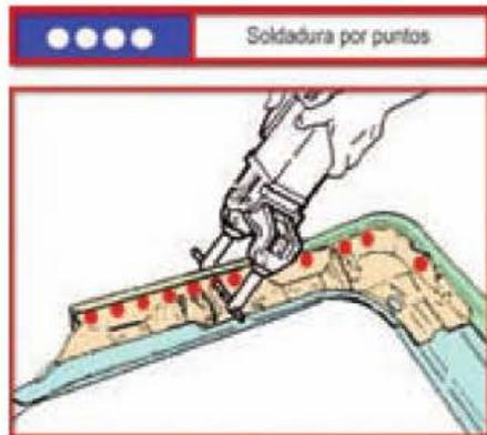
Figura 1.76. Pictograma de soldadura por puntos.
