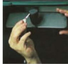
Figura 5.108. Adhesivos para retrovisores interiores.
