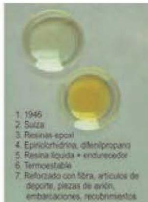
Figura 9.27. Resinas epoxi.
