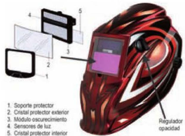
Figura 11.34. Pantalla de protección electrónica del soldador.
