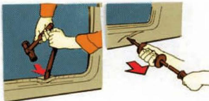
Abolladura en el larguero bajo puerta (talonera), requiere abrir el cajado mediante desprendimiento de puntos de soldadura, o la utilización de utilillaje especial para trabajar por el exterior
