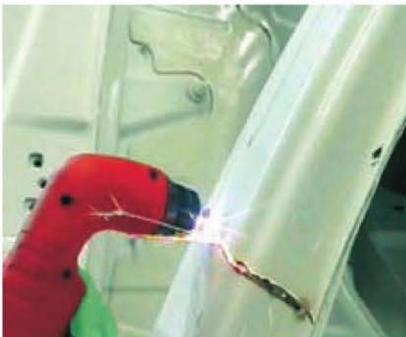
Figura 12.50. Cortando pilar central con plasma.
