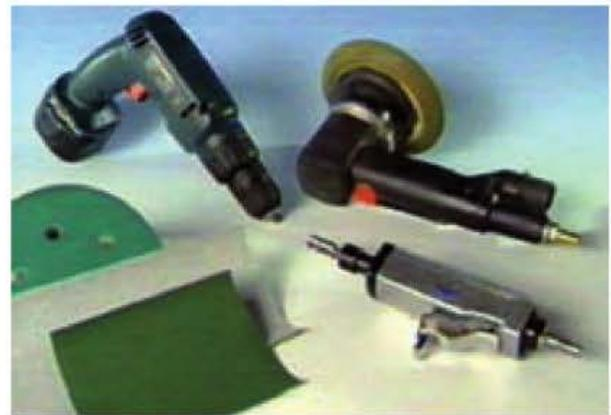
Figura 9.100. Máquinas auxiliares y lijas.
