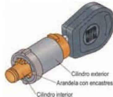
Figura 6.33. Bombín con desacoplador.
