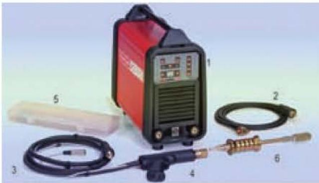
1. Transformador de corriente con panel de control.
