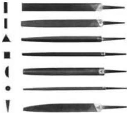
Figura 2.35. Diferentes tipos de limas en función de su forma.
