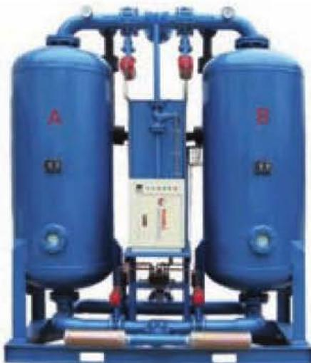
Figura 3.22. Secador por adsorción.
