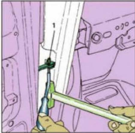
Figura 6.12. Útil para desmontar pasadores.
