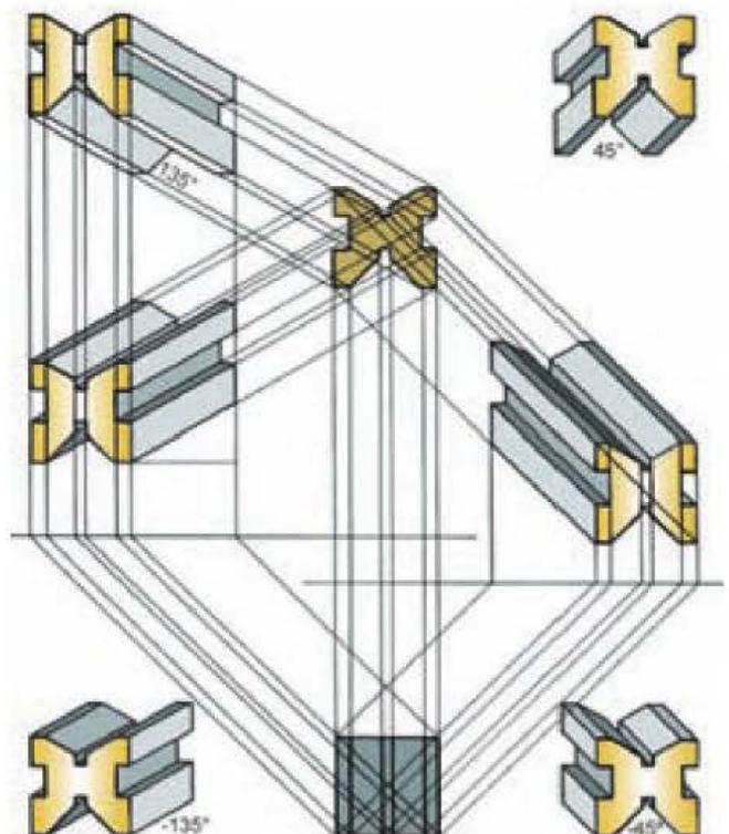
Figura 1.43. Representación en perspectiva caballera de una pieza partiendo de sus proyecciones ortogonales.
