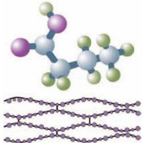
Figura 9.30 A y B. Los elastómeros forman una red de malla abierta.
