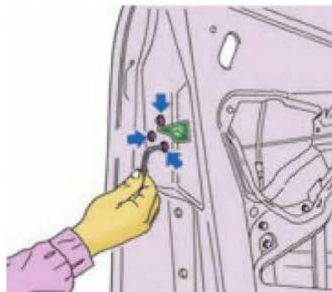
Figura 6.31.a. Desmontaje de la cerradura.
