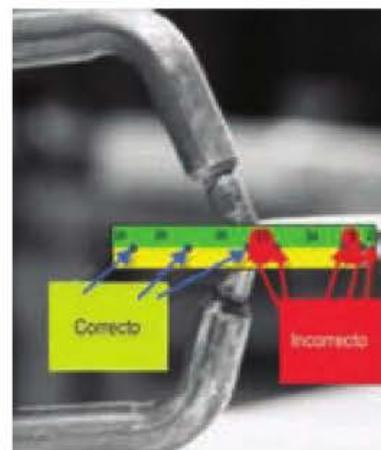
Figura 11.153. Distancia correcta e incorrecta entre puntos de soldadura.
