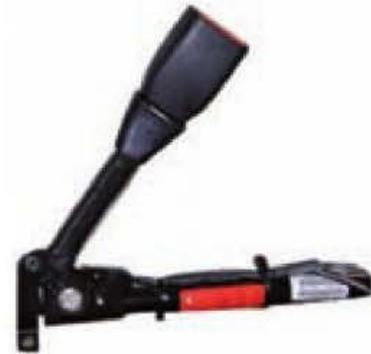
Figura 6.191. Sistema pretensor del cinturón.
