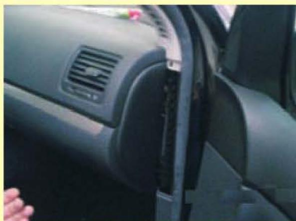
12. Desmontaje del guarnecido del pilar izquierdo.
