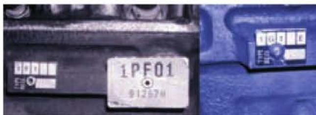
Figura 4.14. Placa de identificación del motor.
