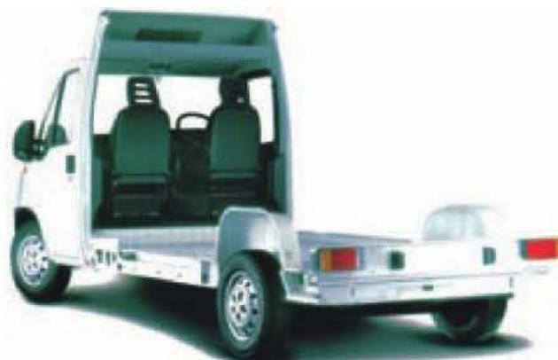
Figura 4.35. Vehículo industrial tipo «furgón plataforma-cabina».
