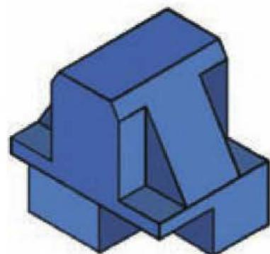
Figura 1.36. Representación isométrica de una pieza.
