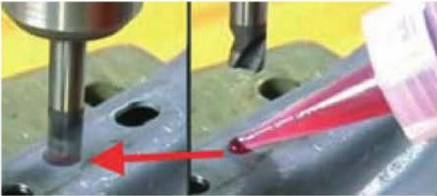
**Figura 12.32.** Lubricación de la broca en aceros de alta resistencia
