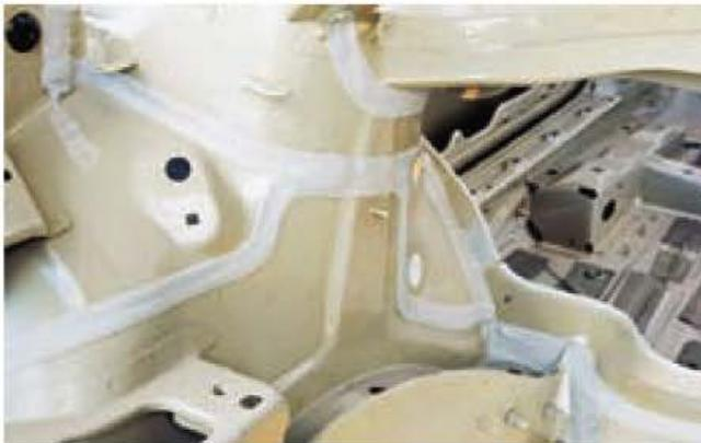
Figura 10.21. Sellado de uniones en el compartimento del motor.
