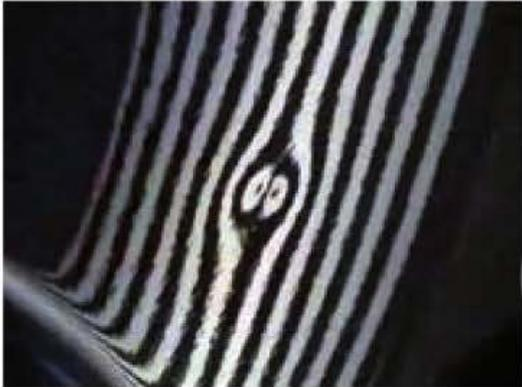
Figura 8.99. El reflejo indica una superficie deformada hacia el interior del vehículo.
