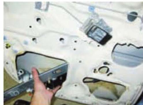
Figura 6.49. Extracción del mecanismo elevavinas a través de un hueco del bastidor de la puerta.
