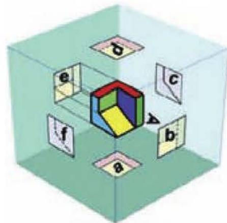
Figura 1.32. Método de la caja o cubo.
