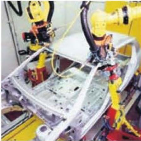
Figura 11.127. Soldadura láser.
