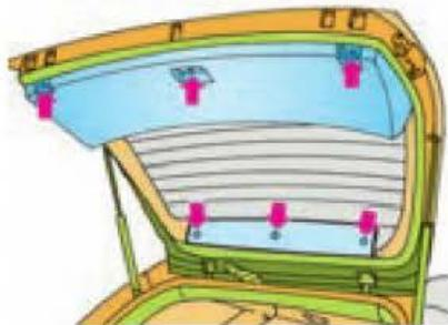
Figura 6.77. Desmontaje del guarnecido del portón.
