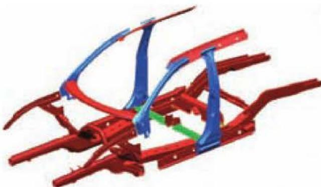
Figura 4.50. Elementos de la estructura de la carrocería: largueros, travesías, pilares, etc.
