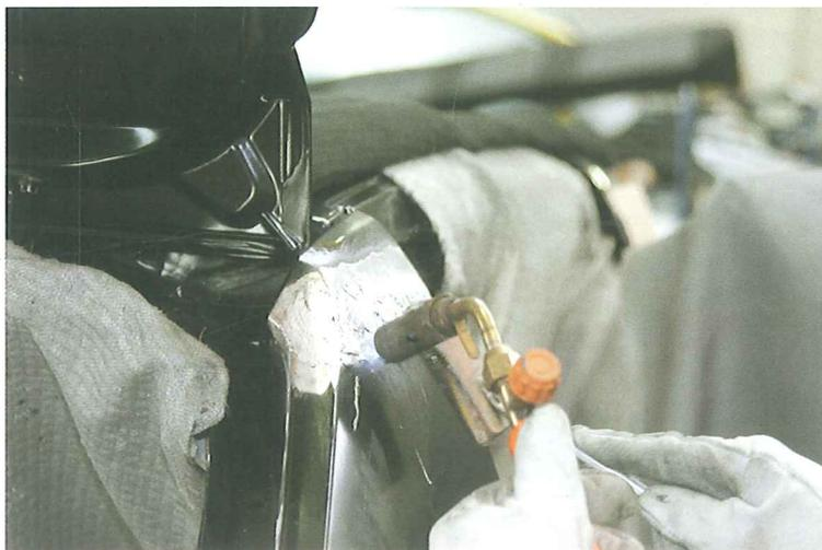
Aplicación de estaño en una unión por sección parcial
