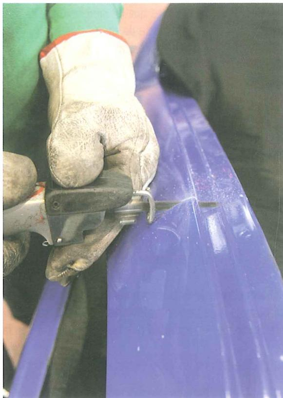
Detalle del corte con una sierra neumática
