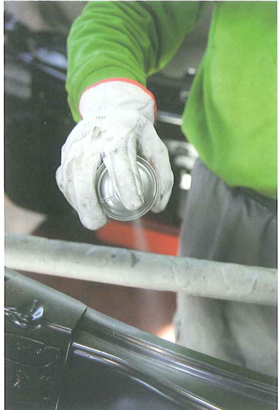
Aplicación de protección anticorrosiva previa a la ejecución de la soldadura
