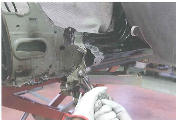
15. Con ayuda de la radial, se repasan los restos que hubiesen podido quedar de los puntos de resistencia.
