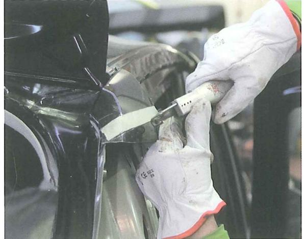
25. Con disco de bajo poder abrasivo se elimina la pintura de las zonas en las que van las líneas de ensamblaje y en las que, posteriormente, habrá que aplicar soldadura MIG/MAG. Tanto en el recambio como sobre la carrocería.
