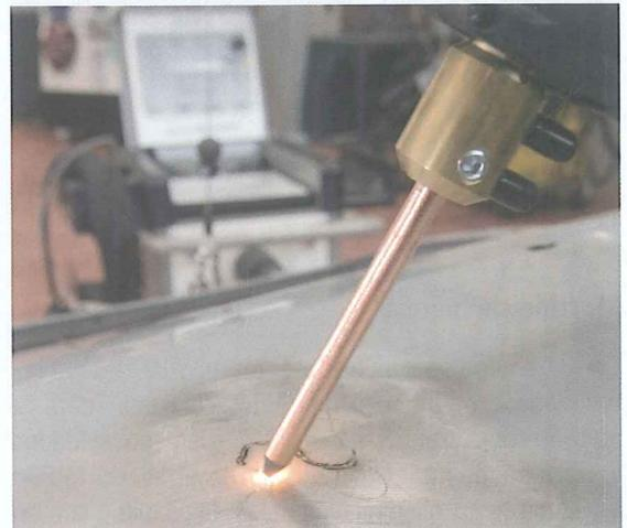
Recogida de chapa con electrodo de carbono
