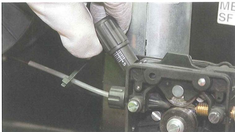
A continuación, apretamos el gatillo del pistolete y sujetamos el hilo con los dedos tratando de detener el avance del hilo. La presión la aplicaremos de forma intermitente.
