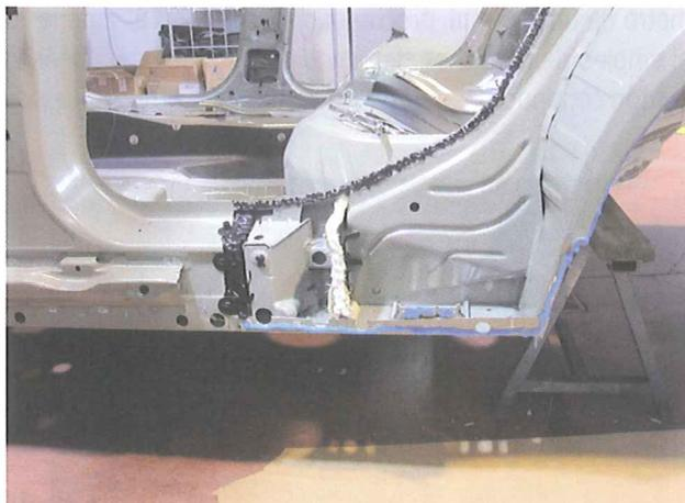
Aplicación de adhesivo para la sustitución de una aleta trasera
