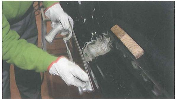
39. Debido a las formas que presenta la pieza, parte del lijado se realiza con un pequeño disco abrasivo P50.
