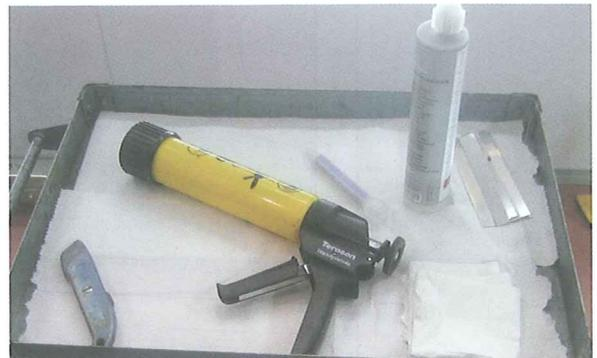
Adhesivo epoxi para la fijación de la aleta
