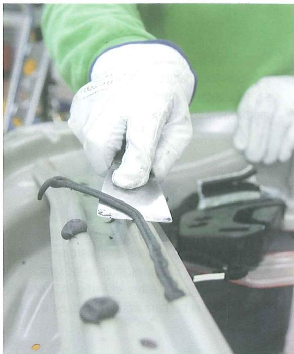
13. Si fuera necesario, se acondicionan todas las pestañas del armazón con tas y martillo y se limpian adecuadamente, con el fin de conseguir una buena base de apoyo para el panel nuevo.
