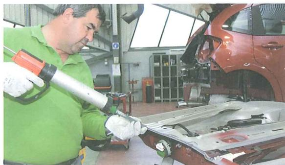
16. Se colocará el armazón de la puerta sobre el panel. Esta operación también puede realizarse a la inversa, sujetando el panel al armazón por medio de mordazas autoblocantes.
