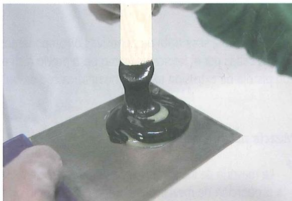
Mezcla manual de adhesivos bicomponentes
