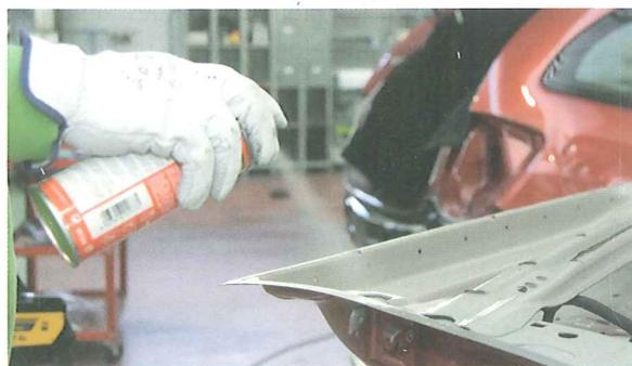
15. Para garantizar la estanqueidad de la junta, se aplica a lo largo de todo el contorno del panel un sellador de poliuretano apropiado. A su vez, contribuirá a garantizar la unión panel-armazón.
