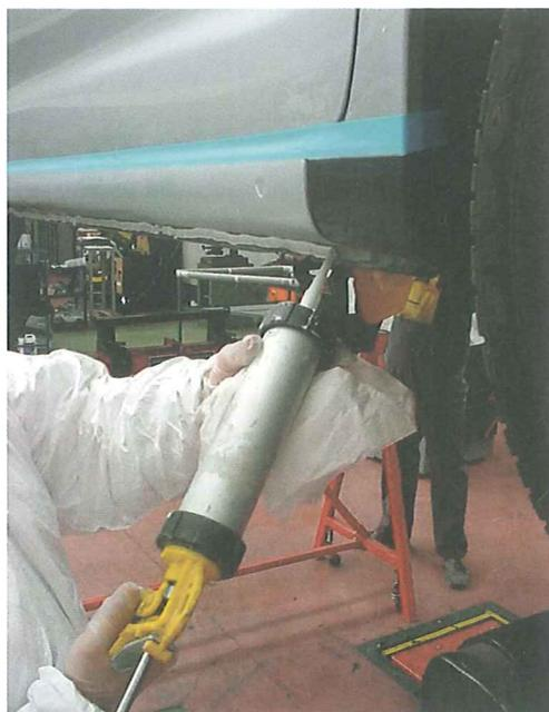
En las superficies de fácil acceso debe aplicarse imprimación anticorrosiva sobre la chapa viva y, una vez seca, un sellador de poliuretano a brocha o pulverizado.
