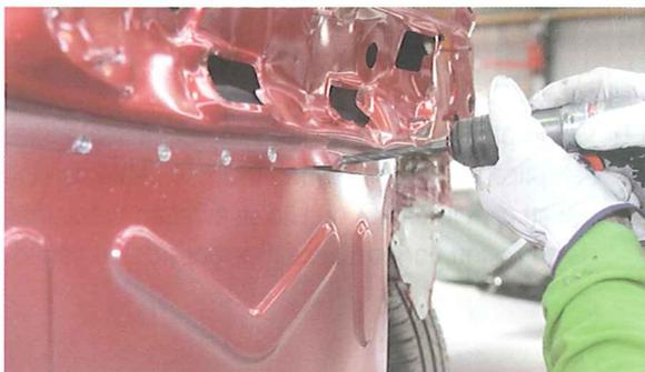
9. Con la retirada del grueso del faldón se obtendrá un buen acceso a los puntos de soldadura de su contorno. Esta operación facilitará el despunteado de las pestañas, agilizándose la faena.
