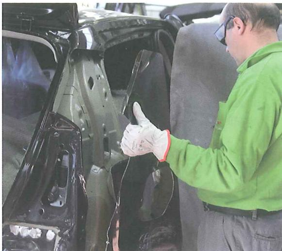
13. Una vez retirada la pieza de desecho, se puede acceder perfectamente al desgrapado de las pestañas a las que no se tenía acceso con la aleta montada.
