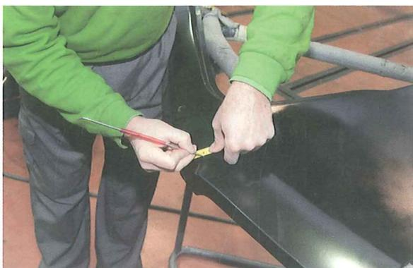
20. Auxiliándonos en una cinta de carrocerero se realiza el corte definitivo sobre el recambio. Para ello, se empleará una sierra neumática de vaivén, que produce un corte limpio y con pocas rebabas.
