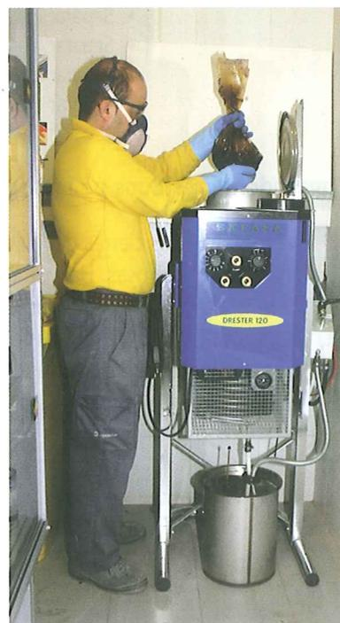
Bolsa termorresistente con el residuo de destilado
