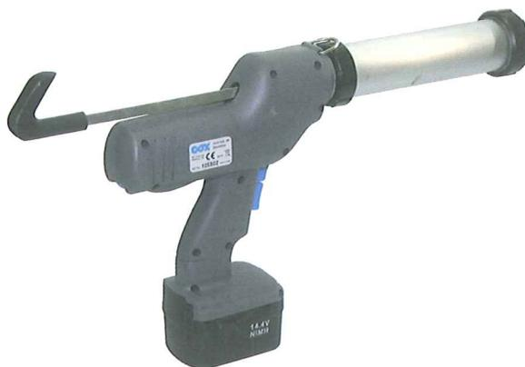
Para la aplicación se deberá hacer uso de una pistola específica adaptada al cartucho
