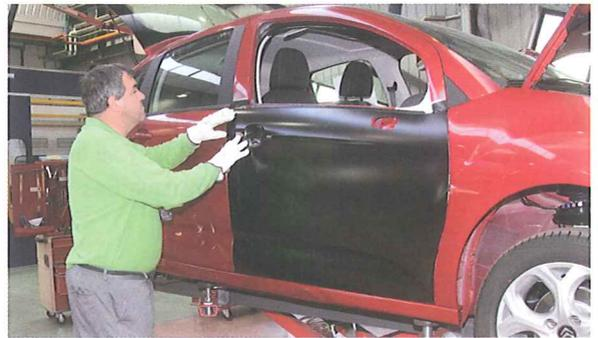
19. Con un abrasivo adecuado se elimina la pintura, sin dañar la chapa, de la zona donde se realizará la soldadura de unión.
