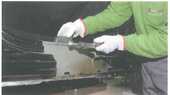
13. Con una cinta métrica se toma la medida correspondiente a la línea de corte sobre la parte no dañada del estribo.
