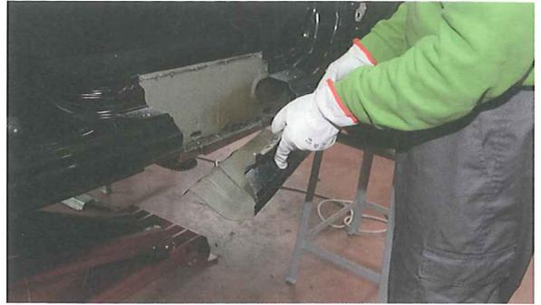
11. Con la ayuda de una radial, se eliminan los restos de material que hayan podido quedar en los puntos de soldadura.
