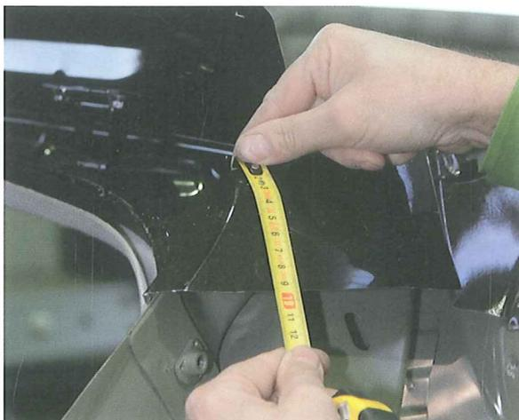
19. Teniendo como base las medidas tomadas sobre el vehículo se marca la línea de corte sobre el recambio, dejando margen suficiente para realizar el ensamblaje con relación al corte de desecho realizado en el vehículo.
