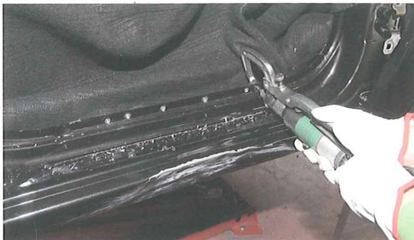
6. Con un disco de acero trenzado se elimina el anti-gravilla de la pestaña inferior para dejar al descubierto los correspondientes puntos de soldadura.
