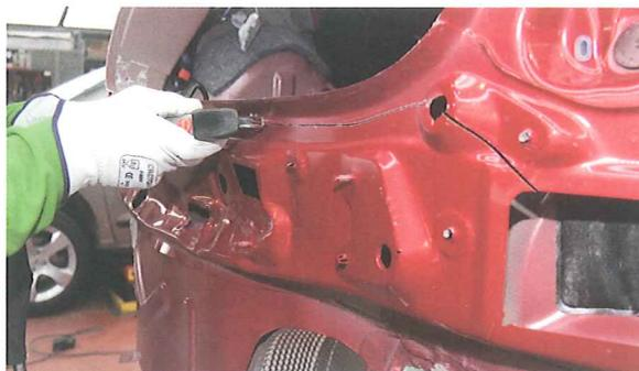
6. Con un disco de nylon expandido o similar se eliminan las masillas de estanqueidad en el contorno de las pestañas, dejando al descubierto los puntos de soldadura.
