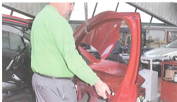
7. Se miden y se marcan las zonas de corte sobre el marco de la puerta y, seguidamente, se cortan las secciones mediante una sierra neumática.
