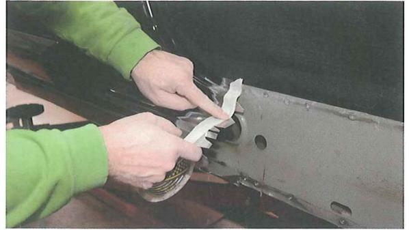
27. Se aplicará una protección anticorrosiva al cinc sobre la cara interna de todas las pestañas y en aquellas zonas que se encuentran en chapa viva.
