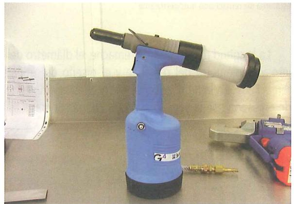
Remachadora para la colocación de remaches ciegos
