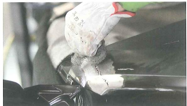
47. El estaño se aplica en cantidad suficiente a lo largo de toda la línea de ensamblaje.
