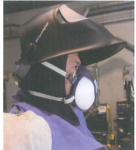
Los filtros para gases y vapores han de cambiarse periódicamente
