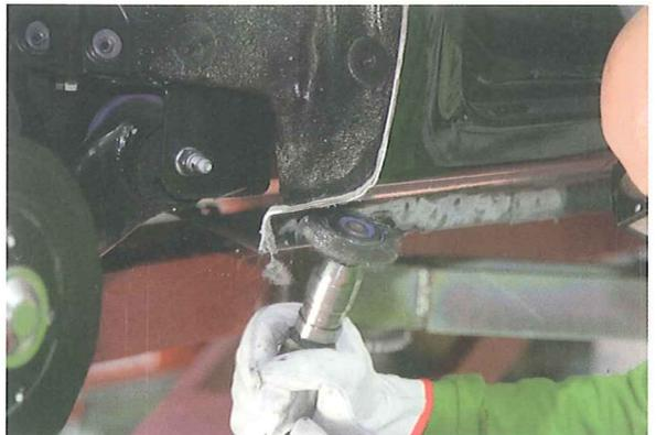
7. En aquellas zonas cerradas en las que no hay acceso para la despunteadora, como la boca de llenado, se eliminarán los puntos haciendo uso de un taladro dotado de una broca con ángulo de corte plano. En este caso, conviene aumentar las precauciones para evitar daños en la pestaña posterior.
