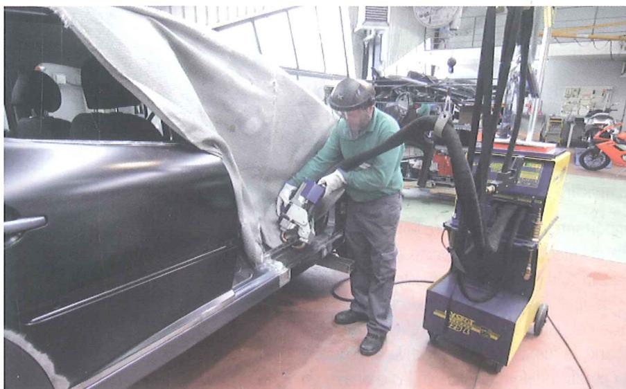
Protección del interior del vehículo con una manta ignífuga
