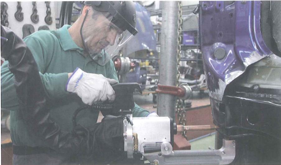
Soldadura con pinza en C
