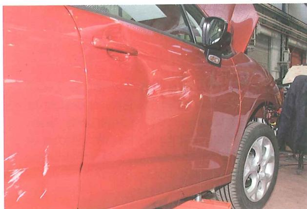
2. Como en toda operación de sustitución, el proceso comienza con el desmontaje de los elementos que interfieren en la operación, como el guarnecido interior de puerta.
