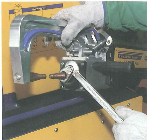
El sistema de ensamblaje empleado en la fabricación de piezas que presentan una unión fija es, generalmente, la soldadura por puntos de resistencia, apoyada en casos muy concretos por la soldadura de hilo continuo bajo gas protector MIG/MAG, soldadura láser y la soldadura fuerte MIG-Brazing.
