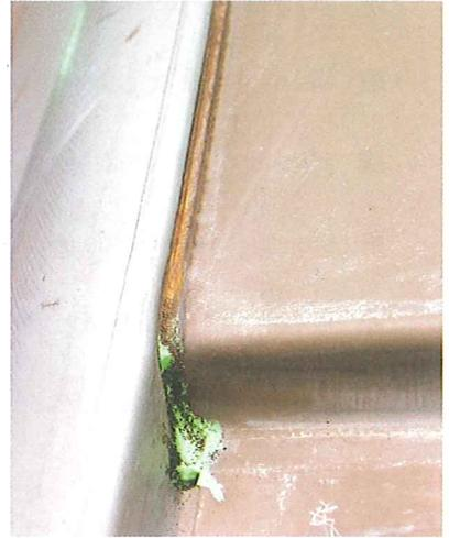
Soldadura láser-híbrida en una carrocería
