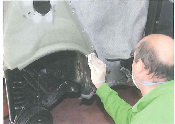
31. Una vez evaporado por completo el disolvente de limpieza, se aplica el adhesivo estructural en el arco de la rueda y en el contorno de la boca de llenado de combustible.
