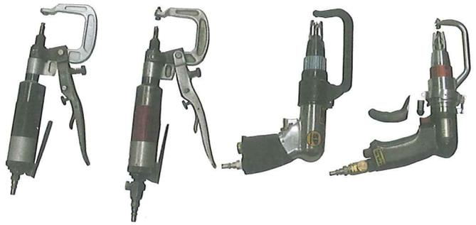
Despunteadoras de puntos de soldadura
