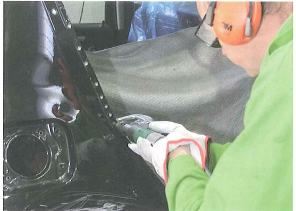
6. Para acceder a desgranpar los puntos de resistencia en la zona inferior del estribo es necesario retirar la protección antigavilla con la ayuda de un disco de acero trenzado.
