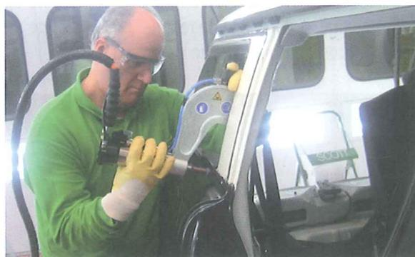
Remachadora neumática para remaches auto perforantes
