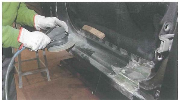
41. En aquellas zonas a las que, debido a su geometría, no se puede acceder correctamente con la radial, se realiza el acabado con un lijado manual, con un taco de lija provisto de un abrasivo de grano fino.
