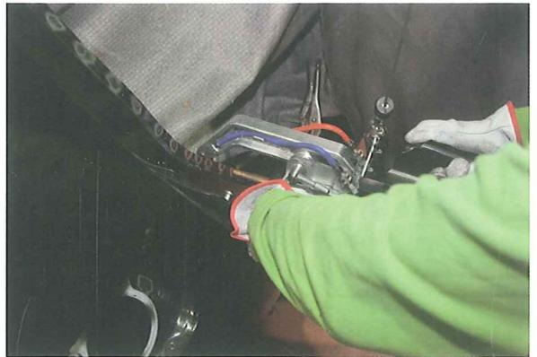
43. En el contorno de la boca de llenado se devuelven los puntos de soldadura originales.
