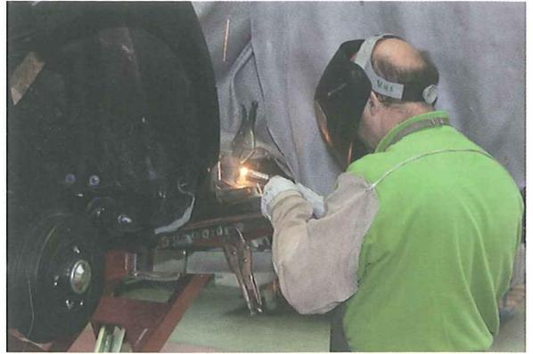
41. En el resto de las pestañas se elimina la cataforesis de las zonas de contacto de los electrodos, tanto exterior como interior, para asegurar un buen contacto eléctrico en la ejecución de los puntos de soldadura por resistencia eléctrica.
