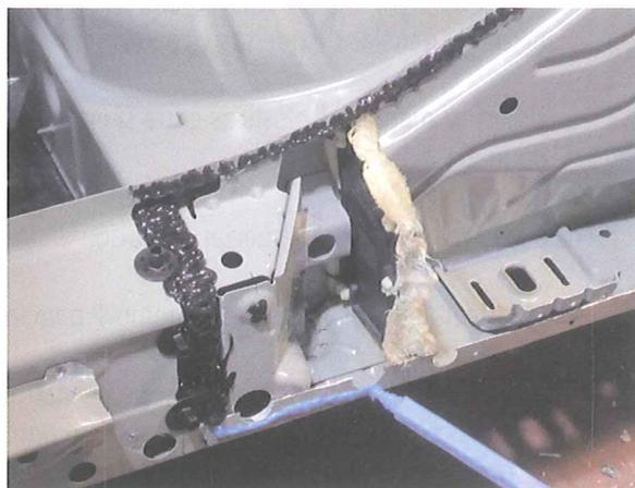
Aplicación de adhesivo bicomponente
