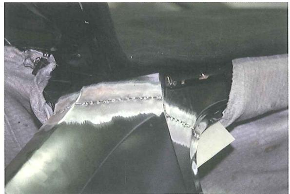
38. En zonas cerradas a las que no se tiene acceso para la pinza del equipo de soldadura por puntos de resistencia, se realizan unos taladros para la soldadura a tapón.
