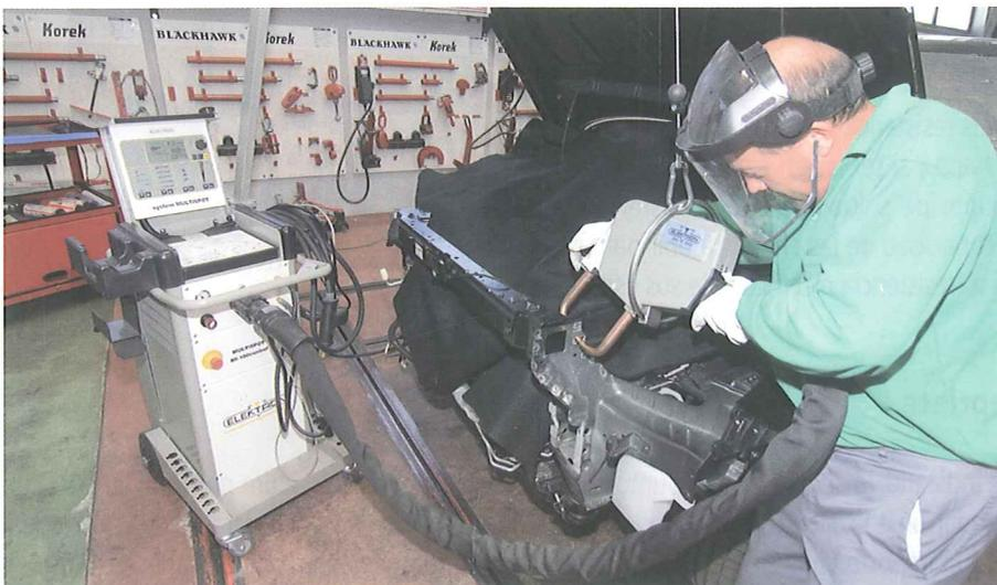
Soldadura por puntos de resistencia
