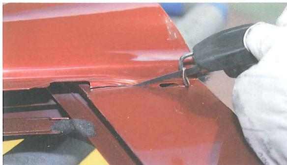
8. Con una radial se desbarba el contorno de la puerta que se pretende sustituir, a fin de eliminar el engatillado del panel.
