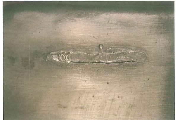
Agrietamiento en caliente de un cordón de soldadura
