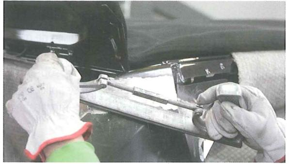
50. El acabado final se realizará con una lijadora roto-orbital, consiguiendo una superficie perfectamente homogénea para recibir el posterior tratamiento de pintura.
