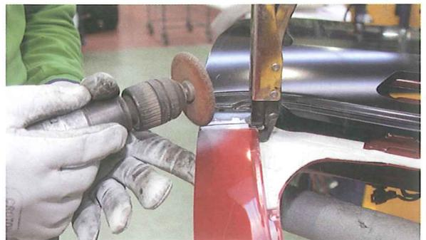
20. Las líneas de ensamblaje al marco de puerta se sueldan mediante soldadura MIG/MAG en la modalidad de cordón continuo a intervalos.
