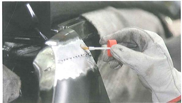
46. Se aplican unas pocas gotas de estaño en la zona y se calientan con la lamparilla, extendiéndolas por toda la superficie con un estropajo metálico muy fino. Con ello se consigue una fina película de estaño, que servirá como base de anclaje al posterior estaño de relleno.
