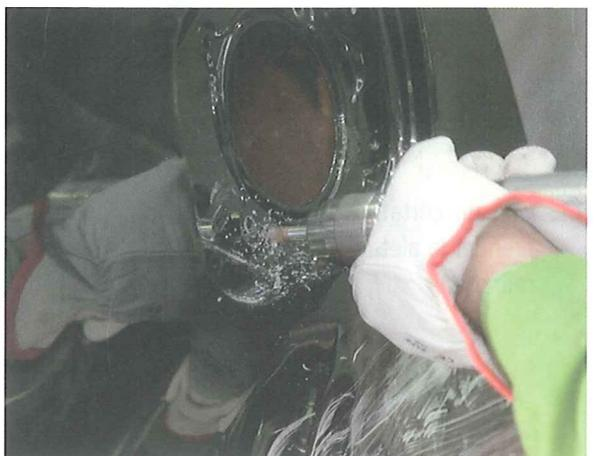
8. Haciendo uso de una radial neumática, se elimina el engatillado que une la aleta con el pase, a lo largo del arco de la rueda.
