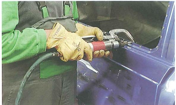
Despunteado de una soldadura por resistencia
