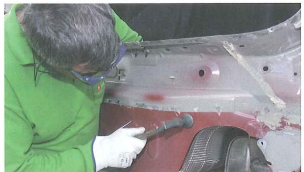
11. Como paso previo a la ejecución de la soldadura, se aplica una imprimación electrosoldable de cinc por su cara interna. Con ello se evitarán problemas de corrosión por posibles filtraciones de humedad.
