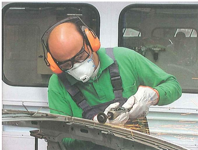
Esmerilado de un punto de soldadura
