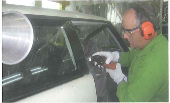
Desmontaje de la luneta lateral
