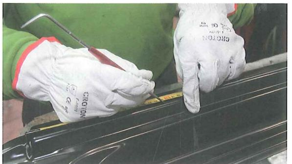
15. La colocación de una cinta de enmascarar servirá de guía para realizar el corte.
