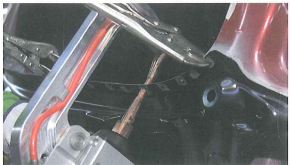
16. Dado que la pestaña con piso maletero tiene difícil acceso, se hace necesario recurrir al empleo de los brazos largos del equipo para poder soldar desde arriba. Conviene recordar que la presión efectiva en la punta de los electrodos habrá disminuido, debido a la propia palanca de los mismos.
