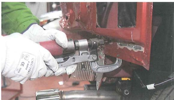
8. En aquellas zonas donde no existe acceso para la despunteadora por ambas caras, se recurre al empleo de un taladro equipado con una broca con un ángulo de corte plano; así se evitan daños excesivos a las pestañas de la carrocería.
