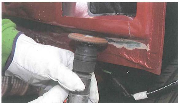
7. El despunteo de los puntos se realiza de forma rápida y sencilla al hacer uso de una despunteadora específica.
