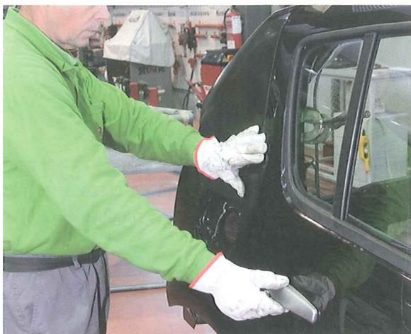
23. Una vez en su posición correcta, se marca la línea de corte sobre el vehículo con ayuda de una punta de trazar.
