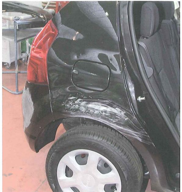
2. Como en toda operación de sustitución, se comenzará con el desmontaje de los elementos y accesorios que interfieren en la operación, como el paragolpes trasero, los pilotos, la bandeja, las gomas de contorno, etc.
