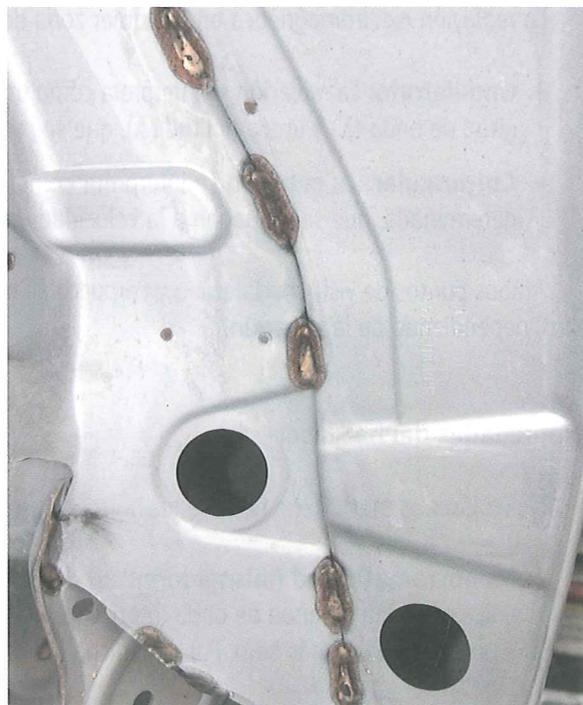
Ejecución y detalle, a la derecha, de una soldadura dura-MIG
