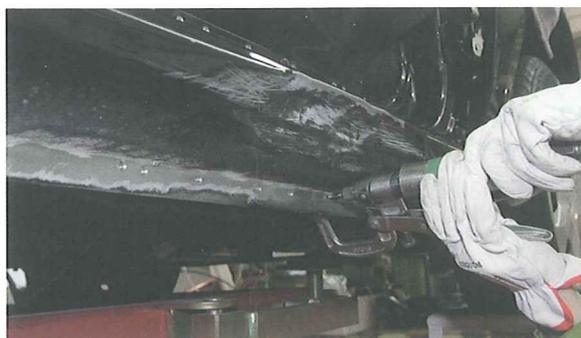
8. Con una sierra neumática de vaivén se realiza un corte de desecho, a fin de facilitar la retirada de la zona dañada.
