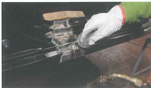
36. La aplicación del estaño de relleno se realizará de abajo hacia arriba para, de este modo, evitar descolgamientos, al ser una aplicación vertical.
