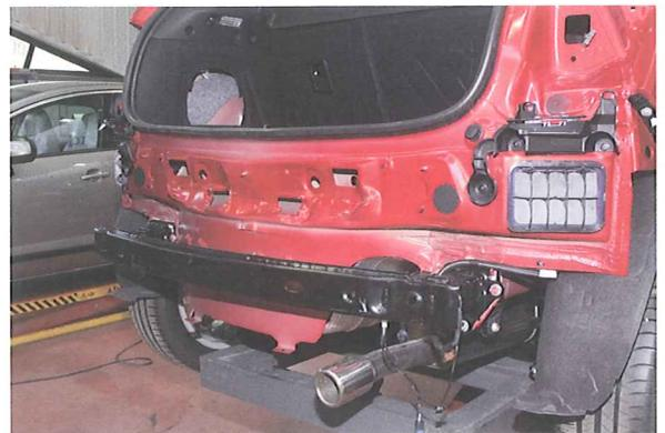
2. El proceso de reparación comenzará con la retirada de las piezas y accesorios de la zona afectada (travesía trasera, pilotos, goma de contorno, etc.) hasta dejar el faldón al descubierto.
