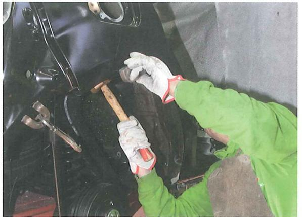
35. El empleo de un martillo de nylon para el plegado garantiza que no se produzcan deformaciones por la cara exterior de la pieza.
