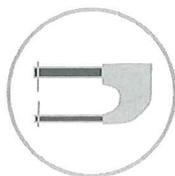
La pestaña inferior de la aleta marcada con este símbolo se unirá mediante soldadura por puntos de resistencia.
