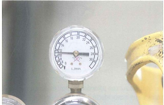
Regulación del caudal de gas para la soldadura fuerte MIG
