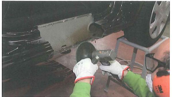
12. Con un repaso final de las pestañas se dará por concluido el acondicionamiento de la zona, para facilitar el correcto asentamiento del recambio nuevo.
