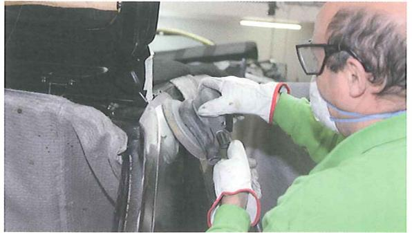
51. En las zonas con muchos quebrantos, el acabado final se realizará mediante un lijado manual con taco.
