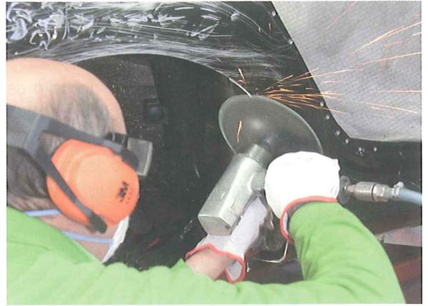
9. Con la sierra neumática de vaivén se realizan unos cortes de desecho alrededor de la pieza. Estos cortes se efectuarán en zonas fuera del daño, con un margen suficiente para el montaje de la aleta de recambio.
