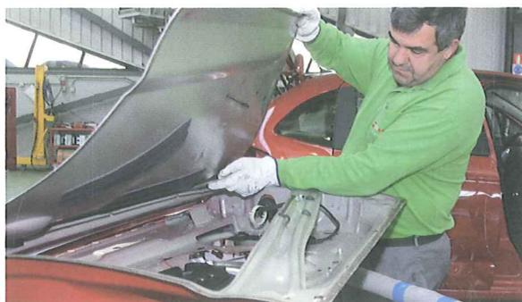
11. Por medio de un disco de resina y acero trenzado, se elimina el sellador en todo el contorno del armazón de la puerta.
