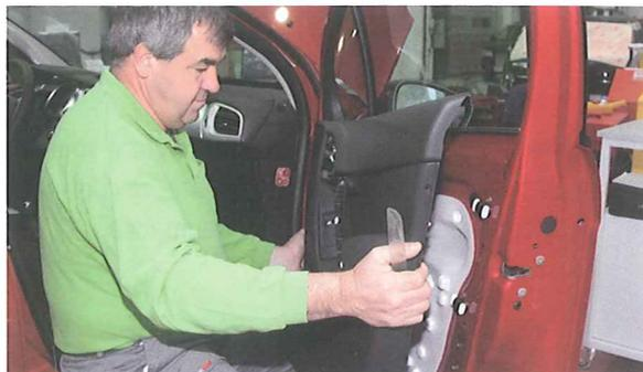
3. Con la retirada del plástico impermeabilizante se tendrá acceso a todos los accesorios interiores de la puerta.
