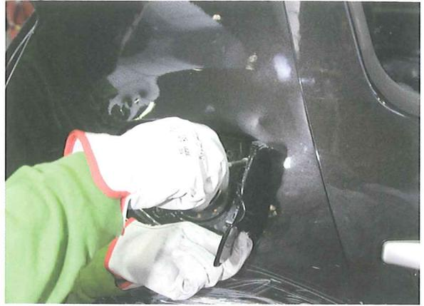
5. Los puntos de soldadura por resistencia se desgranpan con una despunteadora en la que previamente se ha regulado la profundidad de corte, de acuerdo al espesor de la propia aleta. Esta herramienta permite realizar la operación de forma segura, rápida y sin daño para las pestañas posteriores de la carrocería. Aquellas pestañas que no tienen acceso se pueden dejar para cuando se retire la aleta.
