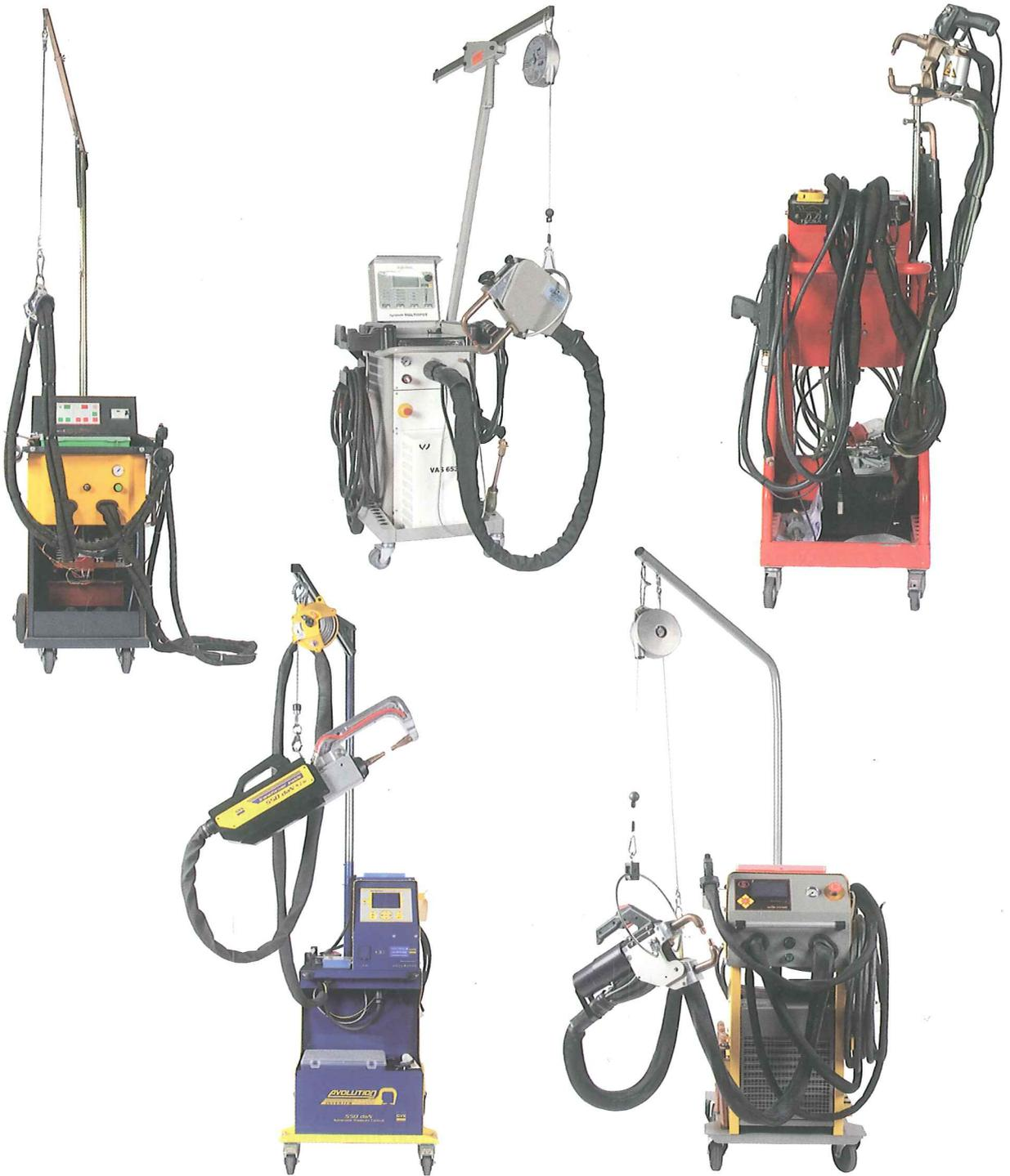
Equipos de soldadura por puntos empleados en la reparación de automóviles
