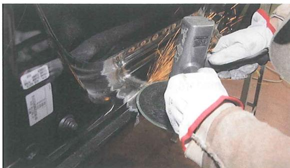
33. La zona del ensamblaje se limpia para posibilitar el proceso de estañado.
