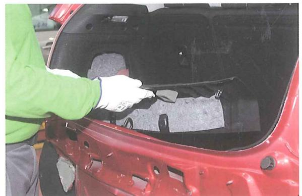
4. Antes de proceder a realizar el corte y desmontar el faldón dañado es recomendable comprobar que la pieza de recambio coincida exactamente con la pieza a sustituir y que no le falte ningún complemento o accesorio que pueda influir en el proceso. En este caso, el faldón se suministra en conjunto con su refuerzo como una única pieza de recambio.
