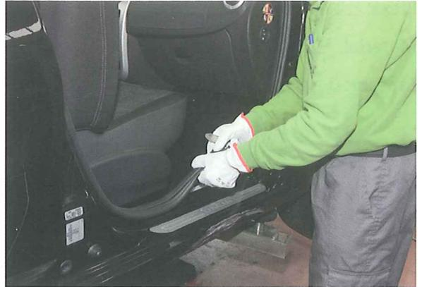
2. Este vehículo no dispone de conector general en la instalación eléctrica de la puerta, por lo que es necesario retirar toda la instalación para desmontar la puerta.
