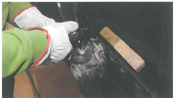
40. El acabado final de la unión se realiza con la lijadora excéntrica rotativa con grano P80.
