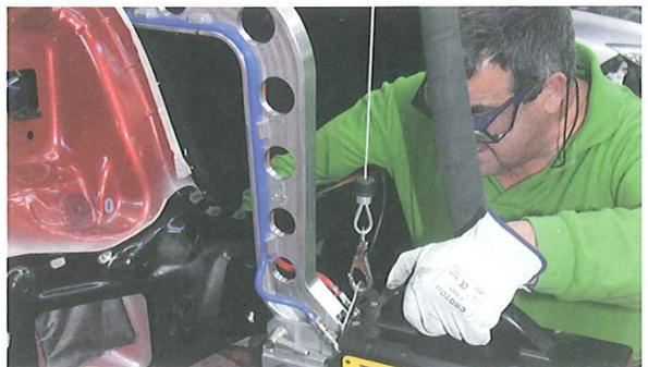
17. Se desbarban los puntos de soldadura y se aplica un sellador a brocha en los bajos del vehículo que garantice la estanqueidad necesaria a la unión entre el faldón y el piso. De este modo, se evitarán degradaciones prematuras de la carrocería por problemas de corrosión.
