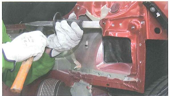
10. La siguiente operación consiste en la preparación de las pestañas, repasándolas con tas y martillo para dejar un buen asiento al recambio nuevo y esmerilando los puntos de soldadura.
