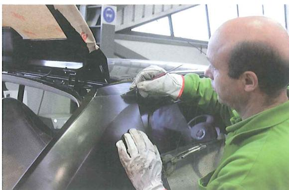
24. Se coloca una cinta de enmascarar, haciendo coincidir su borde superior con la línea marcada. El borde inferior de la cinta nos marcará la línea de corte definitiva, dado que su ancho (19 mm) coincide con el ancho del posterior solape a realizar.
