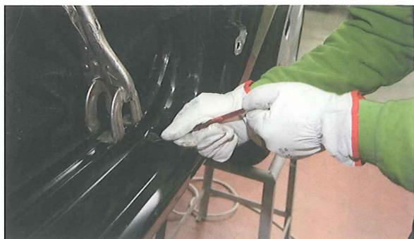
19. Se coloca la cinta de 19 mm haciendo coincidir su borde superior con la línea marcada. El borde inferior es la línea de corte definitiva, ya que el ancho de la cinta coincide con el que necesitamos para realizar el solape.
