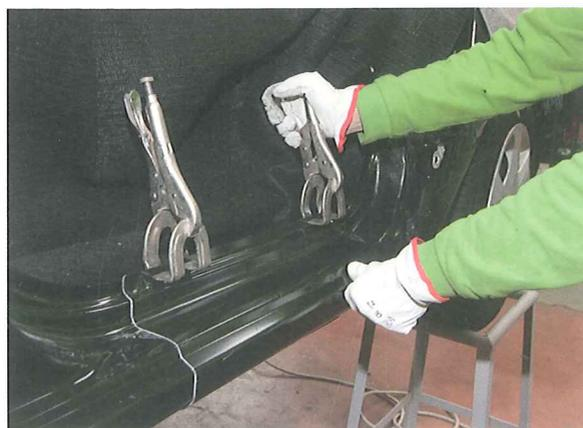
18. Se fija provisionalmente y, con una punta de trazar, se marca sobre la carrocería la línea de ajuste definitiva. Para poder marcar mejor, en la parte inferior del estribo se elimina el antigravilla con un disco trenzado.
