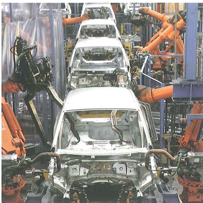
Soldadura por puntos de resistencia en fabricación
