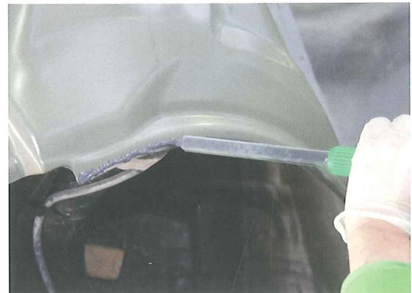
32. Se ajusta la aleta en su posición correcta, fijándola de forma provisional con unas mordazas autoblocantes. Para facilitar el ajuste, se pueden dar unos puntos de soldadura MIG provisionales en aquellas zonas más comprometidas, como pueden ser las aristas.
