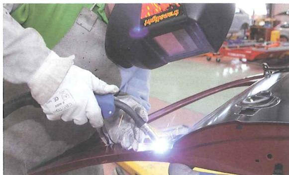
21. Para terminar el proceso, se repasan las soldaduras MIG para eliminar el material sobrante y dejar una superficie uniforme para recibir las capas de pintura.
