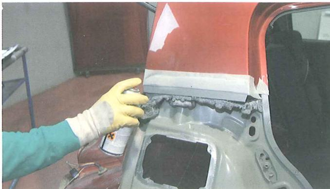
Aplicación de una imprimación electrosoldable
