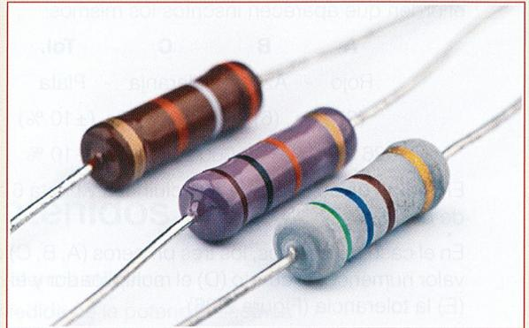
**Figura 2.24.** Las resistencias poseen una serie de anillos de color que nos indican el valor óhmico.
