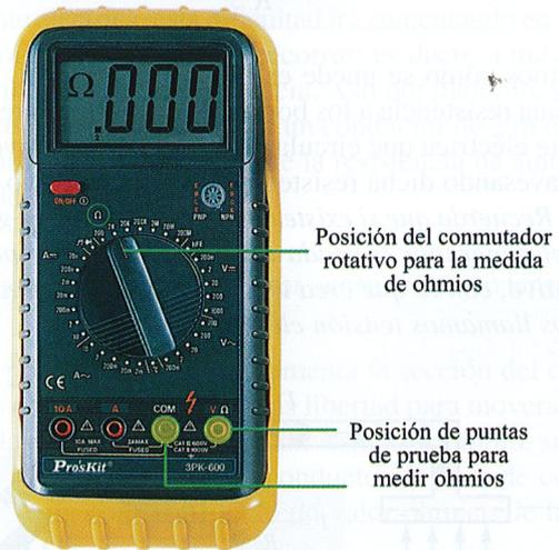
**Figura 2.5.** El polímetro incorpora un óhmetro para la medida de resistencias.
