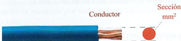
Figura 4.2. Sección de un conductor.
