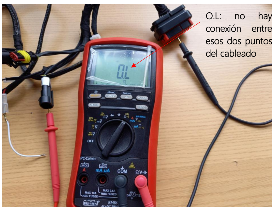
Ilustración 9: Medición de continuidad entre puntos del arnés
