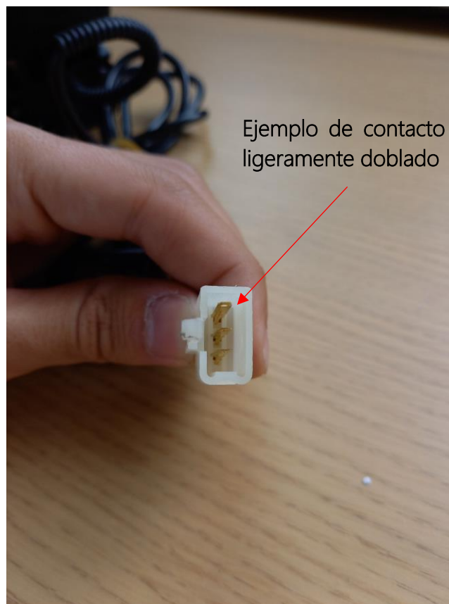
Ilustración 7: Comprobación conexión acelerador
