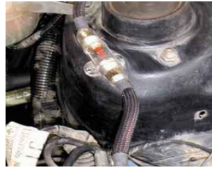
5.27 irudia. Aire-fusible baten instalazioa.
