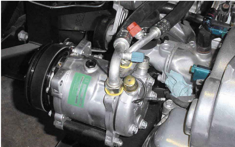
3.10 irudia. R134a gasera egokitutako konpresorea.
