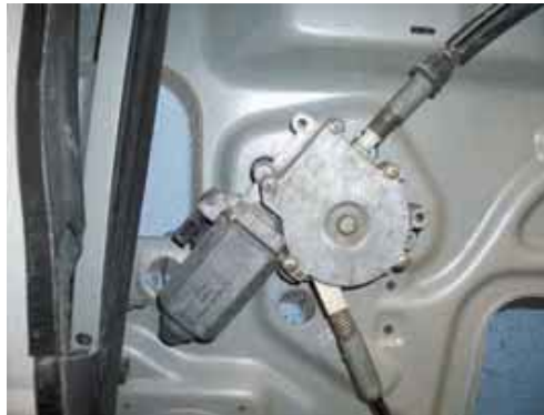
10.27 irudia. Beira-jasogailu elektrikoaren multzoa.
