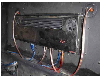
6.17 irudia. Anplifikadore bat daraman instalazioa.
