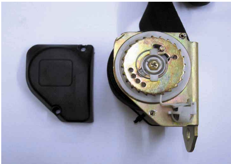
8.1 irudia. Uhalaren blokeo-mekanismoa.
