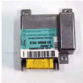
8.12 irudia. Airbagaren eta tenkagailuen kontrol-unitatea.
