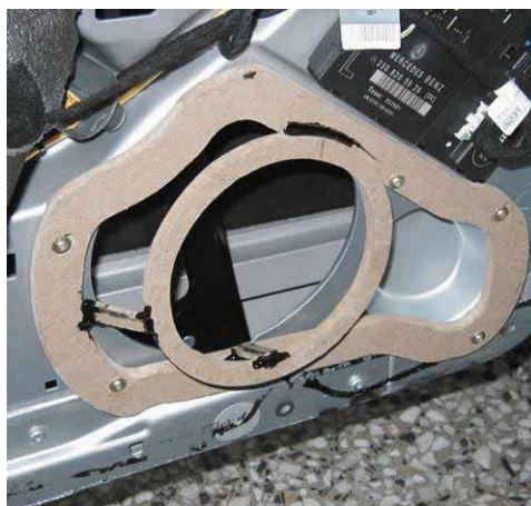
6.12 irudia. DM zurezko osagarria ateko bozgorailuetarako.
