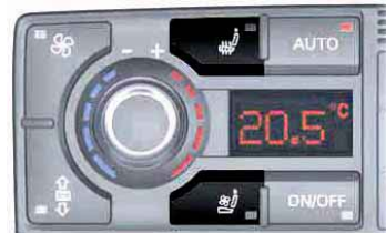
10.34 irudia. Eserleku berogailudunetarako aginte-panela.
