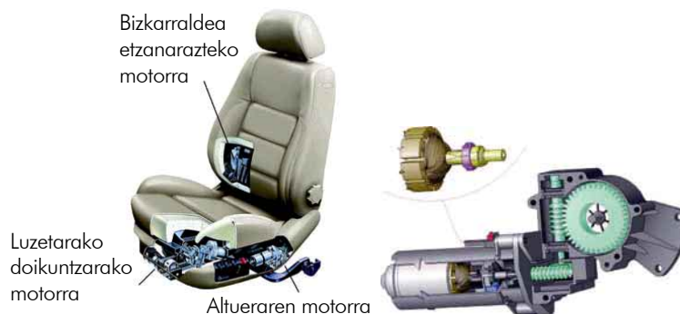
10.30 irudia. Eserleku elektrikoaren sekzioa eta eragiteko motorra.
