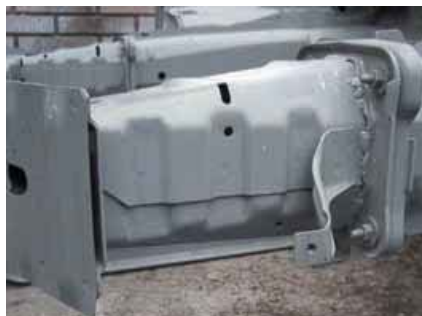
10.4 irudia. Aurreko langa bat deformatzeko tolestaketak.
