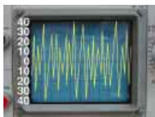
6.19 irudia. Bozgorailurako tentsioaren grafikoa. Gehieneko entrega.
