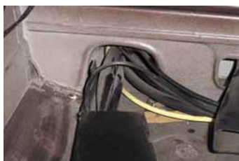
6.5 irudia. Kableen trazadura ibilgailuaren barnetik.
