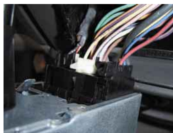
6.8 irudia. Potentzia handiko konektoreak soinu-iturrian.
