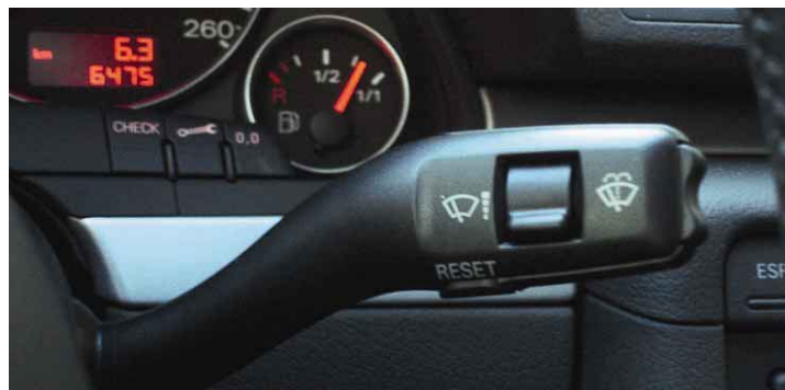
9.28 irudia. Barruko ordenagailuaren aginte-kommutadorea.
