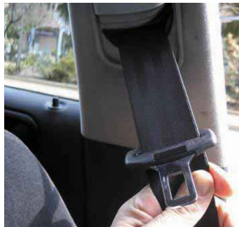
8.13 irudia. Blokeo-mekanismoa egiaztatzea.
