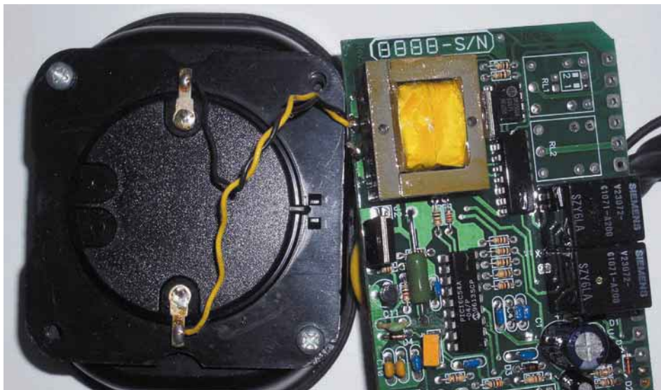
9.9 irudia. Alarma-zirkuitu elektronikoa.
