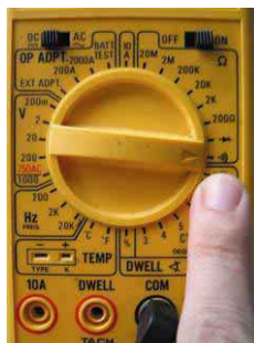
6.25 irudia. Polimetroa burrunbagailu-posizioan.
