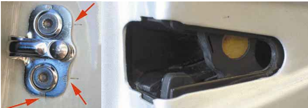
10.29 irudia. Itxieraren ainguralekua, doitze-marka eta kisketa eta guzti.
