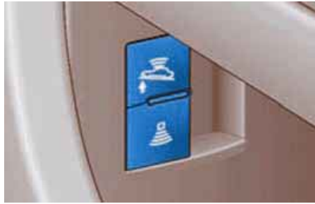
9.5 irudia. Inklinazioaren aurkako gailua deskonektatzeko etengailua.
