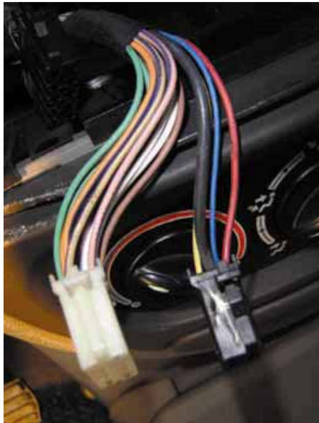
6.9 irudia. Kableen kolorea potentzia handiko konektoreetan.
