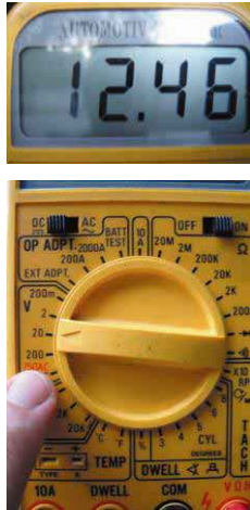
6.24 irudia. Polimetroa volt-posizioan. Bateria-tentsioa.
