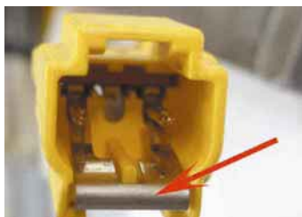
7.9 irudia. Konektorearen metalezko segurtasun-zubia.
