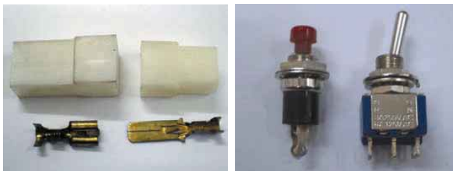
9.16 irudia. Faston ar-eme konektorea, sakagailua eta etengailua.
